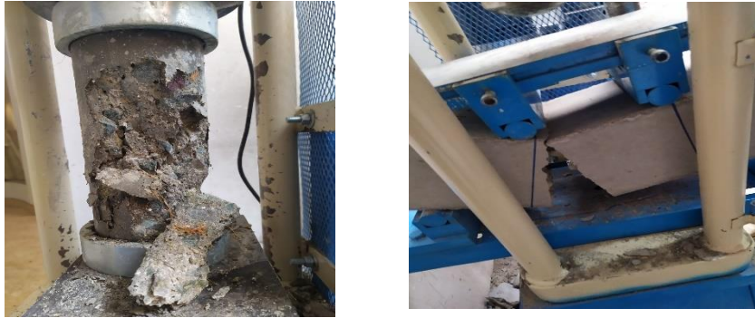
Figura 34: Rotura de probetas y viga a compresión
