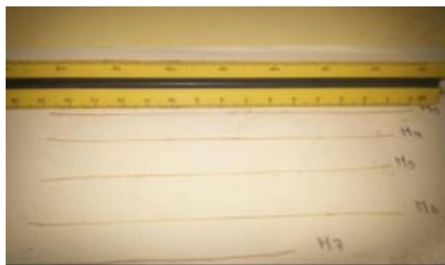
Figura 10 :Medición de la longitud de la fibra de Estopa de coco
