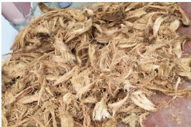
Figura 15 : fibras de estopa de coco para ensayos de laboratorio
