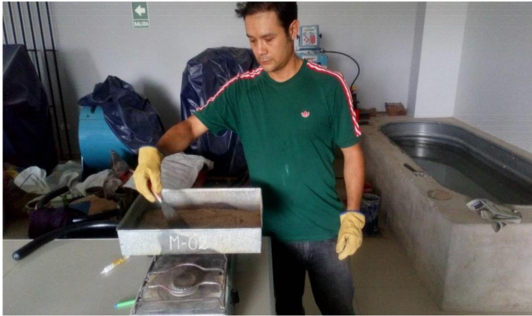
Figura 04. Gravilla en estado s.s.s. y canastilla sumergida en agua.
