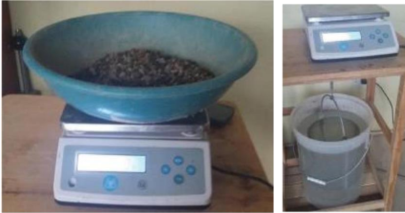
Figura 04. Gravilla en estado s.s.s. y canastilla sumergida en agua.
