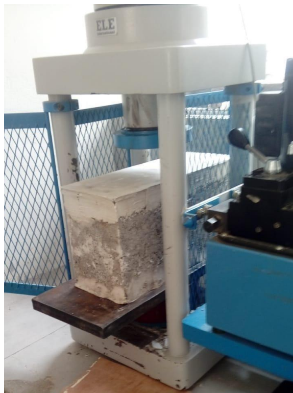
Figura 16. Pasado las 24 horas los bloques serán sometidos a la prensa.
