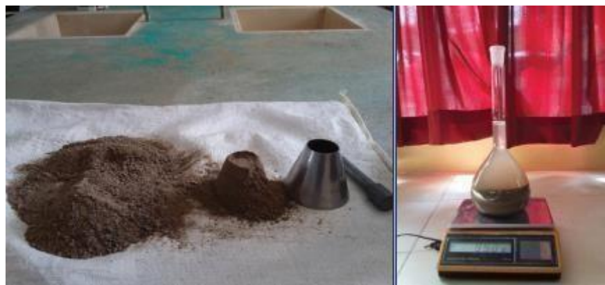
Figura 03. Agregado fino Saturado, superficialmente seco
