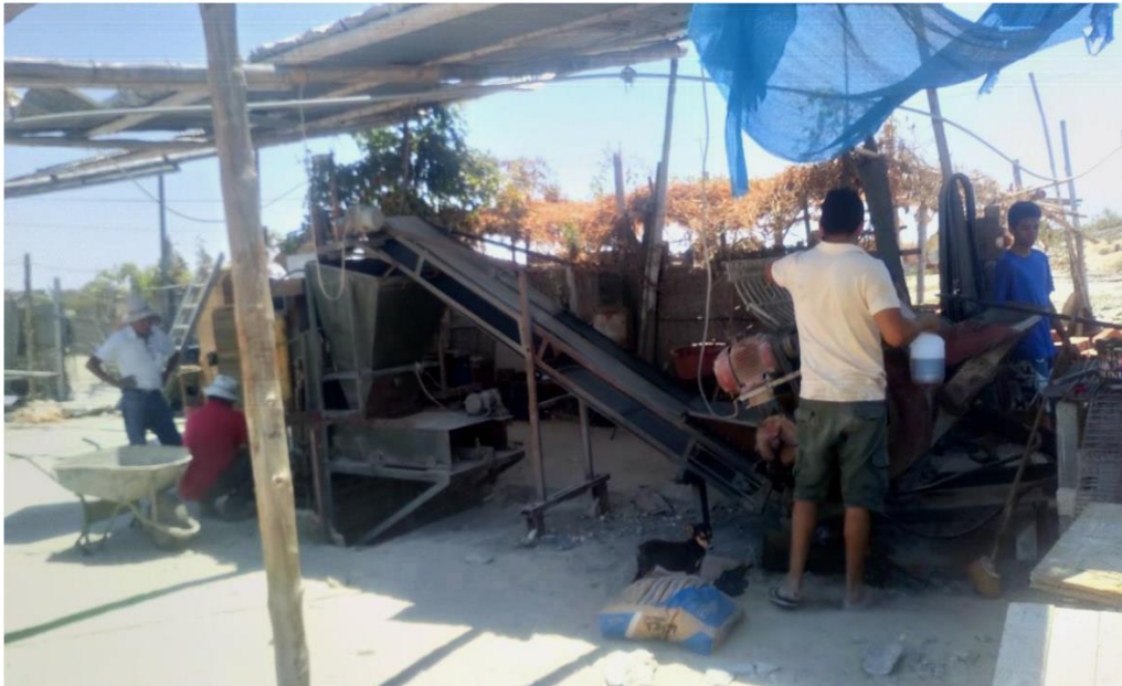
Figura 06. Maquina procesadora de bloquetas de concreto
