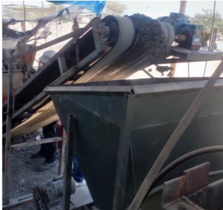
Figura 11. Mediante la faja transportadora, se lleva la mezcla de agregado hacia el molde.
