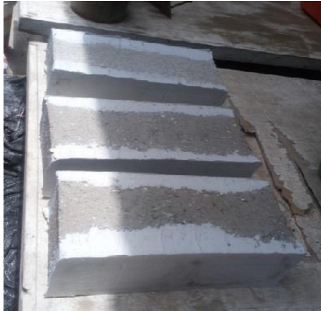
Figura 15. Una vez que los bloques sean llevados a que sean sometidos a la prensa para calcular su resistencia, estos son cubiertos por una capa de cal y yeso, este procedimiento se le llama el “capeo”, por ambos lados de forma uniforme para adquirir consistencia al momento del ensayo.
