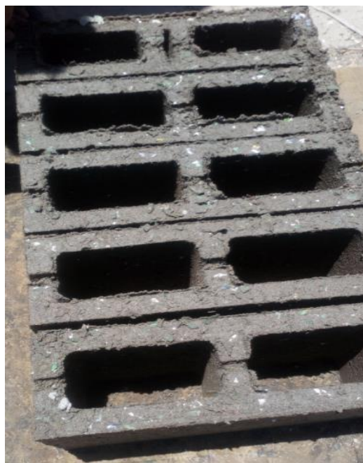
Fig. 14 Los bloques serán sometidos al curado por 7,14 y 28 días.
