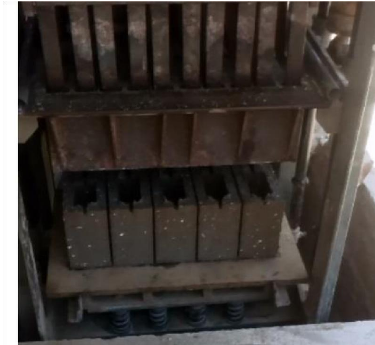
Figura 13. Terminado el vibrado de los bloques están listos para el curado (cinco muestras por molde)
