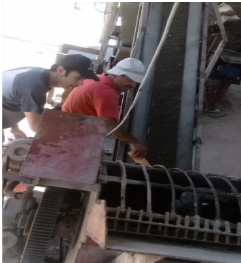
Figura 12. Mediante la faja transportadora, se lleva la mezcla de agregado hacia el molde.
