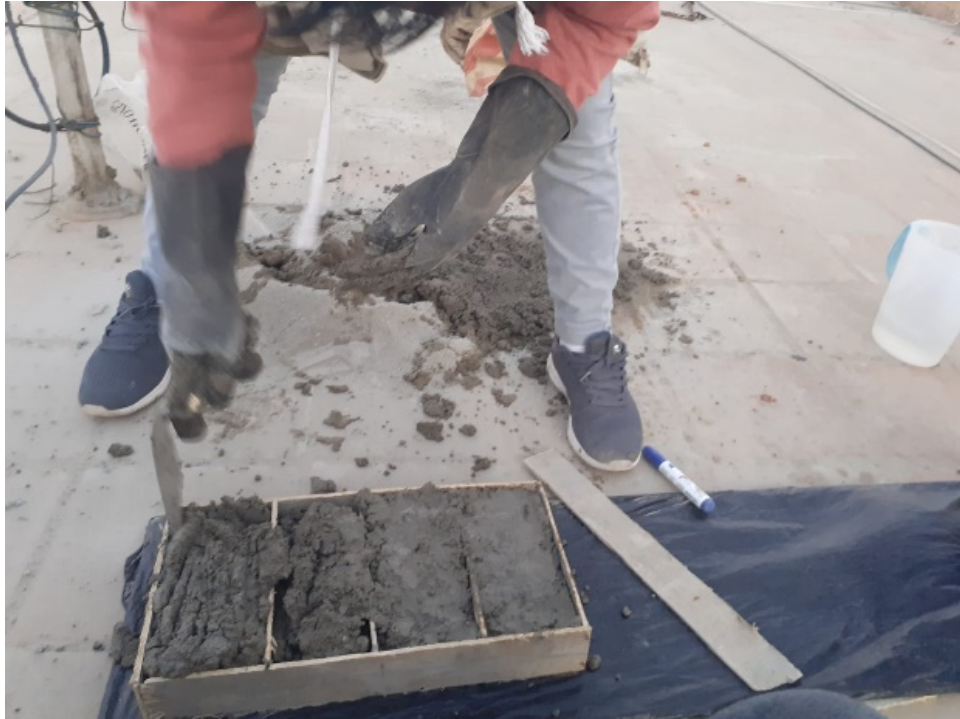
Figura 15: Elaboración de los adoquines
