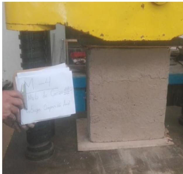
*Figura 10. Pila de Tapial con refuerzo de Carrizo*
