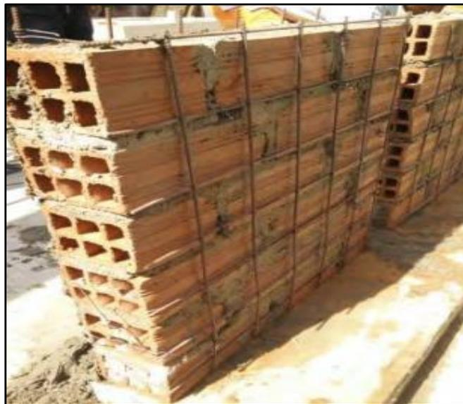
*Figura 16. Murete de albañilería con malla electrosoldadas*
