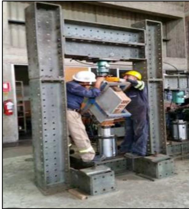
*Figura 19. Proceso de colocación de muretes en la prensa hidráulica*
