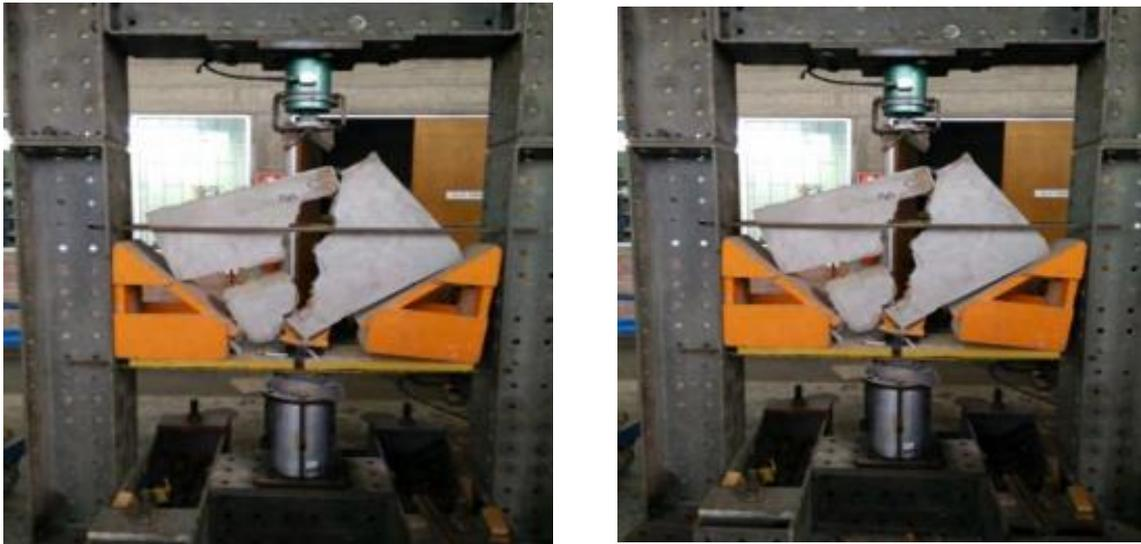
*Figura 21. Rotura de murete N°2 y N°3*
