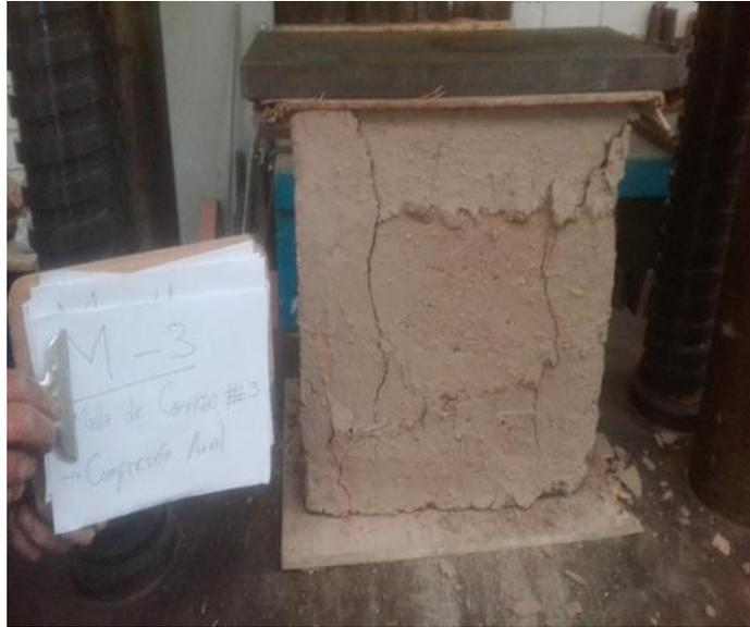
*Figura 9. Pila de Tapial sin Refuerzo*
