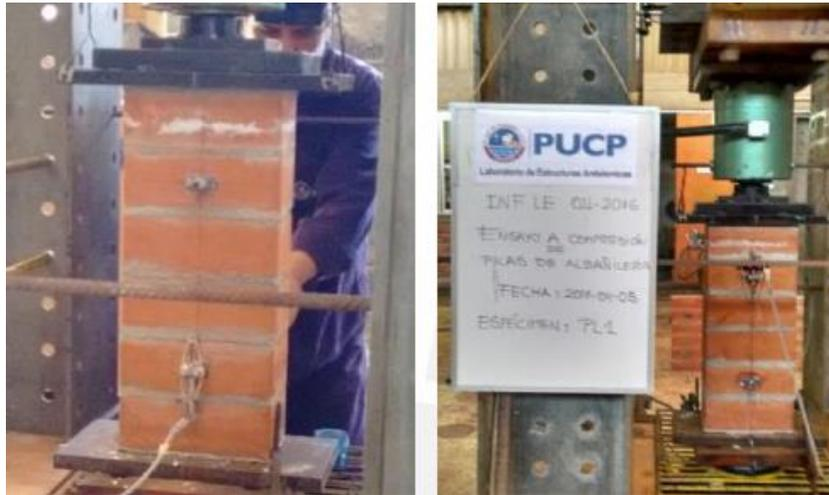
*Figura 7. Rotura de Pilas de albañilería*
