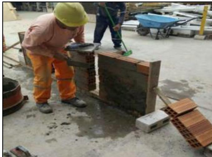
*Figura 14. Murete de albañilería sin refuerzo*
