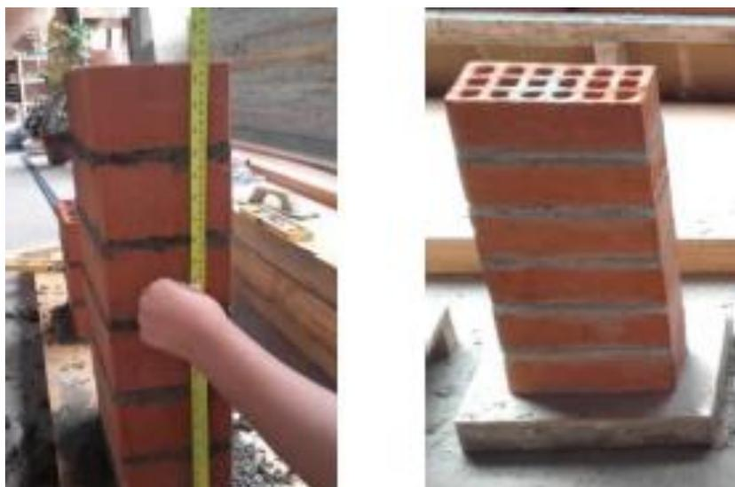
*Figura 6. Elaboración de pilas de Albañilería*
