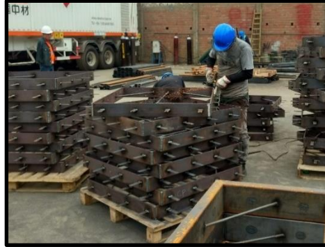
Figura N° 21: Limpieza Mecánica de Pre-Marco Fuente: Elaboración Propia
