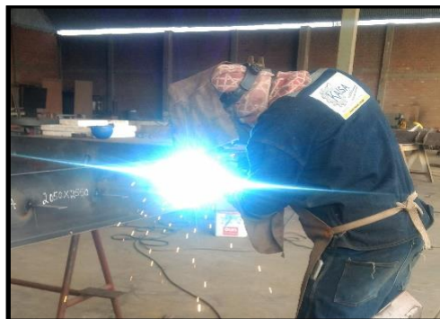
Figura N° 17: Soldadura 1 de Pre-Marco Fuente: Elaboración Propia
