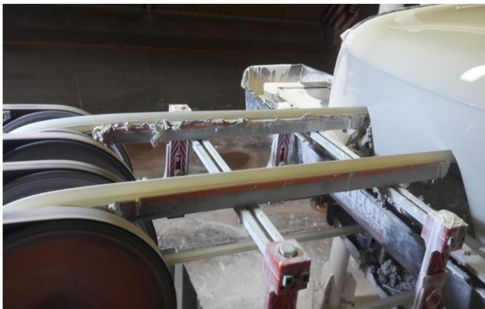
*Figura 54. En este proceso se debe tener mucho cuidado por la limpieza de las poleas y guías tener en cuenta siempre tener puesto los equipos de protección personal este proceso nos dio como resultado mediante el estudio de tiempo de 7 min por lo que se debe mantener un buen lavado. Tener cuidado que en el proceso de limpieza se puede tener el peligro de atrapamiento de mano.*
