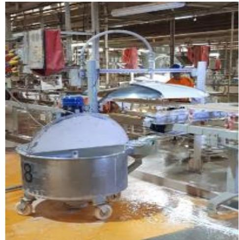
*Figura 52.* El proceso de lavado de campana y de la vasca principal demora un tiempo de 13 min que se tomo mediante el proceso de cambio con cronometro y video con fichas de control del proceso .
