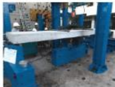
Figura 2. Vista de la losa aligerada con unidades convencional
