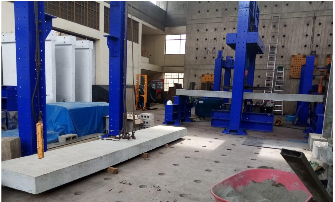
Losa aligerada con ladrillo compuesto (En el suelo), losa aligerada con ladrillo convencional (En el ensayo)
