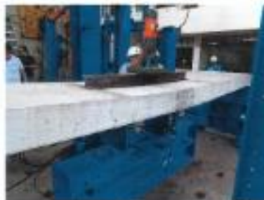
Figura 25. Estado final de la losa aligerada (P-02)
