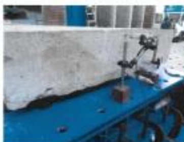
Figura 8. Transductores laterales cara Sur (CH-01 y CH-02)
