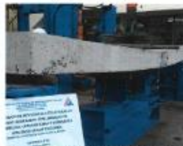
Figura 24. Vista de la deflexion de la losa (P-02)
