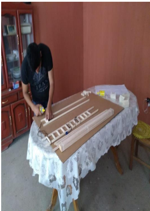
Figura 28: Pegado de elementos estructurales
