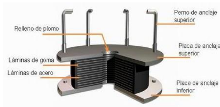
Figura 3: Partes de un Aislador Sísmico
