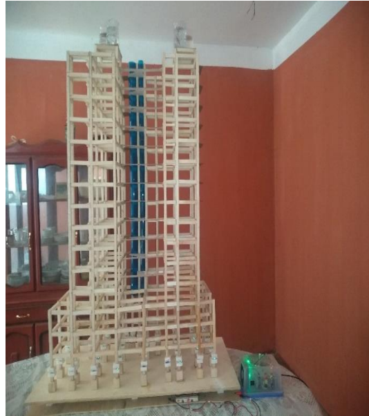
Figura 39: maqueta con circuito instalado
