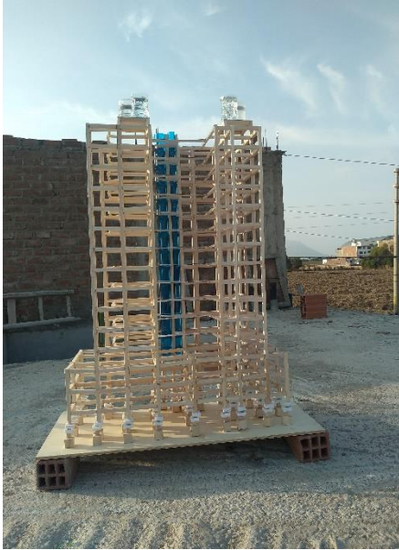
Figura 38: Edificio probando con la fuerza del viento y ver sus desplazamientos en los sistemas de aislación ver video.
