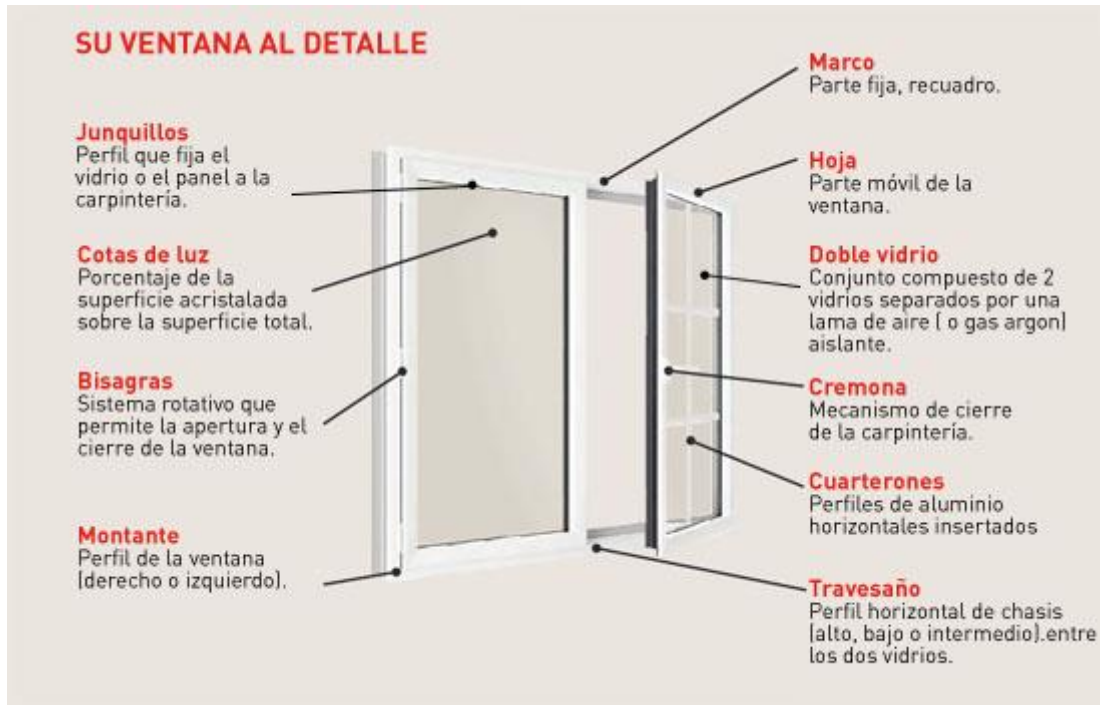
Figura 12: Partes de una ventana de carpintería. Recuperado de: http://aluminiosgarcilaso.com/informacion-como-elegir-la-ventana-de-aluminio-mas-adecuada.html
