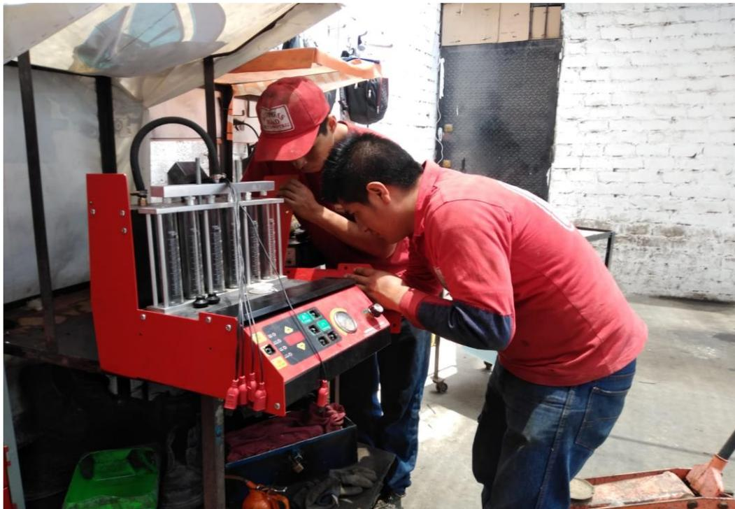
*Figura 13.* Probador de inyectores. Comentario: El cual es una herramienta que es parte del mantenimiento que ejecuta el mantenimiento del vehículo, que, después de tanto mantenimiento de los inyectores de gasolina se llega a malograr por el mal uso, y es cuando el técnico se encarga de repararlo. Fuente: Taller de conversiones a GNV Autogas HyD Automotriz.
