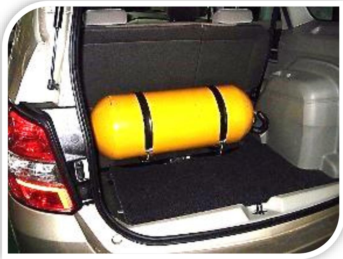
Figura 6. Vehículo GNV en Cuarta generación. Fuente: De un taller de conversiones a GNV para camiones EPSA GAS.
