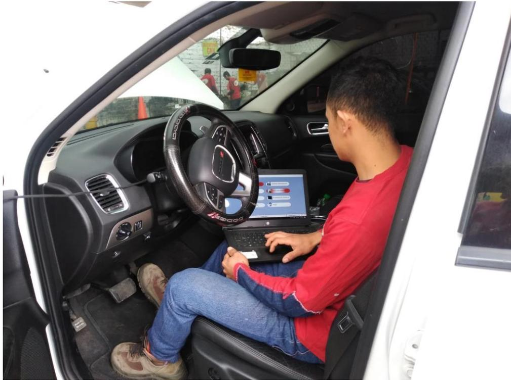
Figura 53. El mantenimiento está completo. El último paso del escaneo total del vehículo. Utilice el programa para verificar las partes eléctricas y electrónicas del sistema de gas de acuerdo con el trinquete que se muestra. Fuente: Taller de conversiones a GNV Autogas HyD Automotriz.
