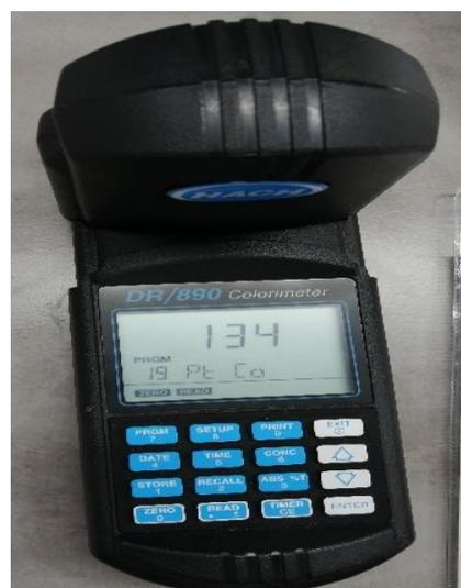
Figura 59: Resultado de color de agua pasado por el filtro de carbón.
