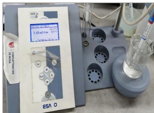
Figura 55: Resultado de conductividad agua pasado por el filtro de carbón primer ensayo.
