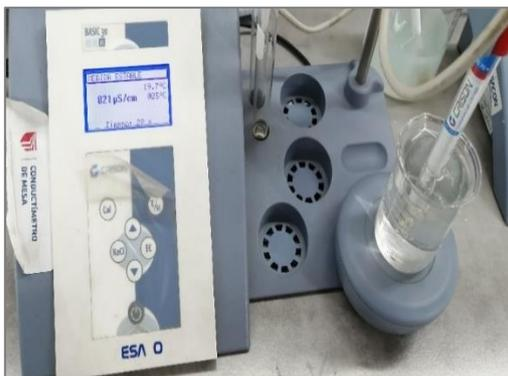
Figura 54: Resultado de conductividad agua de lluvia primer ensayo.
