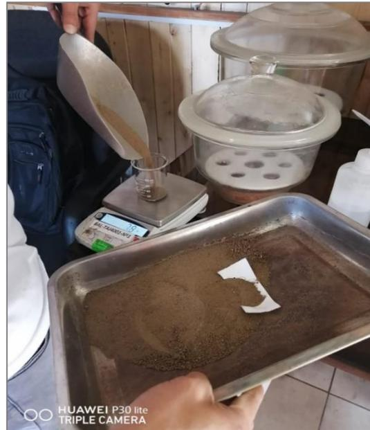
Figura 37: Peso de muestra para cloruros
