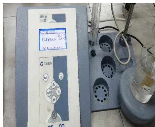
Figura 57: Resultado de conductividad agua pasado por el filtro de carbón segundo ensayo.
