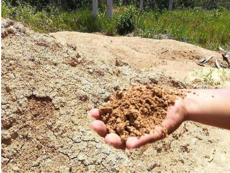
Foto N° 05: Selección de la arcilla para la elaboración de las muestras adicionado con ceniza de cascarilla de arroz en la Ladrillera Alto Mayo – Rioja.
