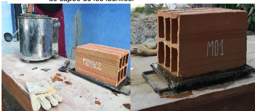
Figura N° 6: Llenado de la bandeja metálica de superficie lisa en el proceso de capeo de los ladrillos.
