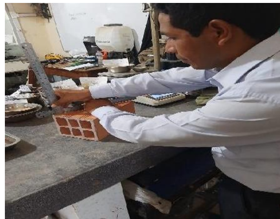
Foto N° 25: Proceso del ensayo de Alabeo a cada muestra con adición de 0%, 10% y 20% de ceniza de cascarilla de arroz. A los 14 días.
