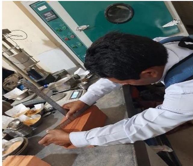
Foto N° 26: Proceso del ensayo de Alabeo a cada muestra con adición de 0%, 10% y 20% de ceniza de cascarilla de arroz. A los 28 días.
