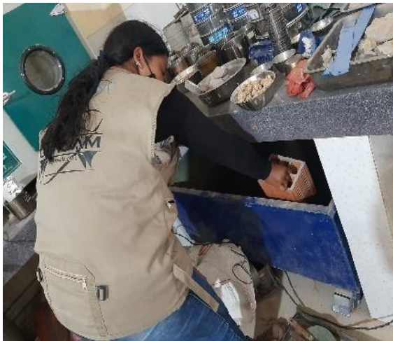
Foto N° 09: Vista del procedimiento del ensayo de absorción, sumergiendo las muestras con adición del 0%, 10% y 20% de ceniza de cascarilla arroz por 24 horas para determinar su porcentaje de absorción. A los 7 días.
