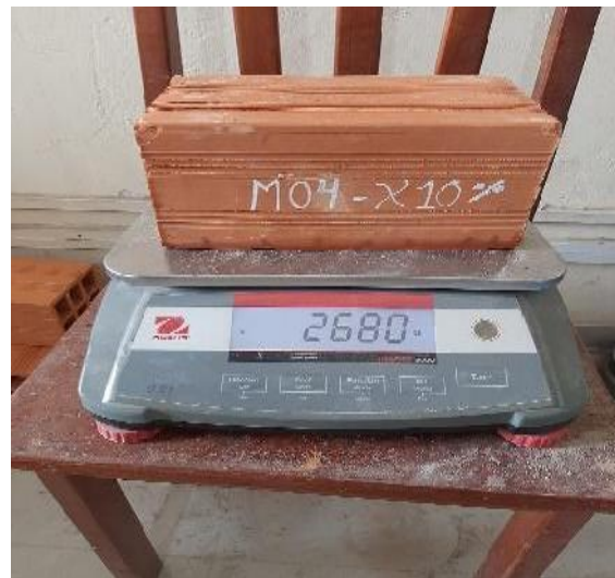
Foto N° 28: Proceso del ensayo de succión a cada muestra con adición de 0%, 10% y 20% de ceniza de cascarilla de arroz. Pesado a los 7 días.
