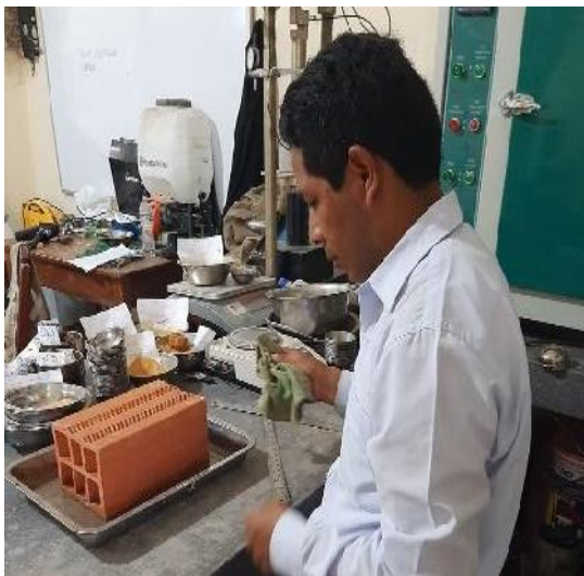
Foto N° 27: Proceso del ensayo de succión a cada muestra con adición de 0%, 10% y 20% de ceniza de cascarilla de arroz. A los 7 días.
