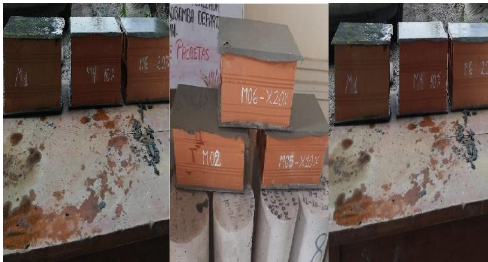
Figura N° 8: Ladrillos de arcilla del grupo control y experimental luego del proceso de capeo a los 7, 4 y 28 días.
