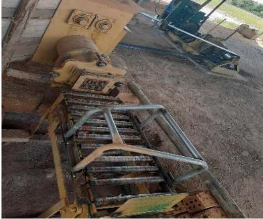
Foto N° 07: Vista de la maquina mecánica moldeadora para el proceso de la elaboración de los ladrillos.
