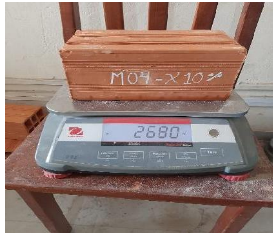
Foto N° 32: Proceso del ensayo de succión a cada muestra con adición de 0%, 10% y 20% de ceniza de cascarilla de arroz. Pesado a los 28 días.
