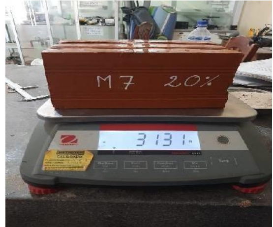
Foto N° 30: Proceso del ensayo de succión a cada muestra con adición de 0%, 10% y 20% de ceniza de cascarilla de arroz. Pesado a los 14 días.
