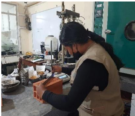
Foto N° 24: Proceso del ensayo de Alabeo a cada muestra con adición de 0%, 10% y 20% de ceniza de cascarilla de arroz. A los 7 días.
