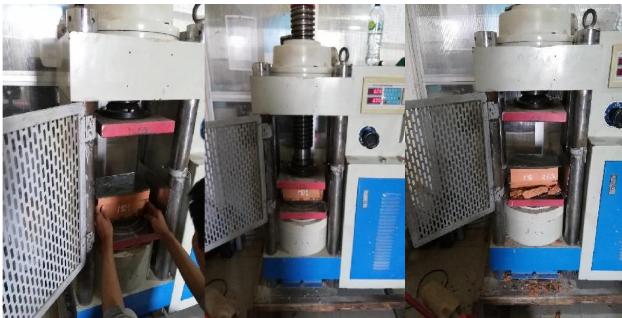
Figura N° 9: Ensayo de resistencia a la compresión en ladrillos del grupo control y los grupos experimentales.
