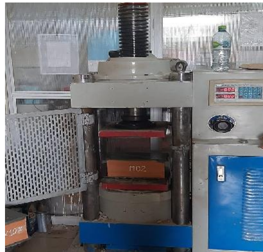
Foto N° 20: Se muestra el ensayo de resistencia a la compresión a las muestras con adición de 0%, 10% y 20% de ceniza de cascarilla de arroz a los 28 días.
