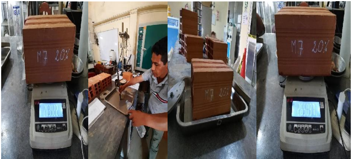
Figura N° 12: Se observa el proceso del ensayo de succión.
