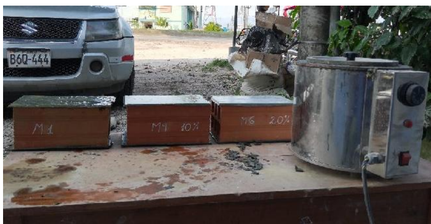
Figura N° 7: Ladrillo liso luego del proceso de recubrimiento con azufre.
