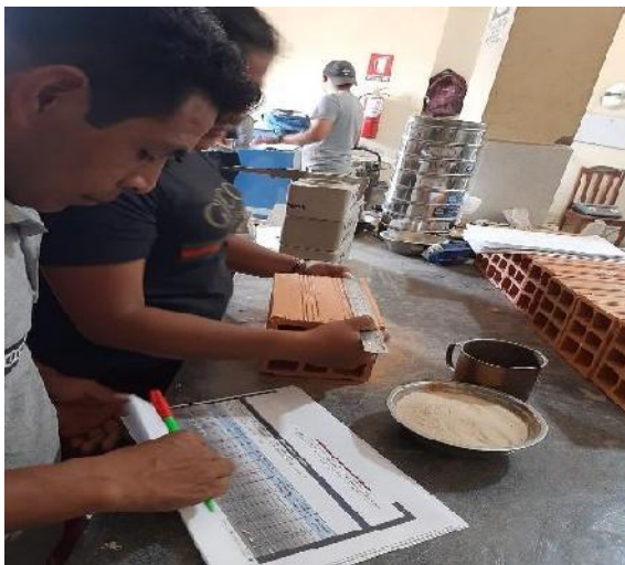
Foto N° 21: Proceso del ensayo de variabilidad dimensional a cada muestra con adición de 0%, 10% y 20% de ceniza de cascarilla de arroz. 7 días.
