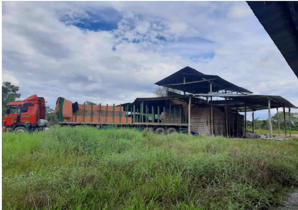
Foto N° 03: Vista del horno de la Ladrillera Alto Mayo – Rioja, para realizar la cocción o quemado de ladrillos de arcilla artesanal adicionado con ceniza de cascarilla de arroz.
