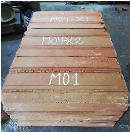
Figura N° 5: Muestras de control y experimental para el proceso de capeo con azufre.
