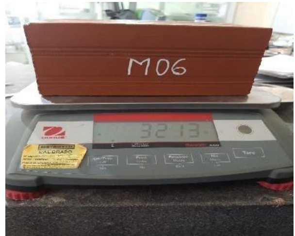
Foto N° 10: Vista del pesado de las muestras después de las 24 horas sumergidas en el agua para el ensayo de absorción a los 7 días.
