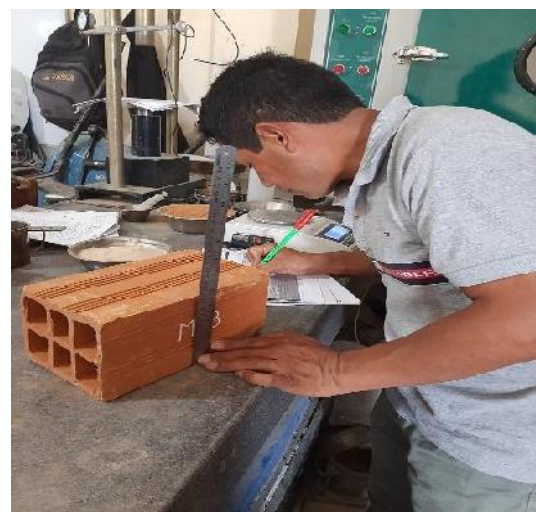
Foto N° 22: Proceso del ensayo de variabilidad dimensional a cada muestra con adición de 0%, 10% y 20% de ceniza de cascarilla de arroz. 14 días.
