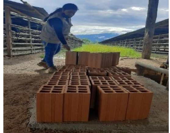
Foto N° 08: Elaboración de los ladrillos con la adición del 0%, 10% y 20% de ceniza de cascarilla de arroz.
