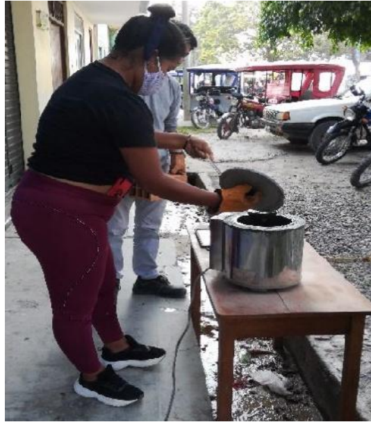
Figura N° 4: Preparado de la disolución de azufre para el capeo de los ladrillos.
