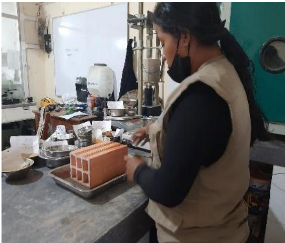
Foto N° 31: Proceso del ensayo de succión a cada muestra con adición de 0%, 10% y 20% de ceniza de cascarilla de arroz. A los 28 días.
