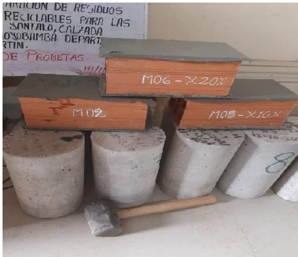
Foto N° 19: Se uniformizo la superficie con cylinder capping set a las muestras con adición de 0%, 10% y 20% de ceniza de cascarilla de arroz para el ensayo de resistencia a la compresión a los 28 días.
