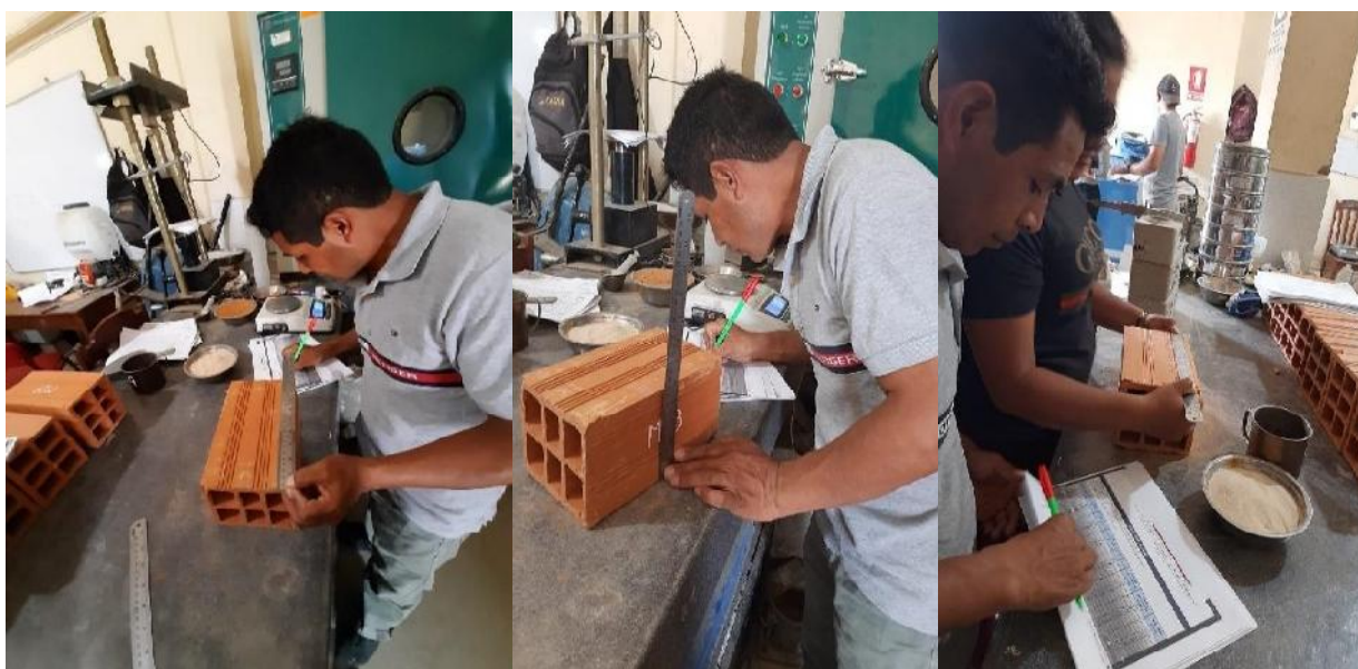
Figura N° 10: Se muestra el procedimiento del ensayo de variabilidad dimensional
