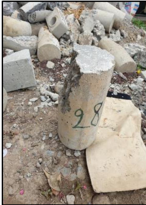
Fotografía N°31 y 32. Prueba de resistencia a la compresión, testigos cilíndricos de concreto a los 28 días.
