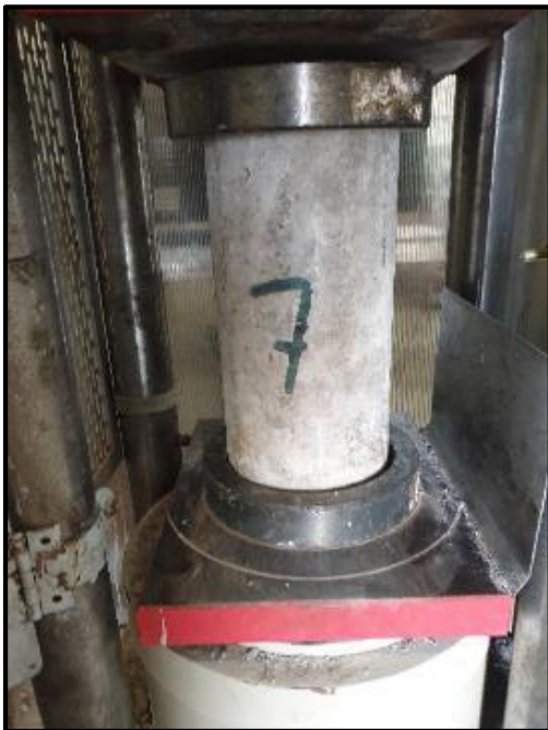
Fotografía N° 26, 27 y 28. Prueba de resistencia a la compresión, testigos cilíndricos de concreto a los 7 días.
