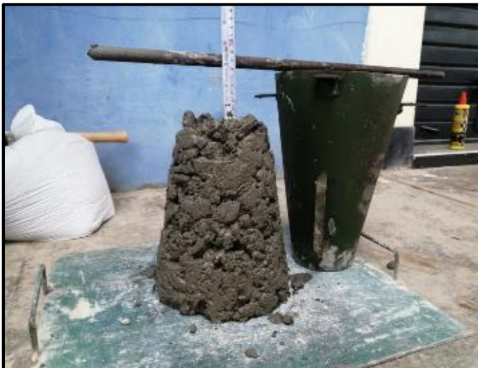
Figura N° 21: Ensayo de SLUMP
