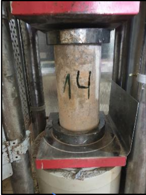
Fotografía N°29 y 30. Prueba de resistencia a la compresión, testigos cilíndricos de concreto a los 14 días.
