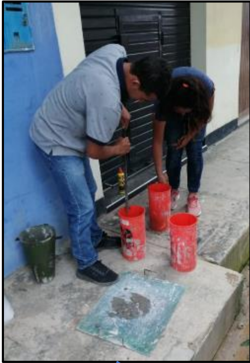
Figura N° 22 y 23: Colocación de la mezcla a las probetas.
