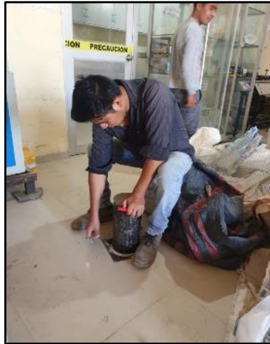
Figura N° 24 y 25: Pasada las 24 horas, se pasó a desencofrar las probetas.
