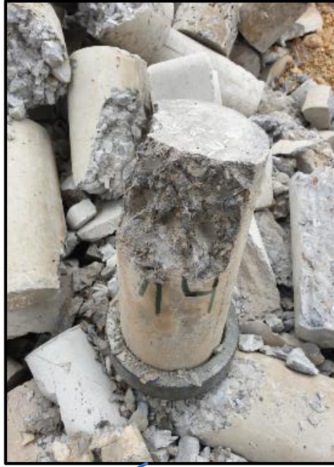
Fotografía N°29 y 30. Prueba de resistencia a la compresión, testigos cilíndricos de concreto a los 14 días.
