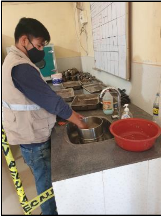
Fotografía N° 05. Lavado de muestra por el tamiz N° 200 de agregado fino para ensayo de granulometría
