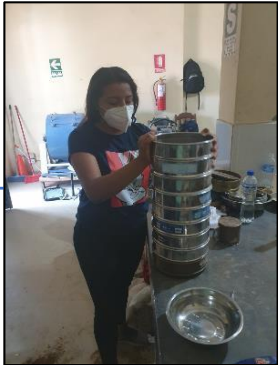
Fotografía N° 06. Análisis Granulométrico por Tamizado del Agregado fino
