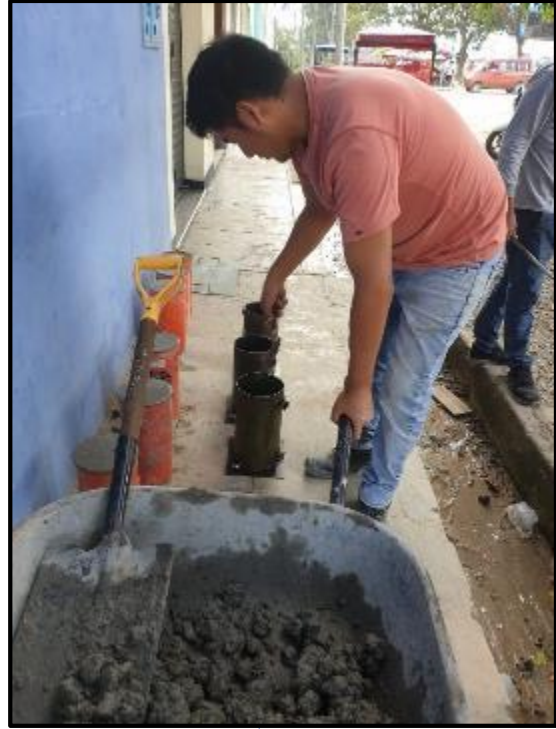
Figura N° 22 y 23: Colocación de la mezcla a las probetas.
