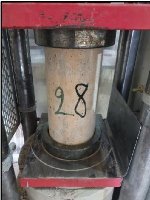
Fotografía N°31 y 32. Prueba de resistencia a la compresión, testigos cilíndricos de concreto a los 28 días.
