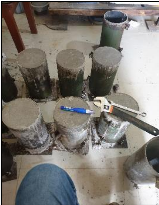
Figura N° 24 y 25: Pasada las 24 horas, se pasó a desencofrar las probetas.
