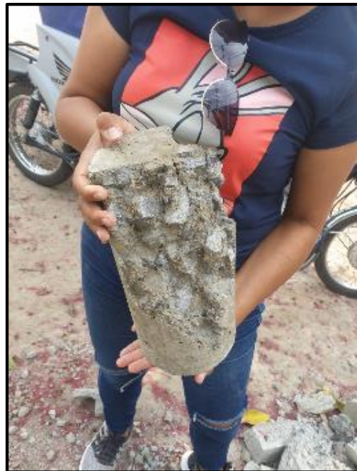
Fotografía N° 26, 27 y 28. Prueba de resistencia a la compresión, testigos cilíndricos de concreto a los 7 días.
