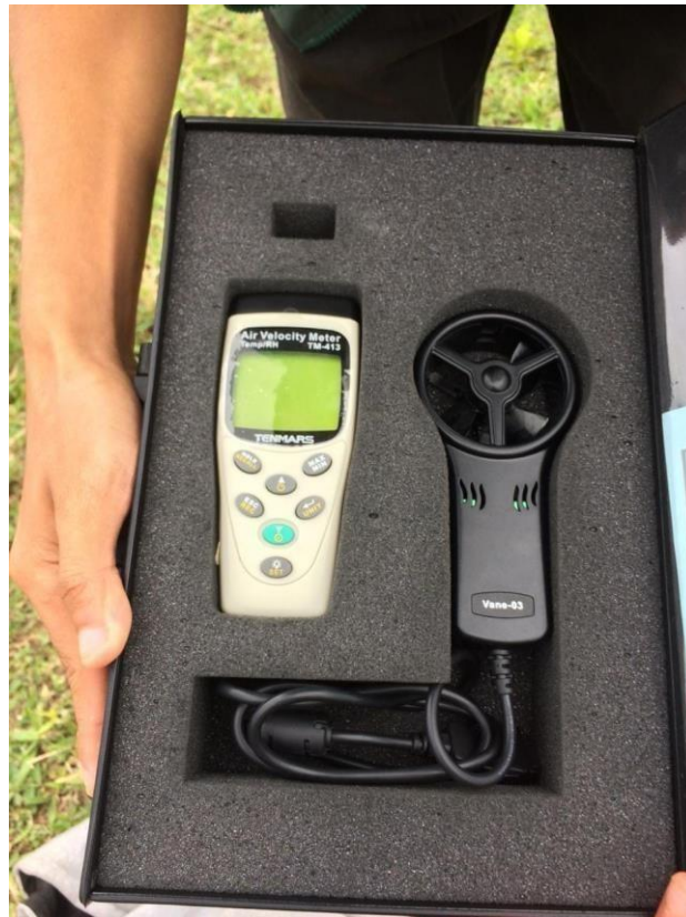
Imagen N 03: Anemómetro con el cual se pudo calcular la velocidad del viento, la temp Max y Min y la humedad relativa.
