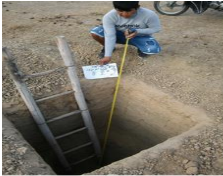
Figura N° 09: Calicata de 1.50 m de profundidad N° 3
