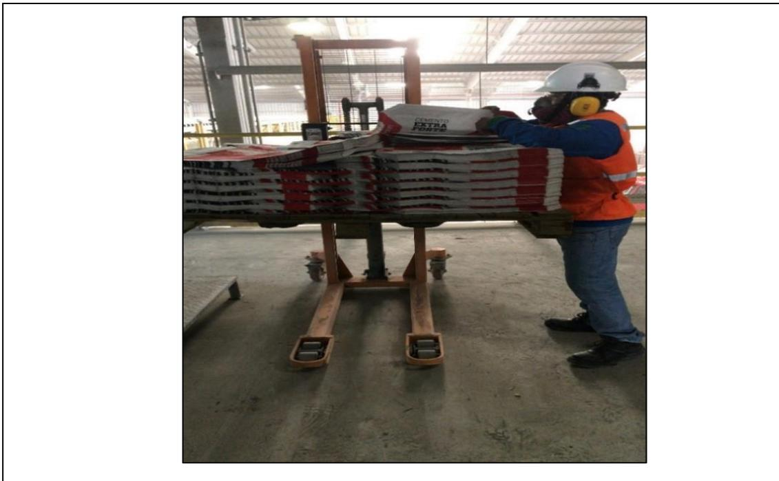
Figura 2: Operario preparando los paquetes de sacos vacíos para ingresarlos al alimentador de sacos para que lleguen aplicador Infilrot Z40.
