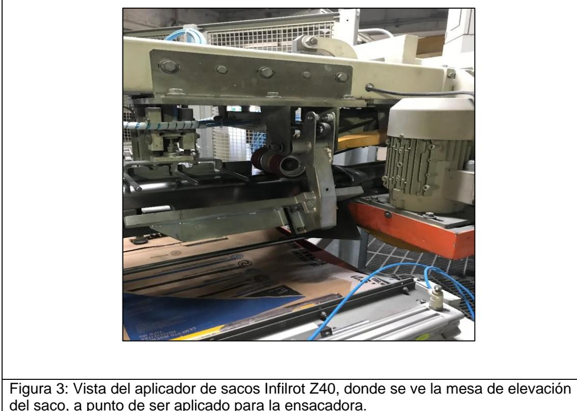
Figura 3: Vista del aplicador de sacos Infilrot Z40, donde se ve la mesa de elevación del saco, a punto de ser aplicado para la ensacadora.
