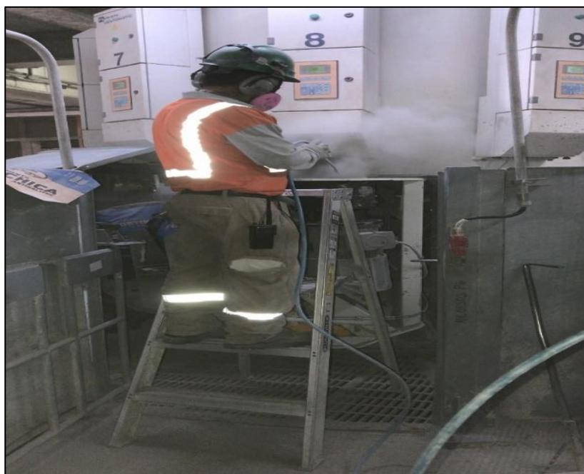
Figura 10: Vista de operador limpiando ensacadora con aire comprimido.
