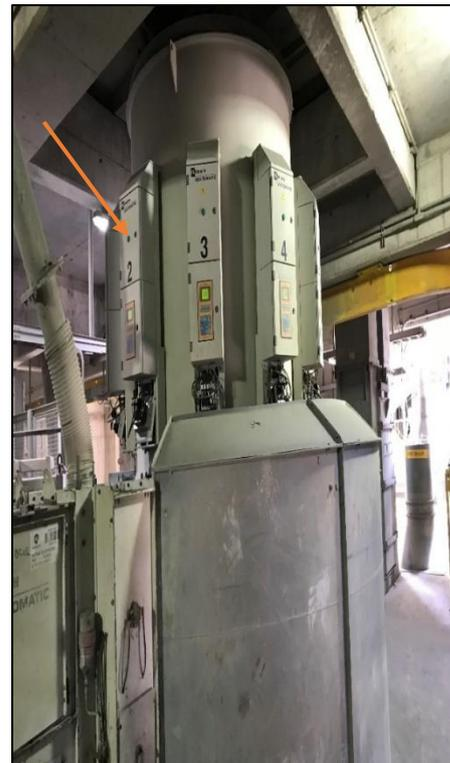
Figura 5: Vistas de la Ensacadora giratoria Geo/Gev, la numeración de cada dosificadora y las boquillas de dosificación del producto.
