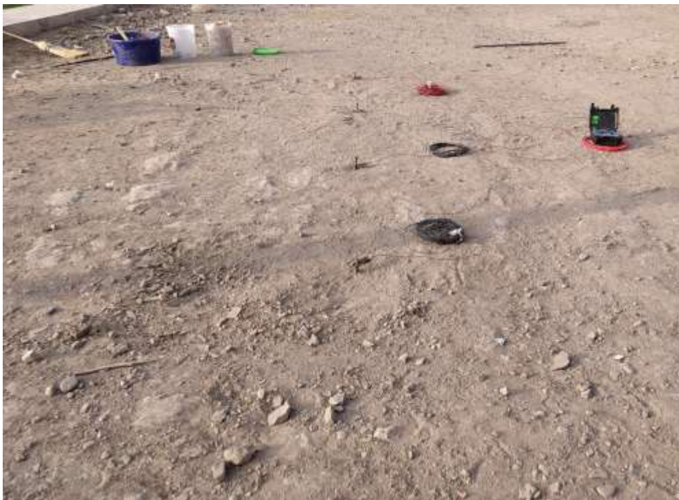
Foto 2.- Medición de la resistividad del terreno con el método de wenner, se utilizó un telurometro de marca Megabras el cual fue calibrado el 23.10.2020 en la empresa Unimetro.
