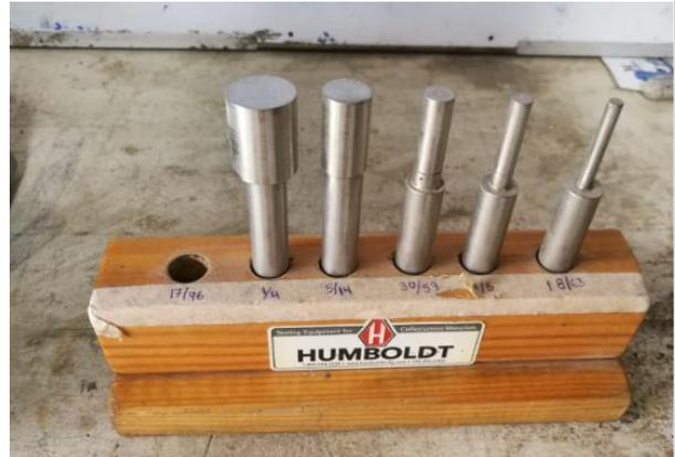
Figura N°31 Penetrómetro ACME
