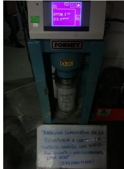
*Figura N°30 Resistencia a compresión con aditivo Impermeabilizante (+0.4%) a los 14 días testigo N°2 y 3*
