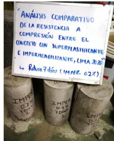
Figura N°18 Resistencia a la compresión del concreto con impermeabilizante 0.2% a los 7 días (testigo 01)
