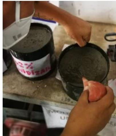
Figura N°33 Ensayo para calcular el tiempo de fraguado del concreto patrón.
