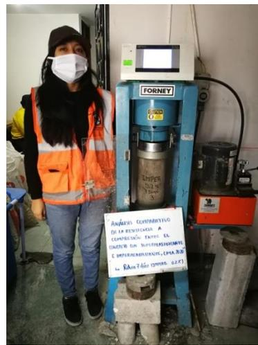
*Figura N°22 Medición de resistencia a compresión*
