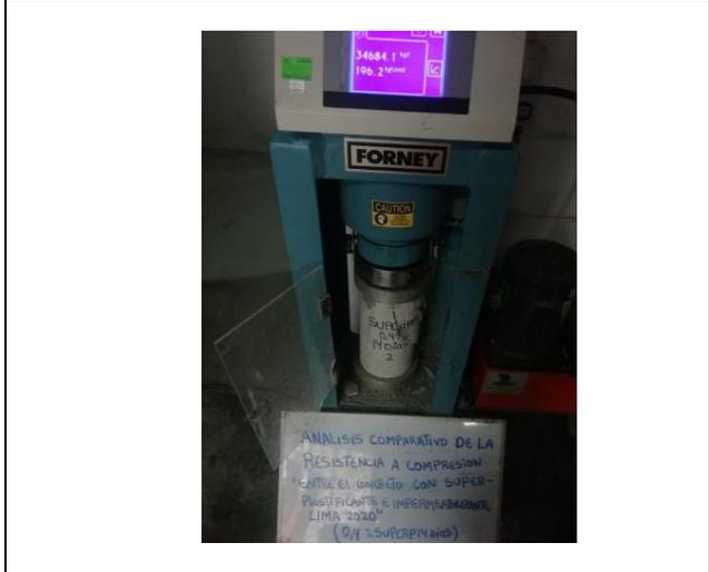
*Figura N°27 Resistencia a compresión con aditivo superplastificante (+0.4%) a los 14 días*
