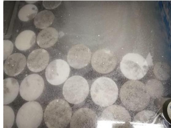
Figura N°14 Toma de muestras del concreto con 1.0 % de impermeabilizante.
