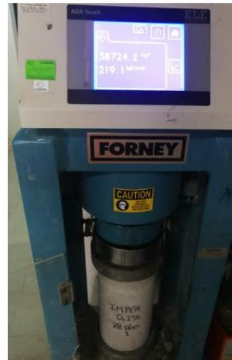
*Figura N°36 Resistencia a la compresión a los 28 días del concreto patrón más impermeabilizante.*
