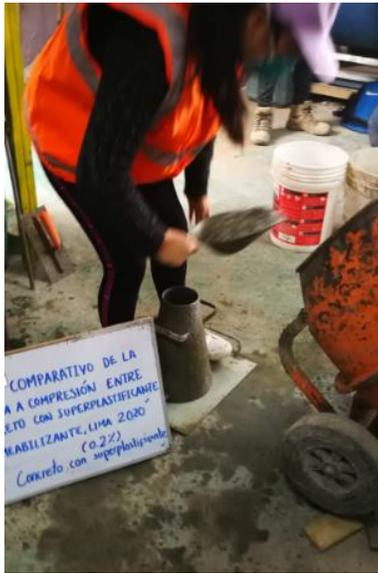
Figura N°8 Colocación de concreto en el Molde del cono de Abrams
