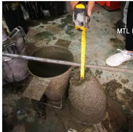
Figura N°13 Medición del slump del concreto con superplastificante e impermeabilizante al 0.4 %.
