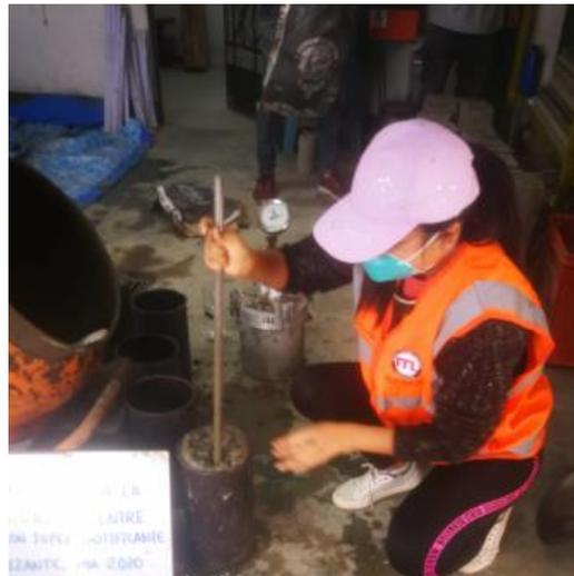
Figura N°9 Compactación de la Muestra con varilla lisa de 5/8”
