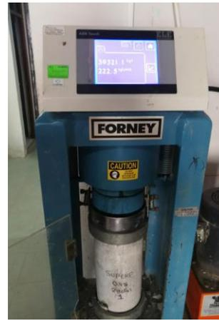
*Figura N°35 Resistencia a la compresión a los 28 días del concreto patrón.*
