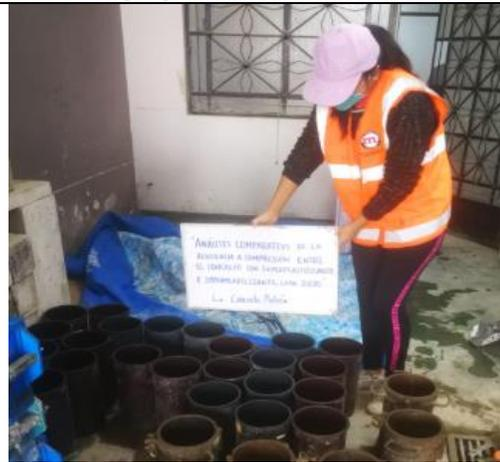
Figura N°7 Moldes para la toma de muestras
