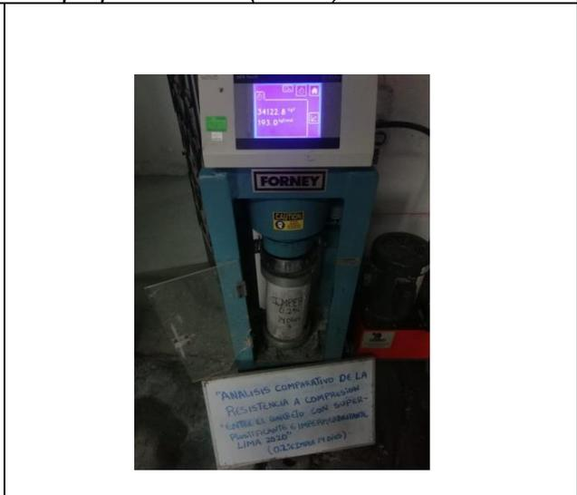
*Figura N°28 Resistencia a compresión con aditivo Impermeabilizante (+0.2%) a los 14 días*
