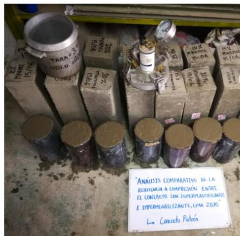
Figura N°11 Toma de muestras del muestra con 0.2 % de impermeabilizante
