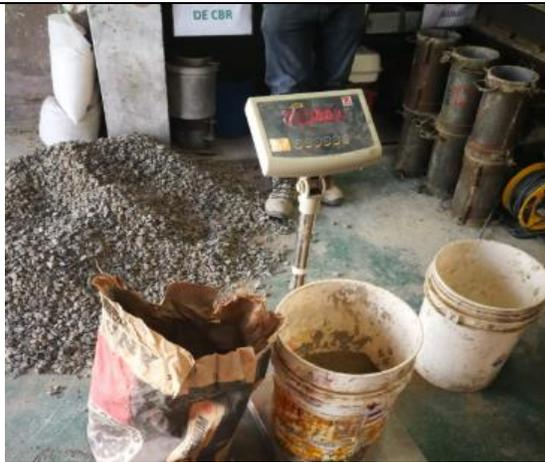
Figura N°6 Peso del agregado grueso según el diseño de mezcla
