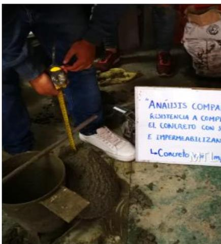
Figura N°10 Medición del slump del concreto Patrón
