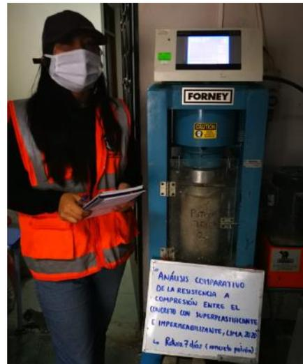
Figura N°16 Resistencia a la compresión del concreto patrón a los 7 días (testigo 01)
