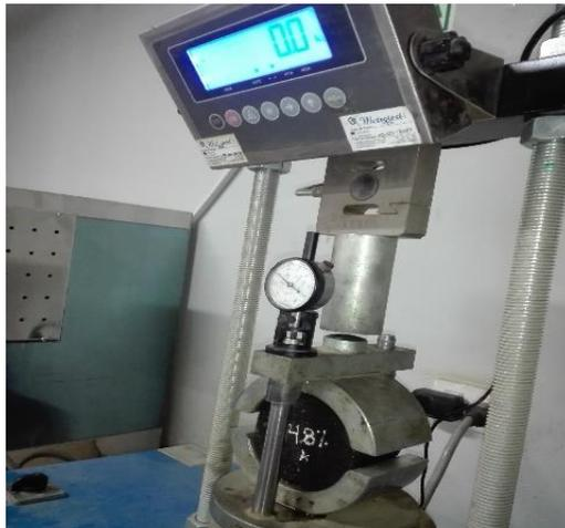
*Fotografía:* Ensayo Marshall.
