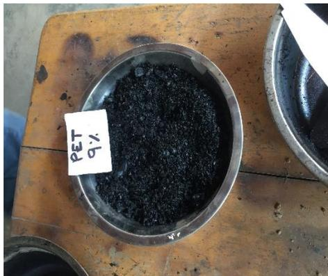
*Fotografía:* Mezclado de los agregados + PET
