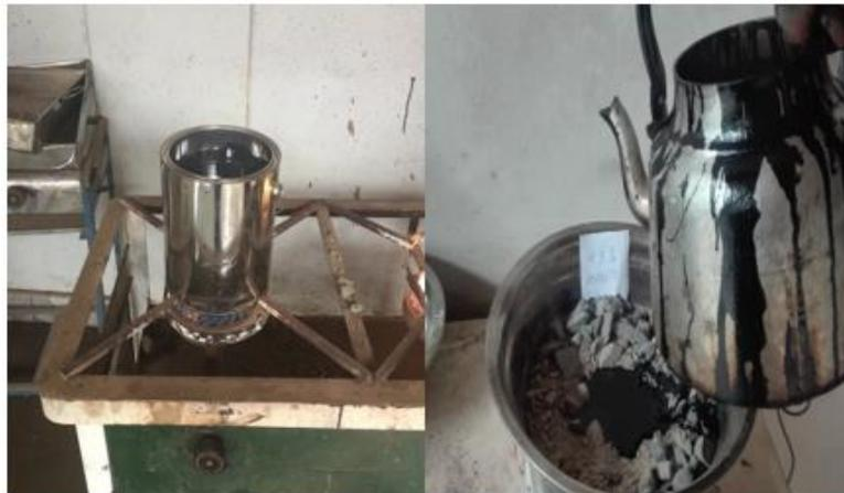
*Fotografía:* Después de tener las muestras en diferentes recipientes limpios y ser calentado previamente a una temperatura entre 93°C y 150°C aproximadamente se procede al cubrimiento de los agregados hasta que se haya mesclado totalmente la partícula más gruesa
