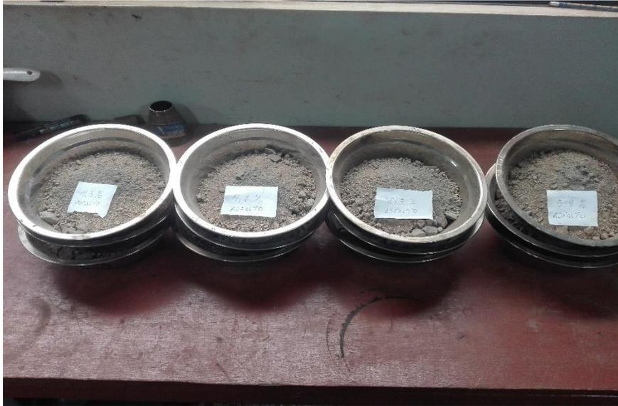
*Fotografía:* Diferentes muestras de los agregados a las cuales se le agregaran 4.3%, 4.5%, 5.3% y 5.8 % respectivamente de asfalto.
