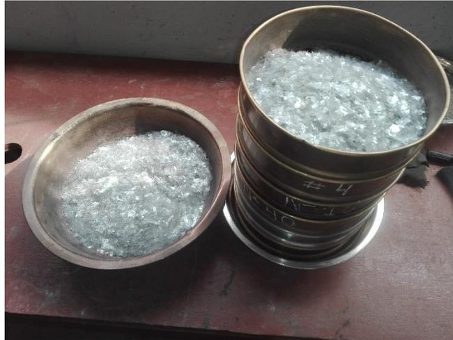
*Fotografía:* Tamizado del Tereftalato de polietileno para obtener su análisis granulométrico
