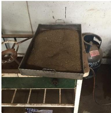
*Fotografía:* Secado del agregado grueso
