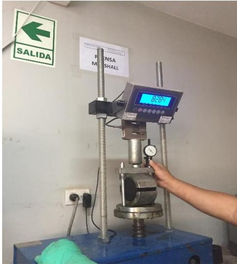
*Fotografía:* Ruptura de las Probetas (Prensa Marshall).
