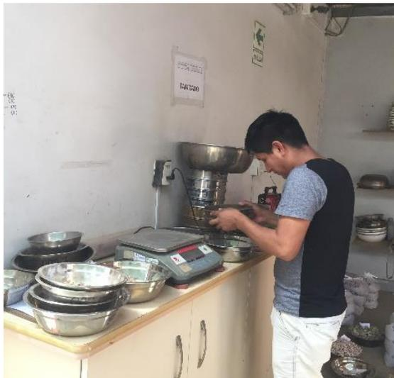
*Fotografía:* Realización del tamizado para la obtención del análisis granulométrico
