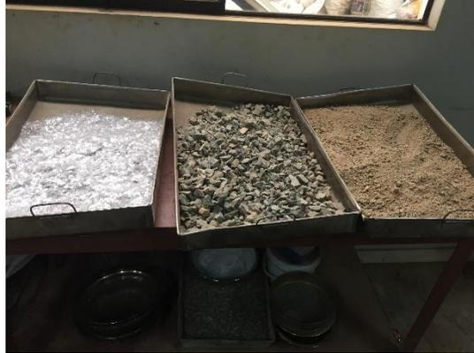
*Fotografía:* Preparación de los Agregados + PET
