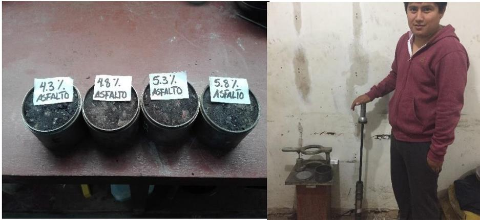
*Fotografía:* Se colocará las mezclas asfálticas dentro del molde para respectiva compactación.
