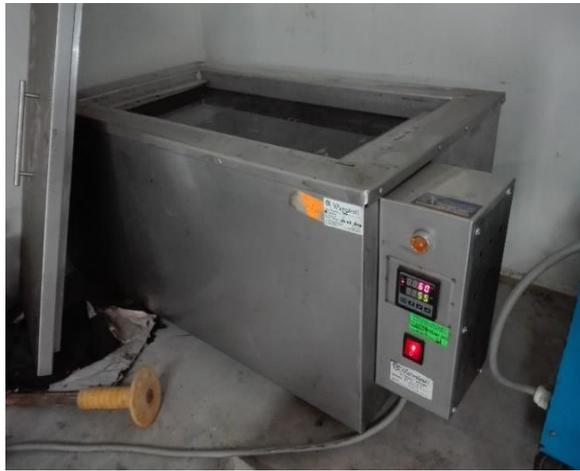
*Fotografía:* la briqueta después de obtener el peso específico se sumerge en el espécimen Baño María a 60°C durante 30 minutos
