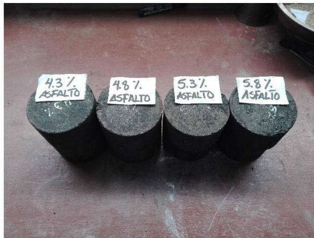
*Fotografía:* Extracción de las briquetas para lo cual se debe dejar enfriar para evitar algún daño al momento de extraer
