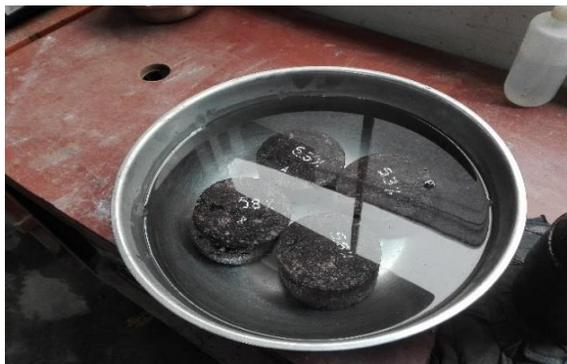
*Fotografía:* Determinación del Pesos Específico, se anota el peso de la probeta al aire, se le sumerge en el agua y también se registra su peso sumergido y sacar la muestra del agua, secar el exceso de agua y pesar.
