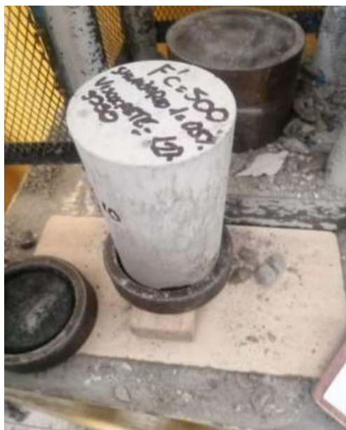
Imagen 17: Probetas de cilindro con dosificaciones 1.2 % SP + 0.5.% AC
