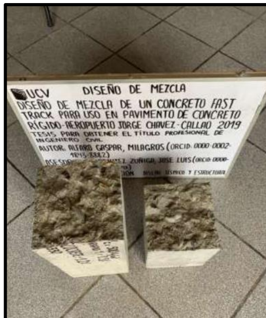
Figura 12: Rotura de la viga
