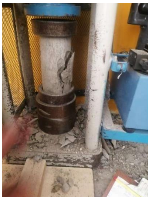
Imagen 19: Ensayo de Resistencia a la Compresión del concreto patrón
