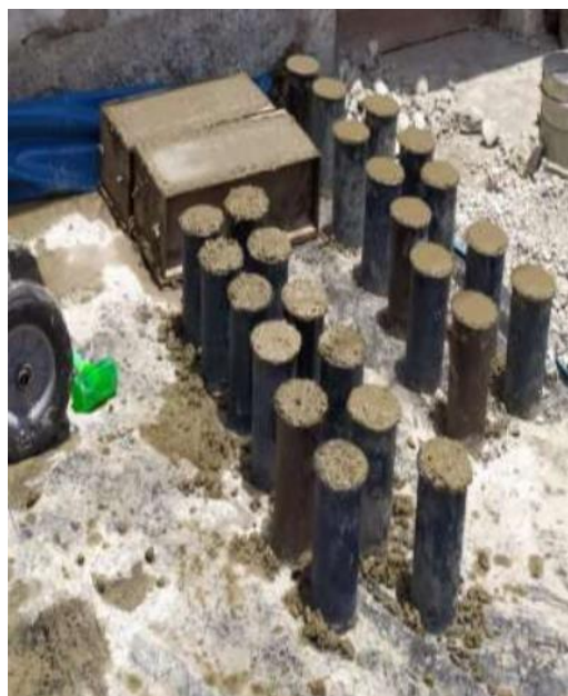
Imagen 14: Probetas y vigas del diseño de mezcla
