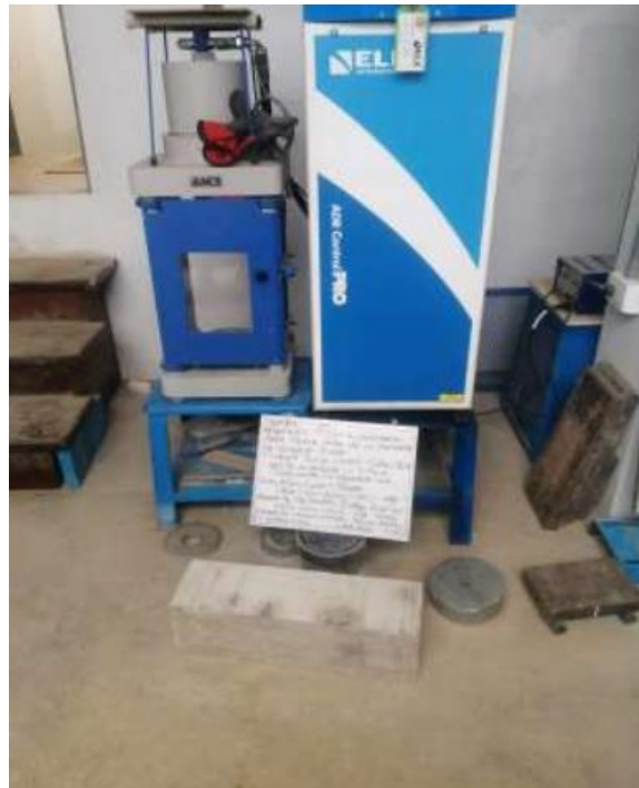
Imagen 28: Ensayo a la resistencia de flexión
