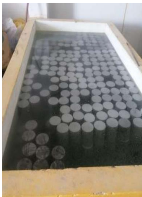
Imagen 16: Almacenamiento del concreto
