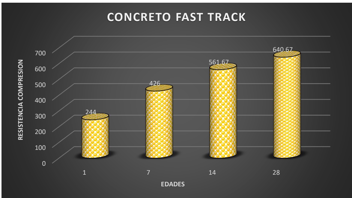
Gráfico 12: Resultado del concreto Fast Track (1.2 SP + 0.5 AC) en las edades 1,7,14 y 28 días, con un F'c : 500 kg/cm 2
