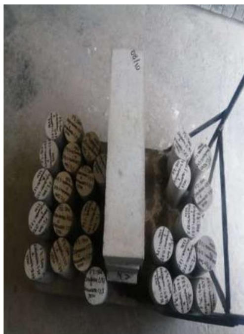
Imagen 15: Ensayos para probetas y vigas del concreto Fast Track
