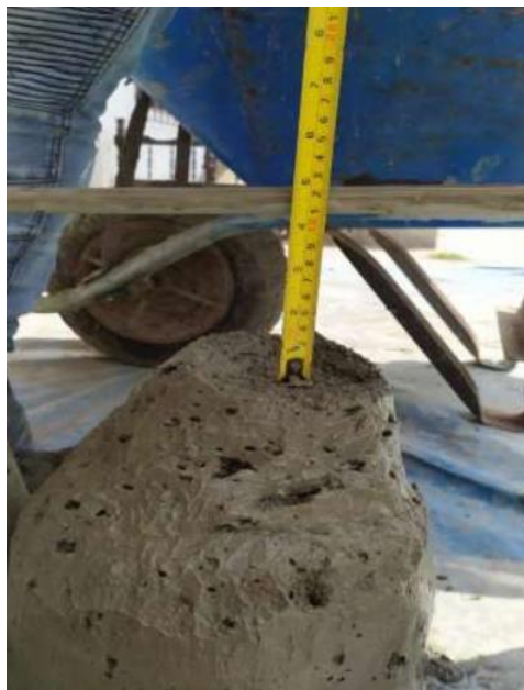
Imagen 11: Asentamiento del concreto
