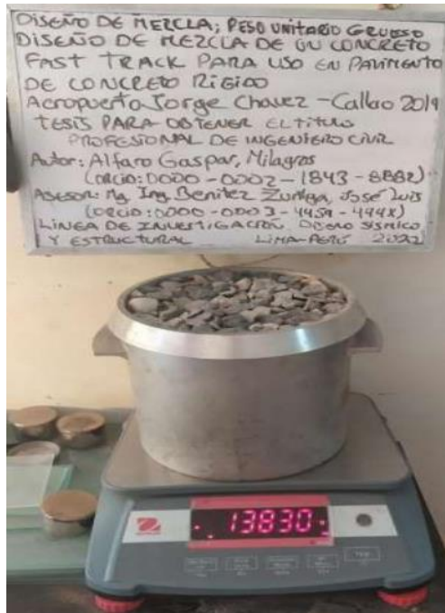
Imagen 9: Peso unitario agregado grueso
