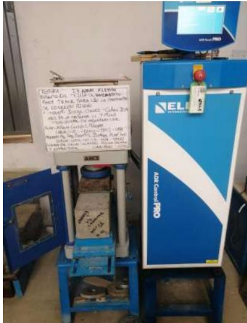
Imagen 29: Ensayo a la resistencia de flexión del concreto Fast Track
