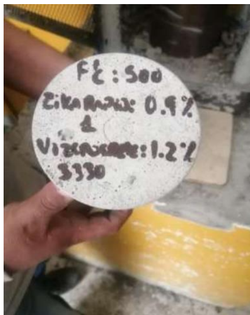
Imagen 18: Probetas de cilindro con dosificaciones 1.2 % SP + 0.9.% AC
