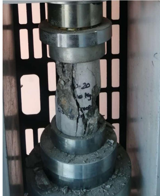
Imagen 26: Ensayo de Resistencia a la Compresión de edad 14 día
