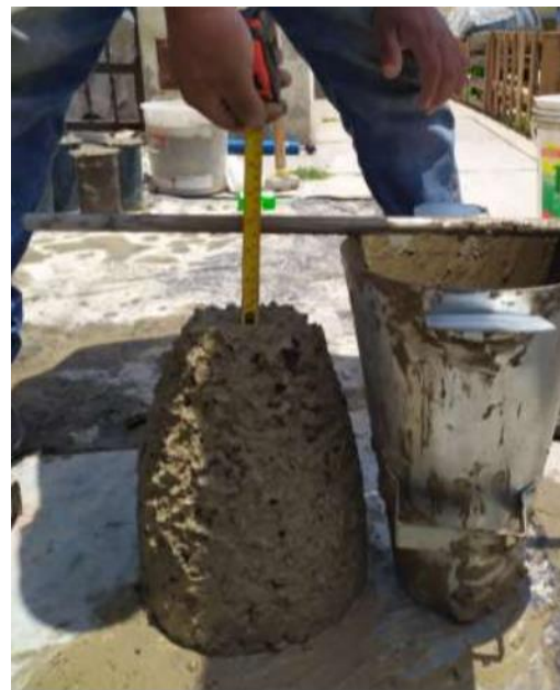
Imagen 12: Determinación del asentamiento (slump)
