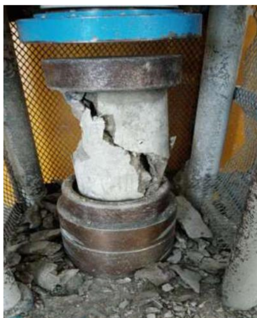
Imagen 20: Ensayo de Resistencia a la Compresión de edad 1 día
