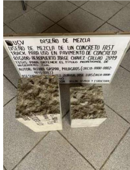
Imagen 30: Modulo de rotura de ensayo a a la resistencia de flexión
