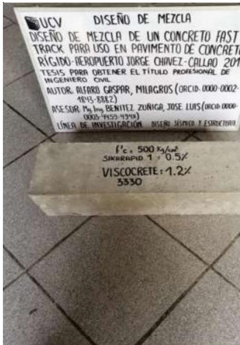
Imagen 27: Vigüeta de Concreto Fast Track con dosificaciones 1.2% SP + 0.5% AC
