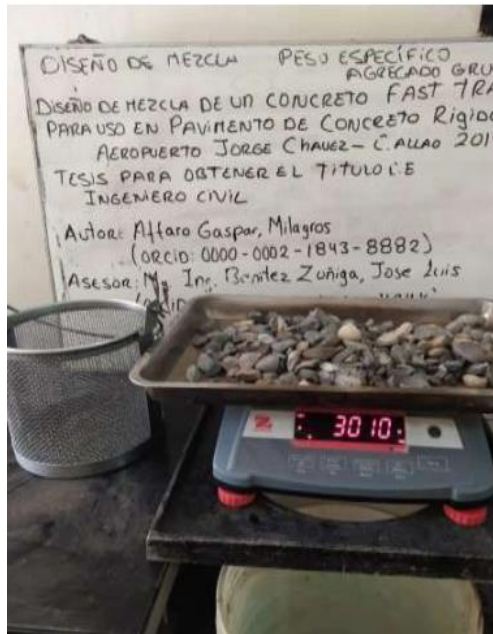
Imagen 5: Peso específico Agregado grueso
