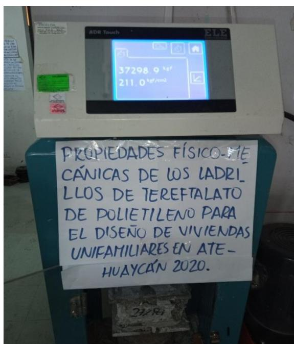
**Figura 50.** Resistencia a compresión en ladrillo con 27% pet a los 28 días.
