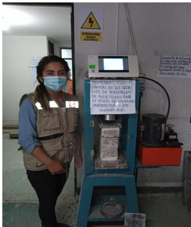
**Figura 56.** Ensayo de resistencia a compresión axial en pilas
