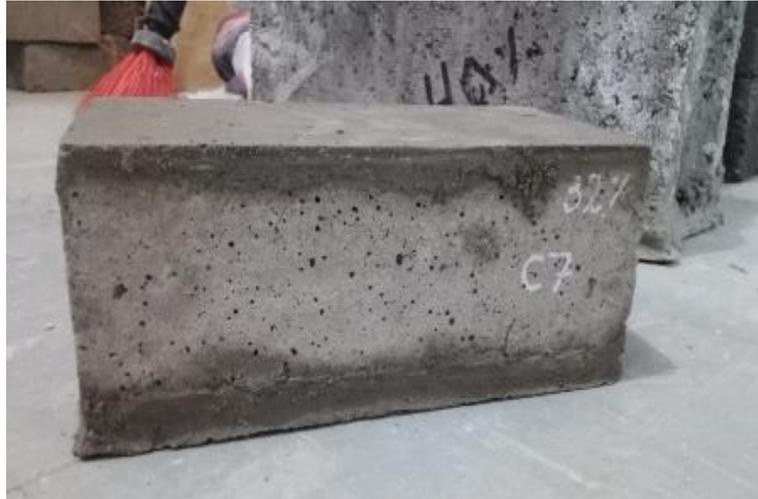
**Figura 45.** Preparación de las unidades de albañilería antes del ensayo.
