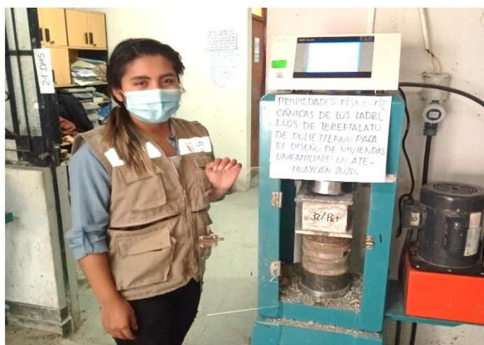
**Figura 52.** Resistencia a compresión en unidades de albañilería.
