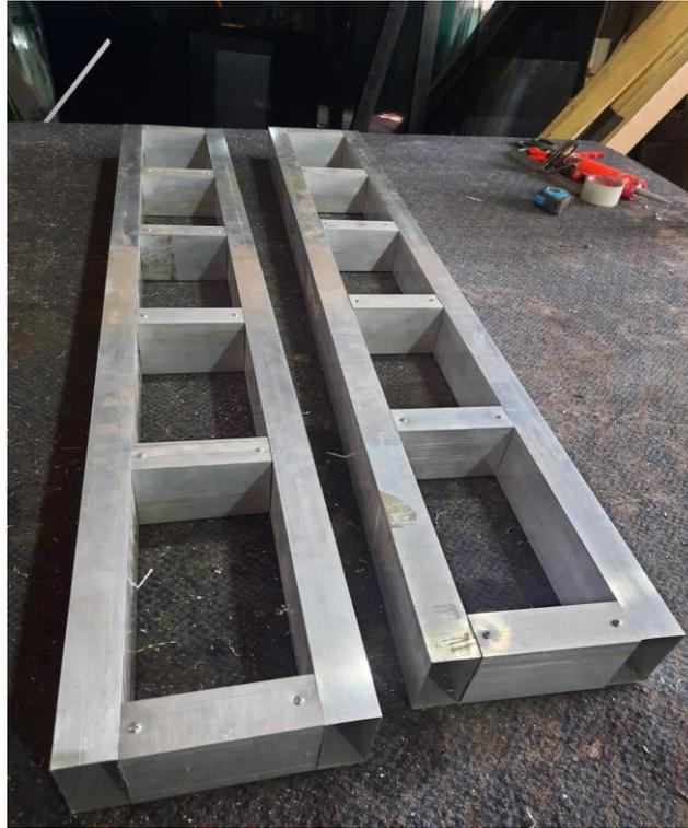
*Figura 29. Moldes para elaboración de ladrillos.*
