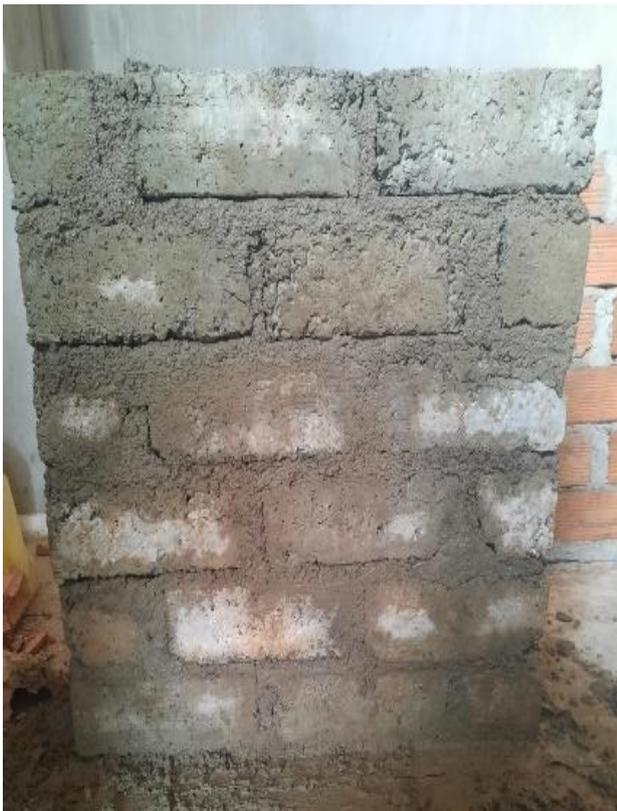
**Figura 62.** Muestra para el ensayo a Compresión Diagonal en Murete en diferentes porcentajes de PET a los 14 días.
