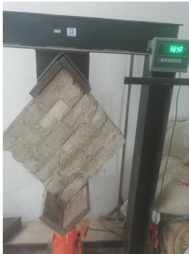
**Figura 61.** Ensayo de resistencia a compresión diagonal en Murete.
