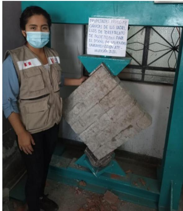
**Figura 64.** Ensayo de resistencia de compresión diagonal en muretes de albañilería a los 28 días.
