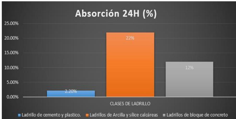
**Figura 67.** Gráfico comparativo de ensayo de absorción con distintas clases de ladrillo.
