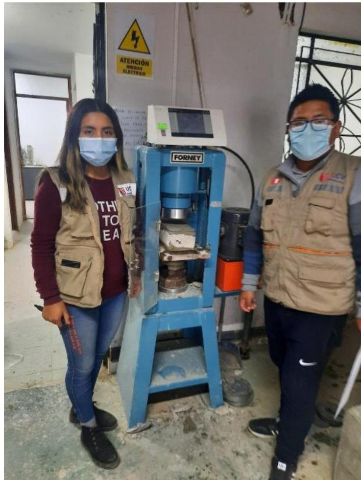
**Figura 46.** Ensayo de Resistencia a Compresión del ladrillo con 27%, 32% y 37% de plástico.
