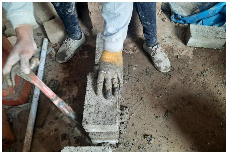
**Figura 54.** Elaboración de pilas con ladrillos con pet.
