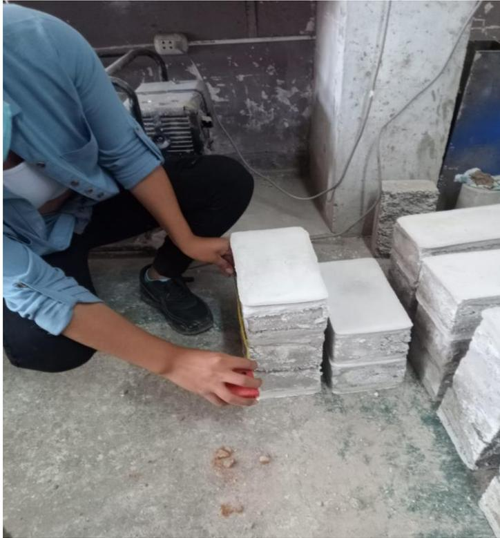
**Figura 55.** Medición de pilas de albañilería.
