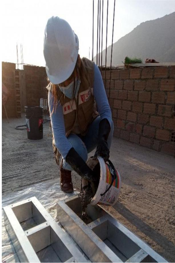
**Figura 34.** Vaciado de la mezcla.
