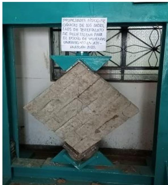
**Figura 65.** Ensayo de resistencia de compresión diagonal en muretes de albañilería elaborados con ladrillos fabricados con 27%, 32% y 37% pet.
