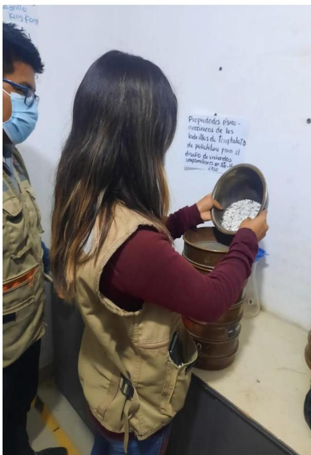
**Figura 16.** Ensayo granulométrico del pet.
