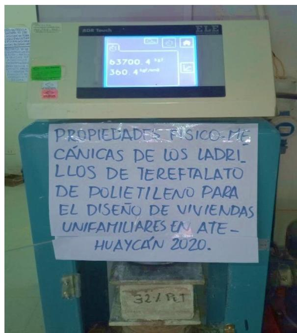
**Figura 51.** Resistencia a compresión en ladrillo con 32% pet a los 28 días.
