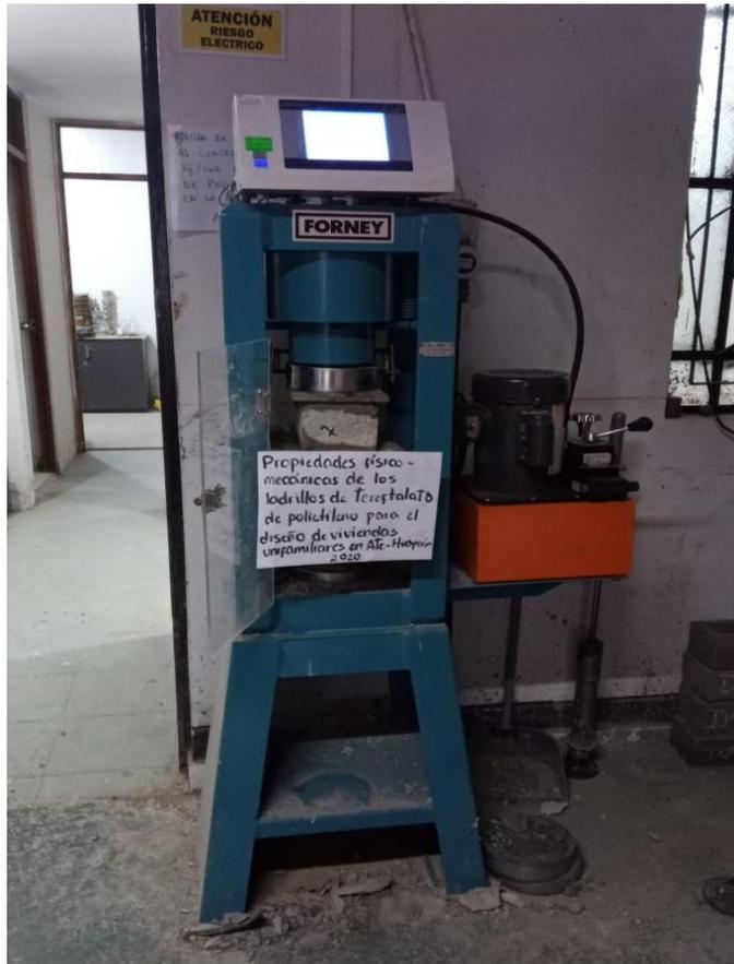
**Figura 47.** Ensayo de resistencia a compresión del ladrillo con plástico.
