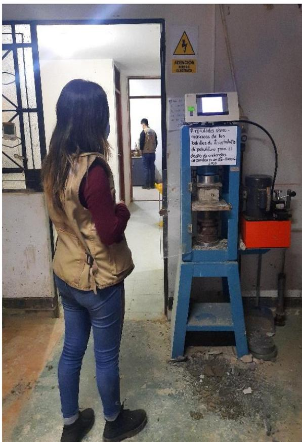
**Figura 101.** Ensayo a compresión de unidades de albañilería
