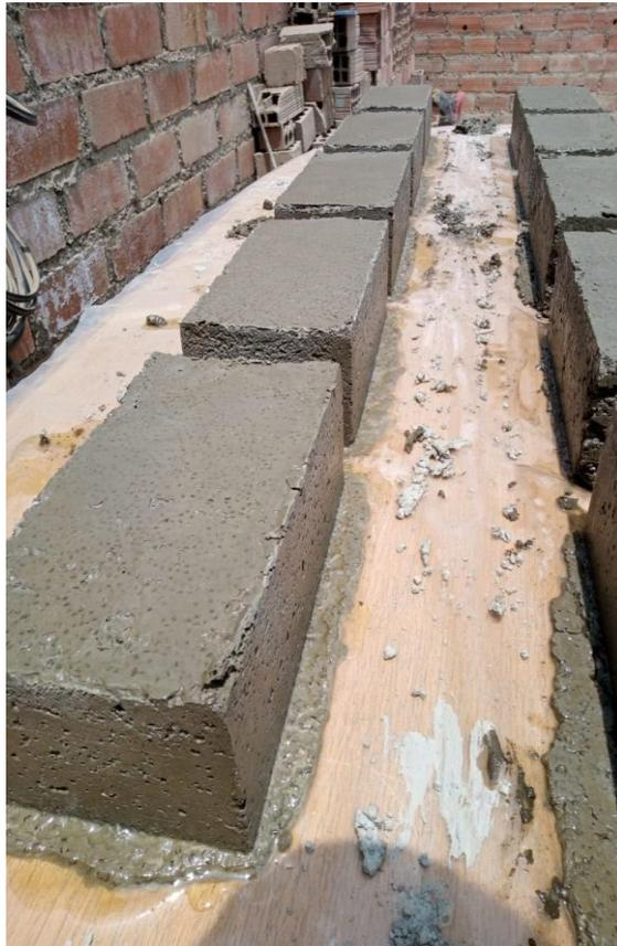
**Figura 96.** Secado de ladrillos.
