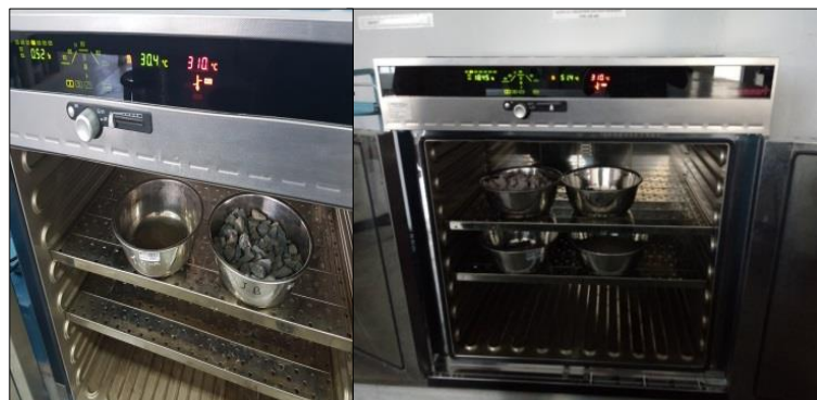
Imagen 19: Colocación de muestras el horno a 100^{\circ}\text{C} \pm 5^{\circ}\text{C} por 24 horas. 42
