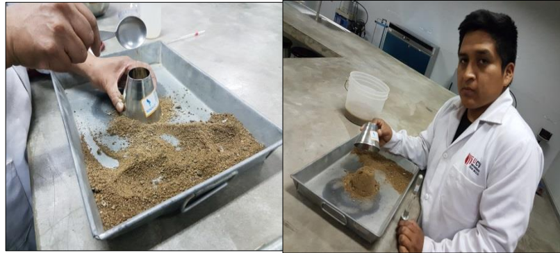
Imagen 22: Compactado y demostración que el material fino se encuentra saturado superficialmente seco (sss). 47
