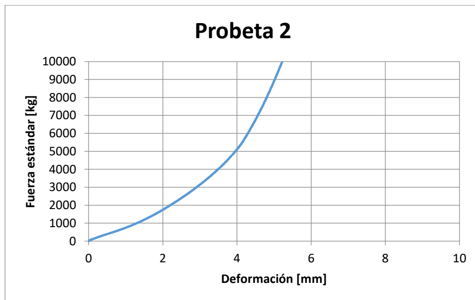
Imagen 53: Módulo elasticidad para diseño con Relación a/c 0.31 B, Norma ASTM C-469 140
