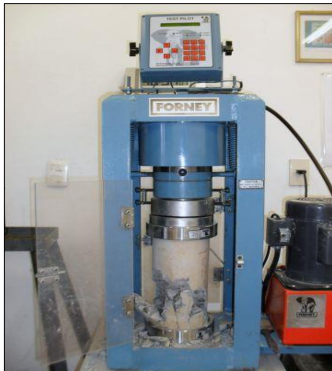
Imagen1: Ensayo de compresión del concreto. 7
