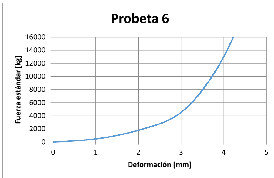
Imagen 55: Módulo elasticidad para diseño con Relación a/c 0.28 B, Norma ASTM C-469 142
