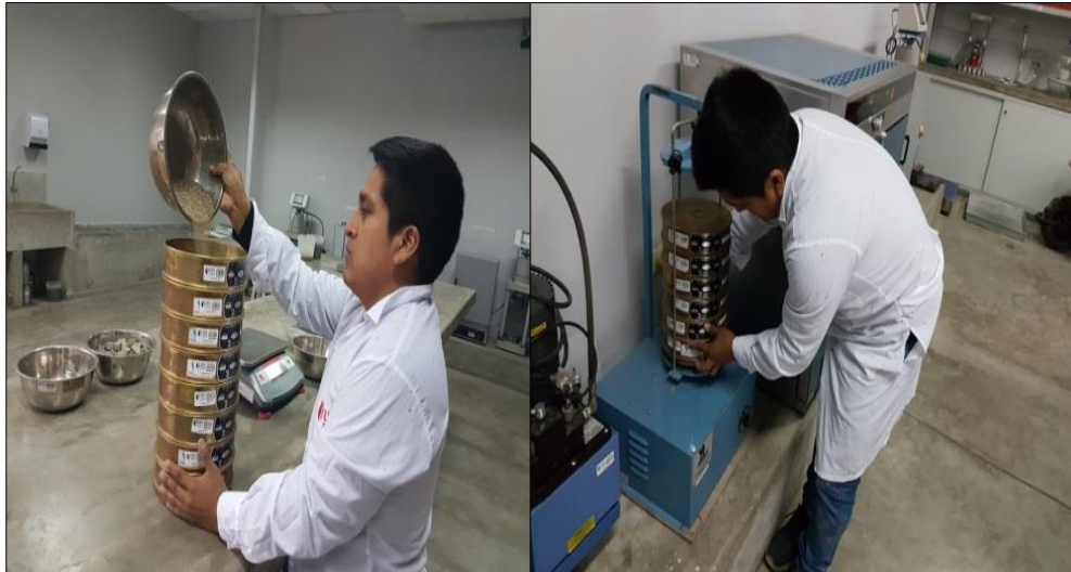
Imagen 12: Tamizado del agregado fino en tamices sobre agitador mecánico. 30
