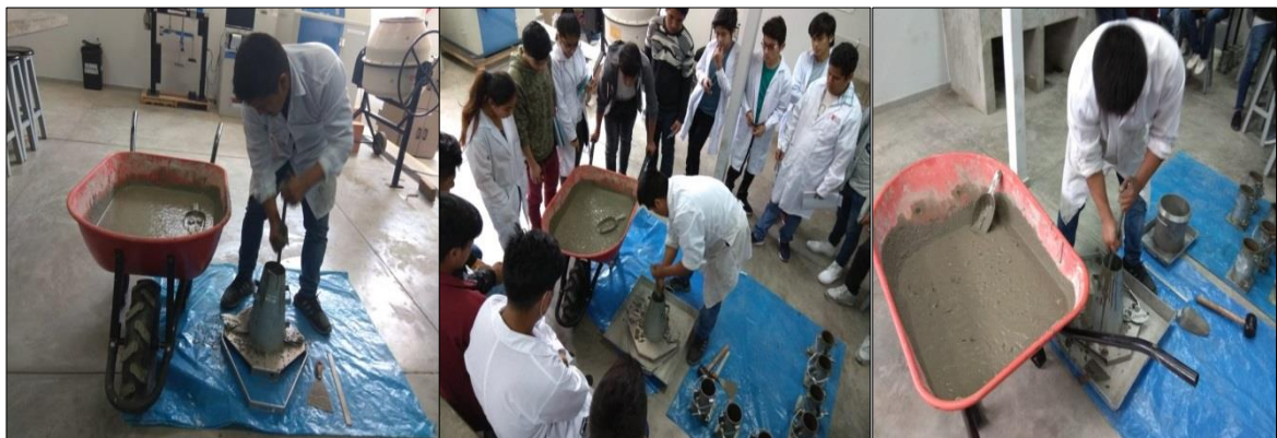
Imagen 35: Proceso de slump 111
