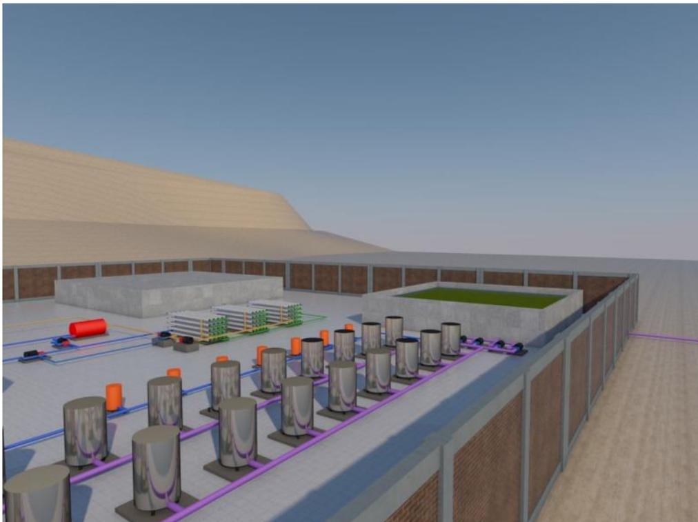
Figura 31 – Vista de Filtros de Veolia Water Technologies de la serie FIC-300 Y FIT-300 y Tanques F.C
