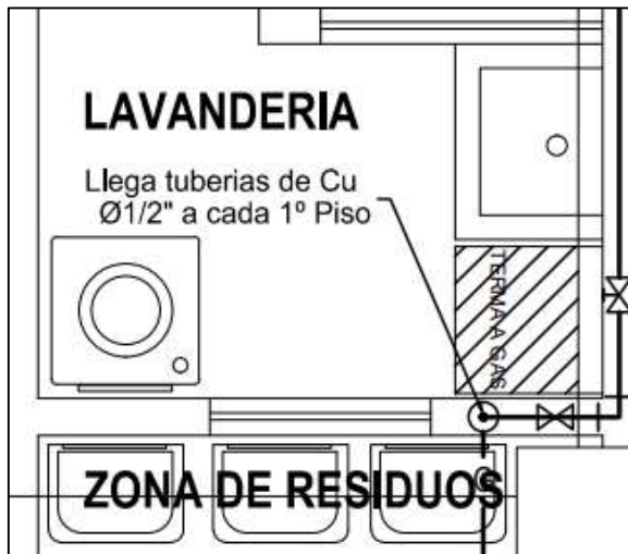
Figura 88. Punto de gas para el calentador de agua (1° Piso)
