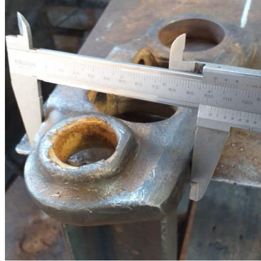
Figura 09. Medición del eslabón desgastado.
