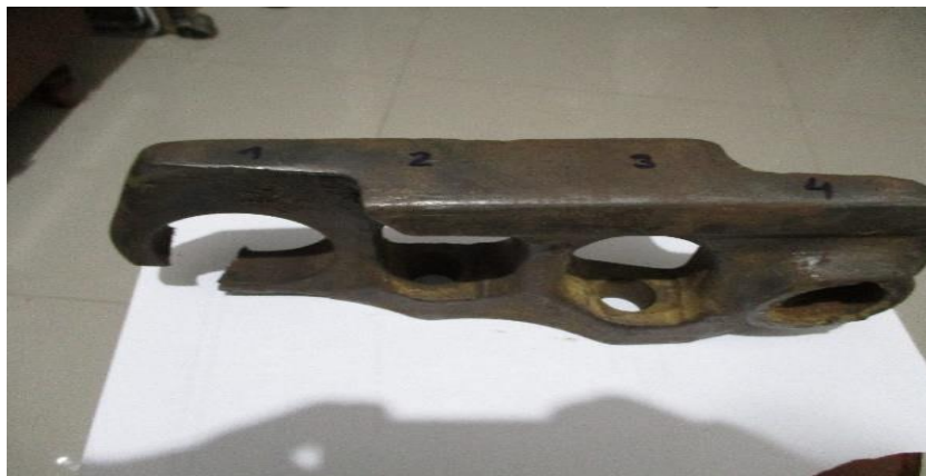
Figura 14. Eslabón desgastado, cuatro puntos medición de la dureza.
