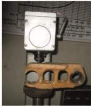
Figura 7. Medición de dureza de la posición 1 del eslabón nuevo.
