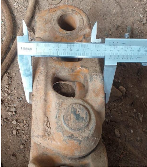
Figura 08. Medición del eslabón sin uso.
