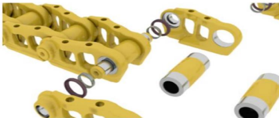
Figura 01. Armado de cadena
