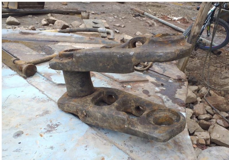
Figura 07. Verificación de la magnitud de desgaste en eslabón.
