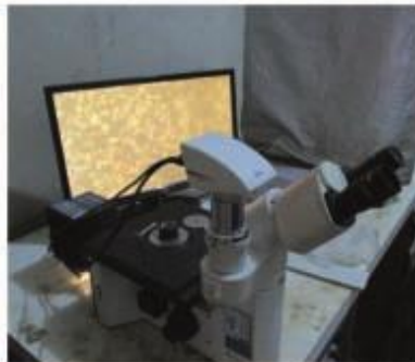
Figura 16. Microscopio metalográfico Leica de 50 – 1000 X con pantalla de proyección de la microestructura.
