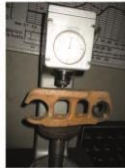
Figura 8. Medición de dureza en la posición 2 del eslabón nuevo.
