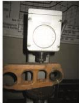
Figura 9. Medición de dureza de la posición 3 del eslabón nuevo.
