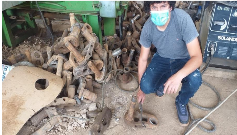
Figura 06. Desmontaje de eslabones.
