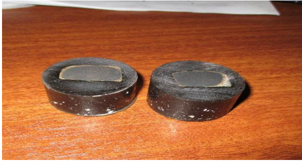
Figura 19. Probetas encapsuladas para los respectivos análisis metalográfico de los eslabones.
