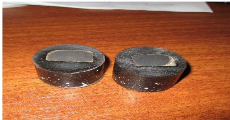
Figura 26. Probetas encapsuladas para el respectivo análisis metalográfico.
