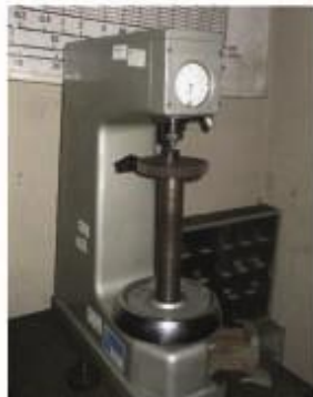
Figura 3. Durómetro analógico. Marca Frank, Escala Rockwell C
