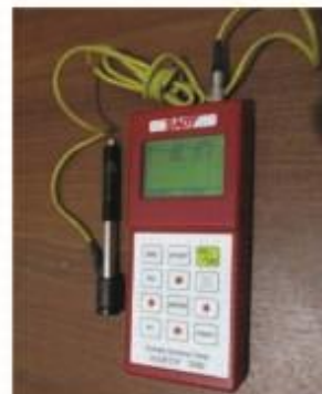
Figura 4. Durómetro portátil universal digital SADT- HARTIP 3000. Escala Rockwell C
