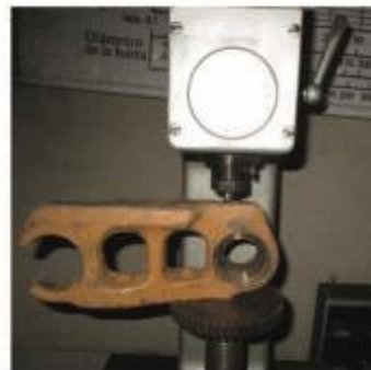
Figura 10. Medición de dureza en la posición 4 del eslabón nuevo.
