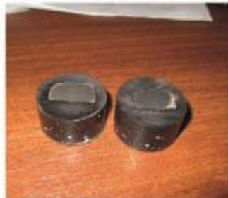
Figura 18. Probetas encapsuladas para la los respectivos análisis metalográfico de los eslabones del cadena de arrastre de excavadora 320 D2L.
