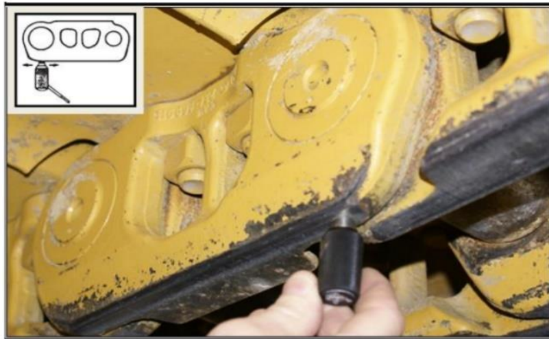
Figura 02. Medición de desgaste de eslabón
