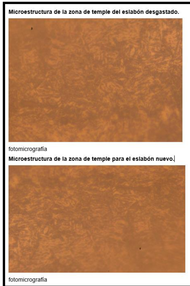
Figura 34. Microestructura de ambos eslabones.
