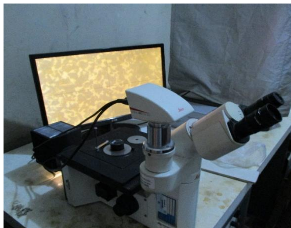
Figura 18. Microscopio metalográfico Leica de 50 – 1000 X con pantalla de proyección de la microestructura.
