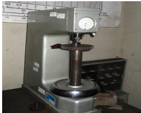
Figura 13. Durómetro analógico. Marca Frank. Escala Rockwell C.
