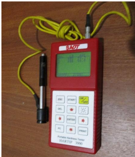
Figura 22. Durómetro portátil universal digital SADT- HARTIP 3000. Escala Rockwell C. Fuente: laboratorio metalúrgica física y ensayos mecánicos, (UNT).
