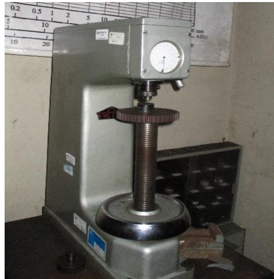
Figura 23. Durómetro analógico. Marca Frank. Escala Rockwell C. Fuente: laboratorio metalúrgica física y ensayos mecánicos (UNT).
