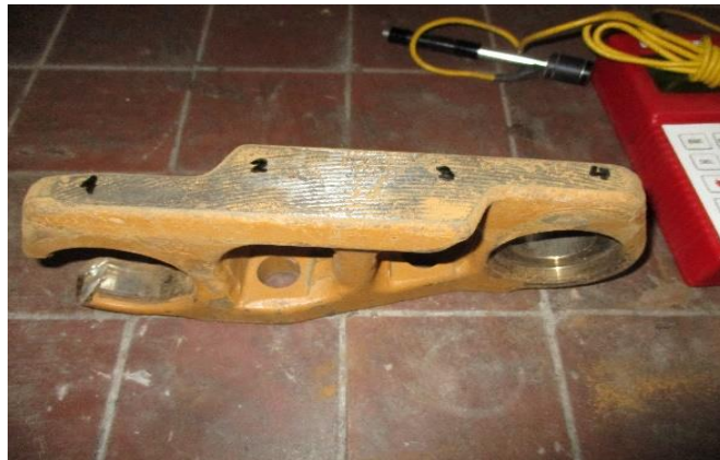
Figura 26. Medición de dureza en las 4 posición del eslabón nuevo. Fuente: laboratorio metalúrgica física y ensayos mecánicos (UNT).
