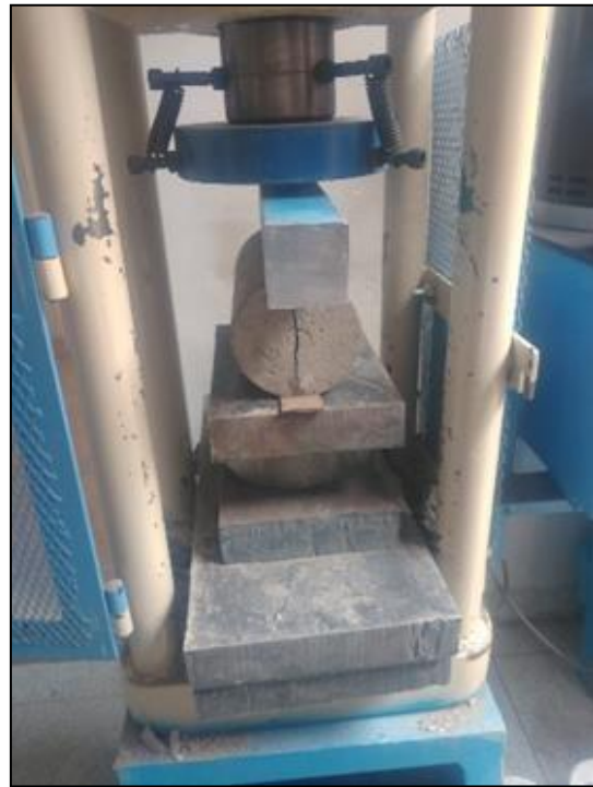
Figura 14. Rotura de probetas de compresión y tracción diametral
