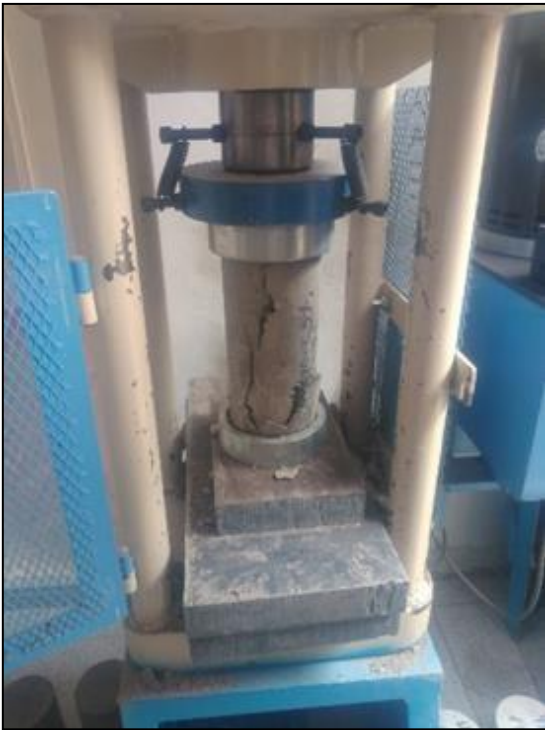
Figura 14. Rotura de probetas de compresión y tracción diametral
