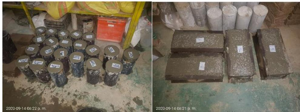
Figura 12. Moldes cilíndrico y viguetas.
