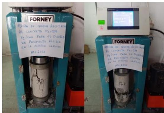
Figura 13. Ensayo de compresión.
