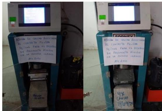
Figura 14. Ensayo de flexión.
