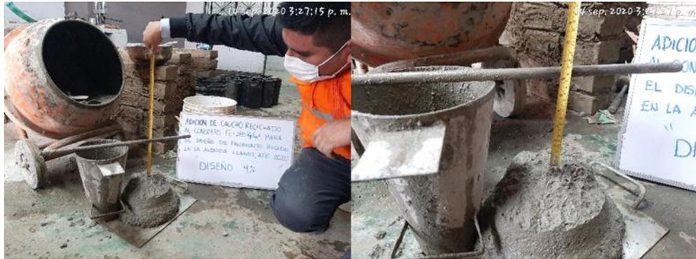
Figura 11. Prueba de trabajabilidad – Concreto con adición de 4% caucho.
