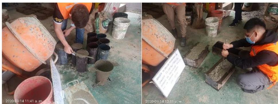
Figura 9. Muestra cilíndrica y vigueta del patrón.
