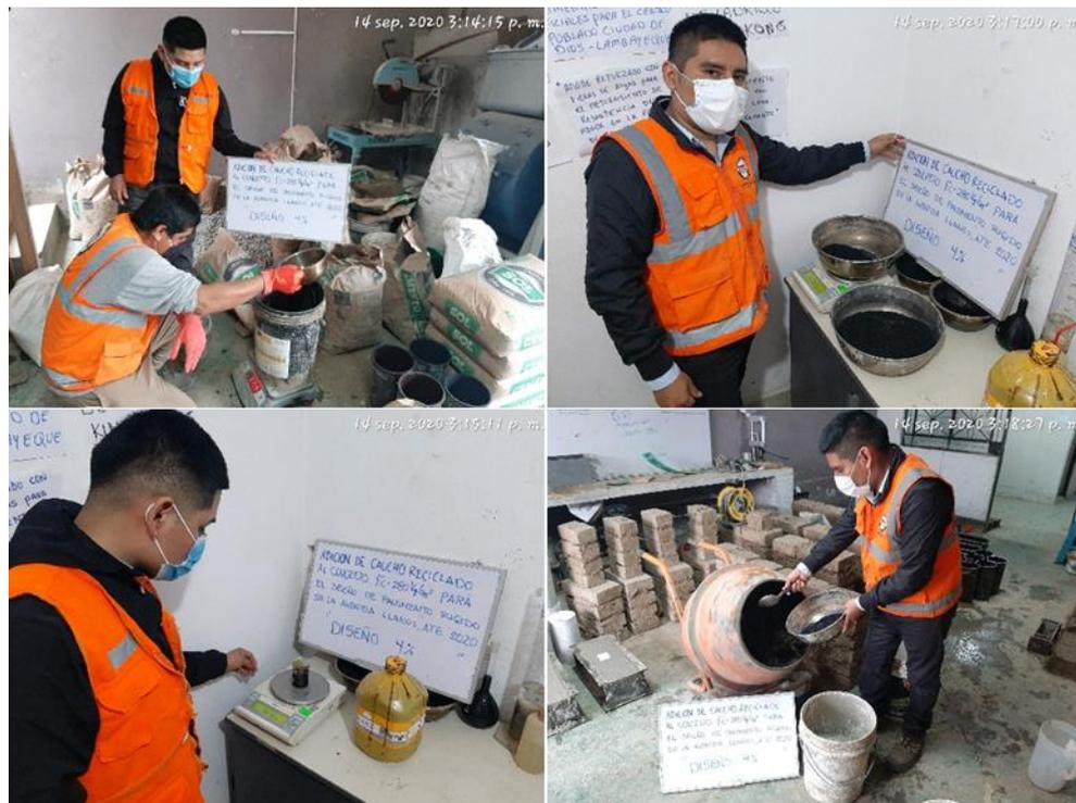
Figura 10. Mezclado de concreto con adición de 4% caucho.
