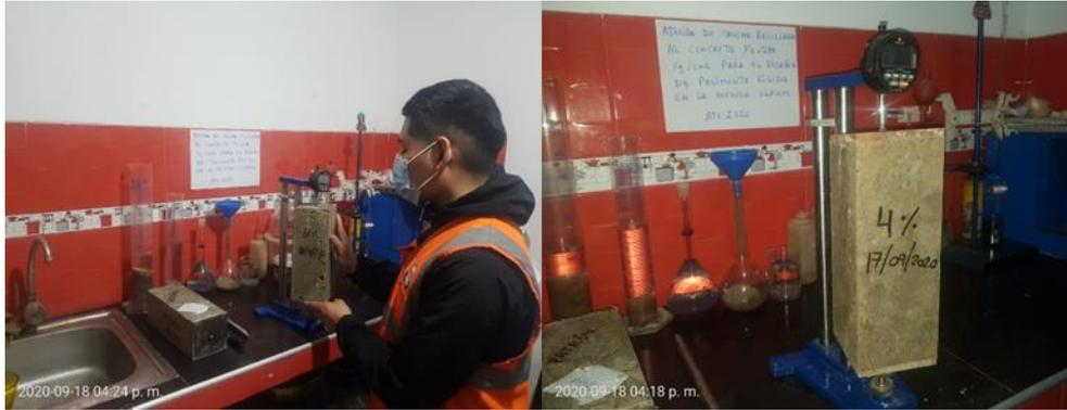
Figura 15. Ensayo de retracción.
