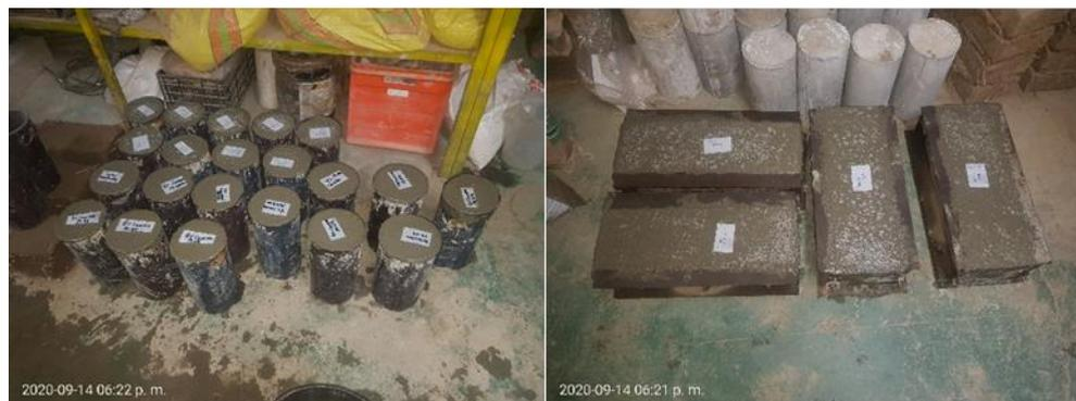
Figura 12. Moldes cilíndrico y viguetas.
