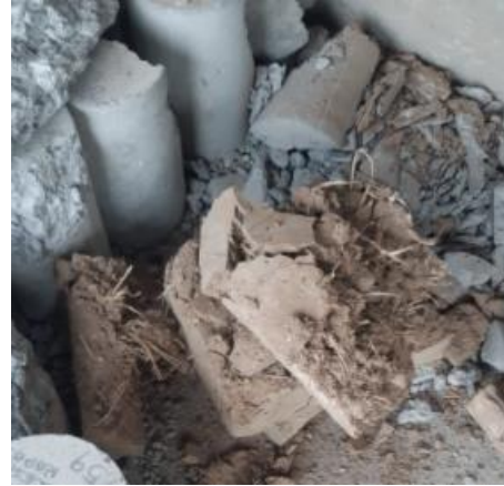
Figura 28. Resultado del ensayo a flexión de los Adobes con adición de cascarilla de arroz
