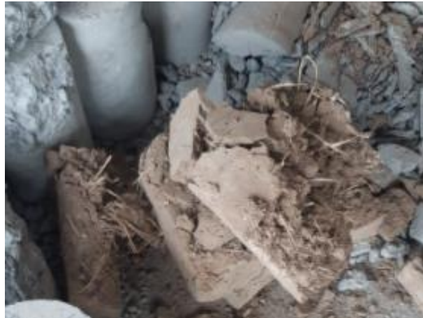
Figura 31. Resultado del ensayo a flexión de los Adobes con adición de plástico reciclado molido
