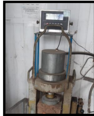
Figura 25. Resultado del ensayo de Compresión de los Adobes con adición de plástico reciclado molido
