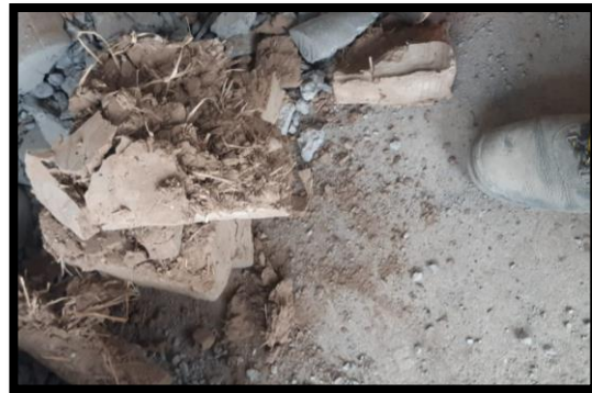
Figura 22. Resultado de la presión por el ensayo Compresión de los Adobes con adición de cascarilla de arroz
