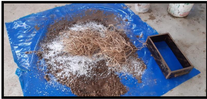
Figura 18. Mezcla de materiales de adobe patrón y adiciones
