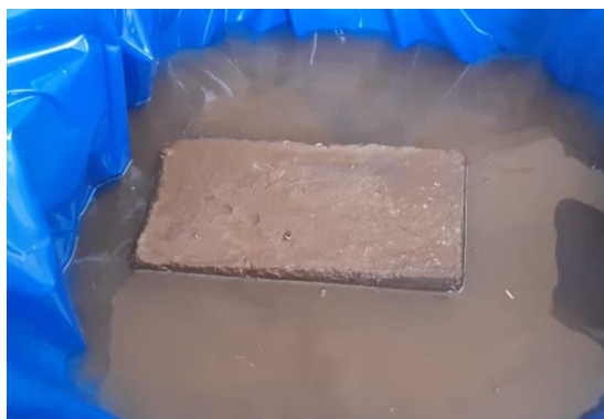
Figura 33. Ensayo de Porcentaje de Absorción con adición de cascarilla de arroz
