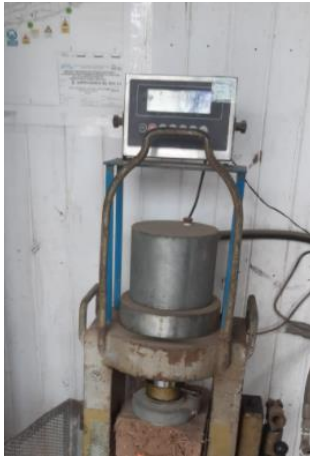
Figura 30. Ensayo de Resistencia a la Flexión con adición de plástico reciclado molido
