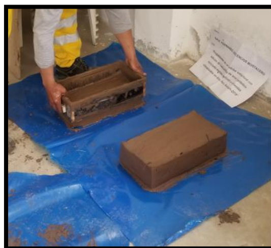
Figura 16. Desmolde de adobes en el laboratorio
