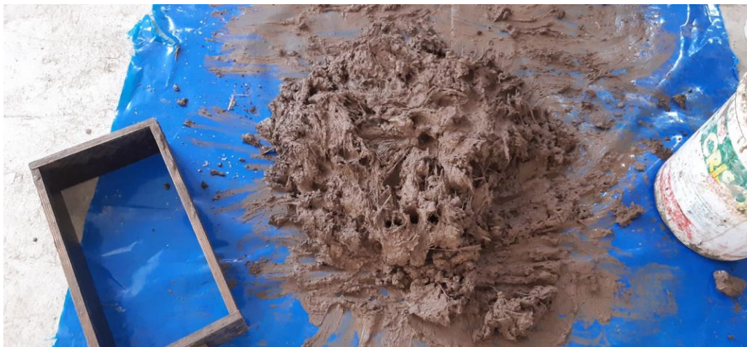
Mezcla antes de colocar en molde de adobe
