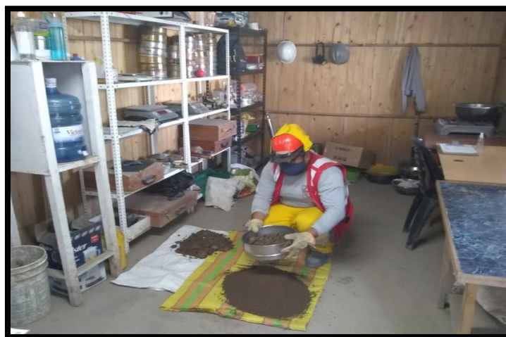
Figura 20. Ensayo Granulométrico en el laboratorio
