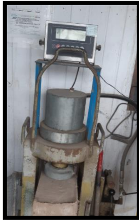
Figura 21. Ensayo de Resistencia a la compresión con adición de cascarilla de arroz
