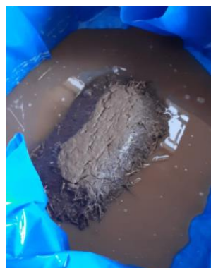
Figura 34. Resultado del Ensayo de Porcentaje de Absorción con adición de cascarilla de arroz
