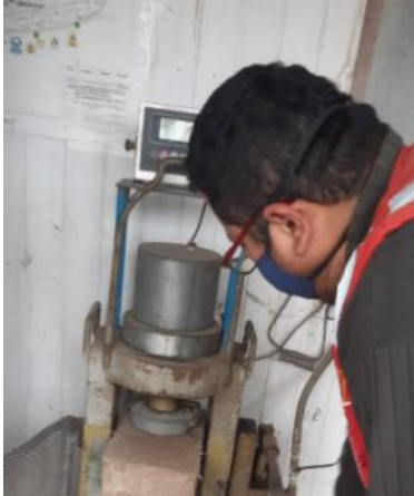
Figura 27. Ensayo de Resistencia a la Flexión con adición de cascarilla de arroz
