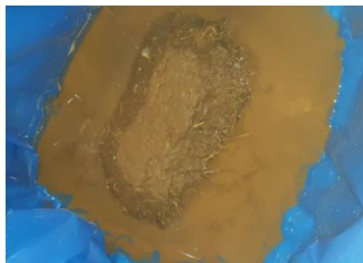
Figura 37. Resultado del Ensayo de Porcentaje de Absorción con adición de plástico reciclado molido
