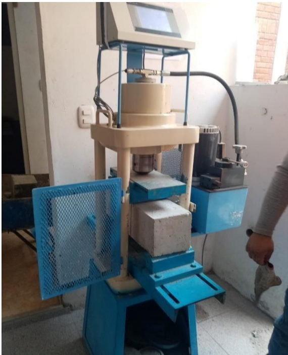
Figura 24: Colocación de la viga
