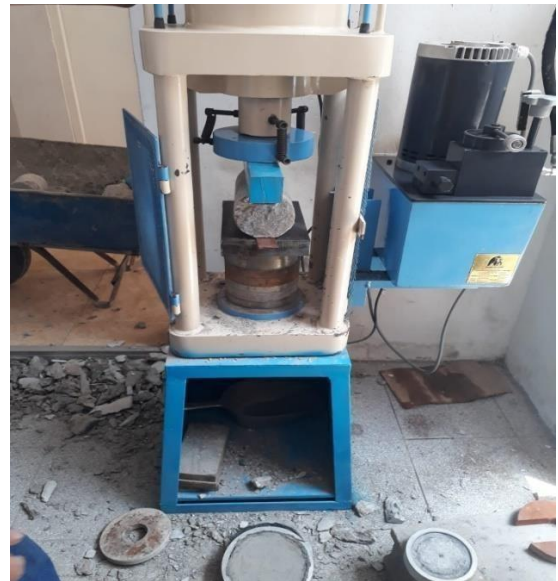
Figura 21: Ensayo a la tracción por compresión diametral
