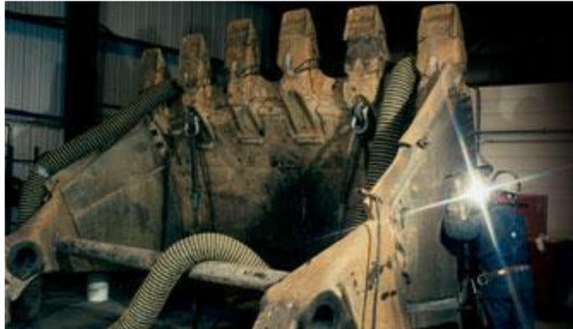
Figura 01. Aplicación de un recargue duro en el cucharón de un equipo minero (Horwitz, 2009)
