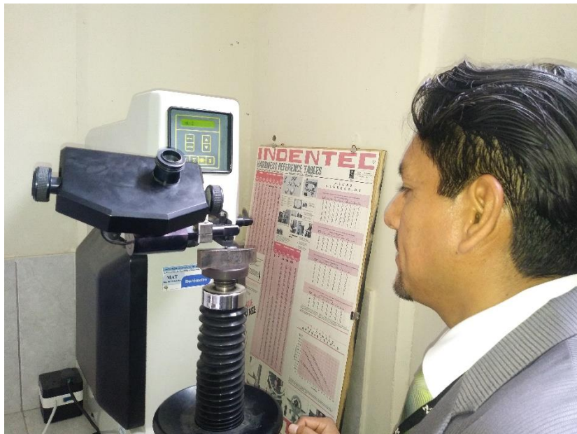
Figura 13. Medición de dureza con el Durómetro INDENTEC.
