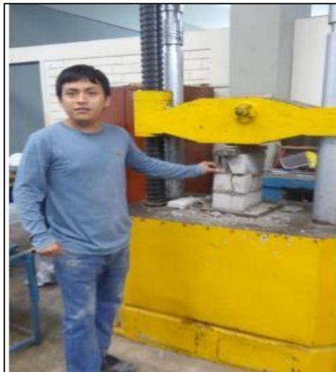
*figura 34* La pila de ladrillo de Concreto con cenizas de Guayacán (15%).
