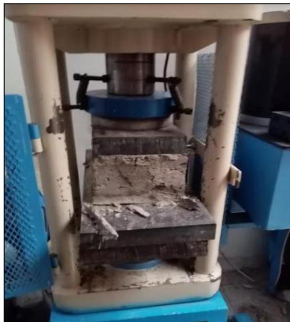
*figura 30* Ladrillo de Concreto con cenizas de Guayacán (10%).
