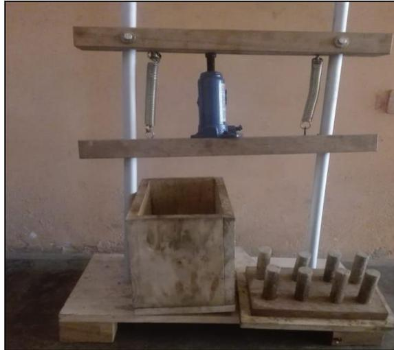
figura 22 Fotografía de máquina no convencional para prensar ladrillos
