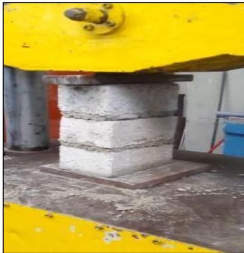
*figura 33* La pila de ladrillo de Concreto con cenizas de Guayacán (15%).
