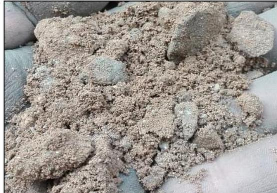
figura 16 Fotografía de la muestra (finos con material granular)
