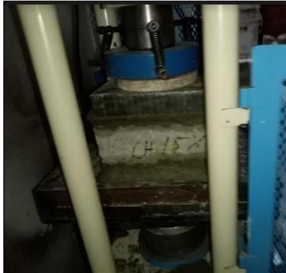
figura 31 Ladrillo de Concreto con cenizas de Guayacán (15%).
