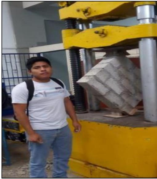
*figura 36* El murete de ladrillo de Concreto con cenizas de Guayacán (15%).
