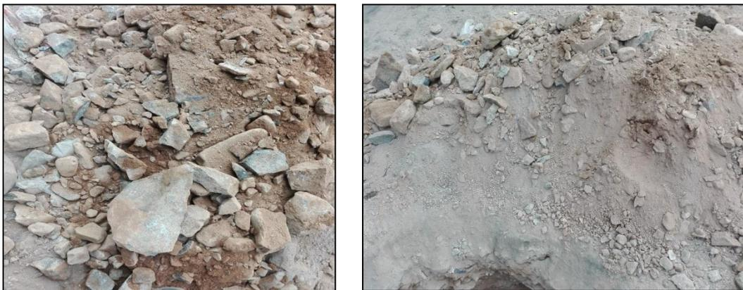
*figura 18* material extraído de la excavación sin presencia de materia orgánica
