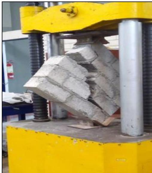
*figura 37* El murete de ladrillo de Concreto con cenizas de Guayacán (15%).
