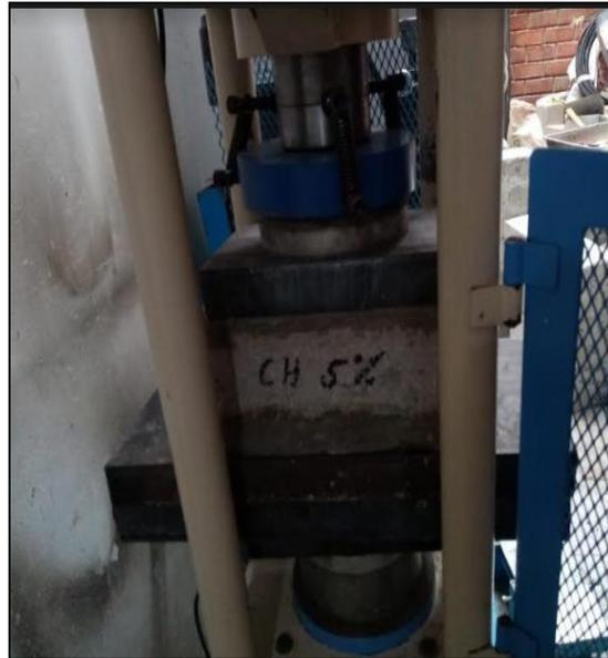
*figura 29* Rotura a compresión de ladrillo 5%
