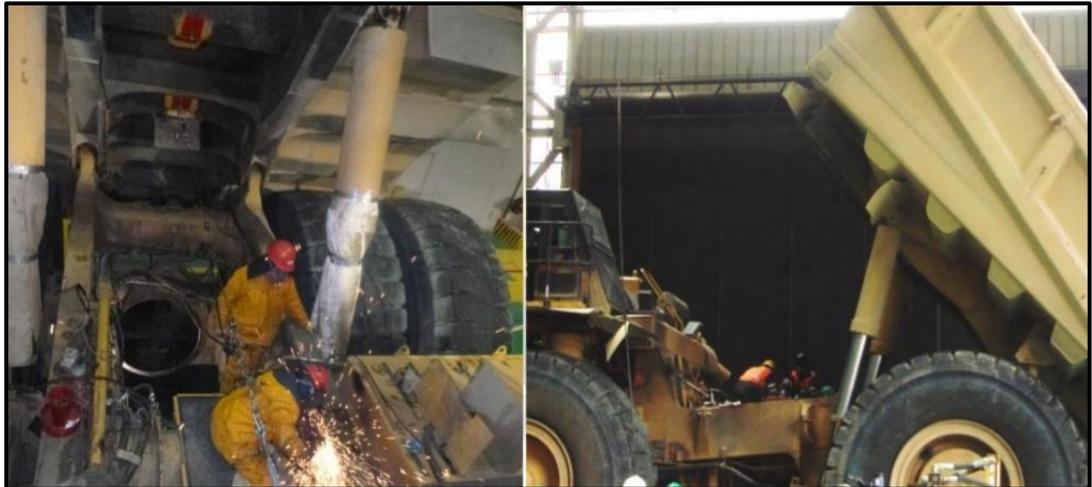
*Figura 04.* Trabajo de mantenimiento de chasis con tolva montada y levantada en camión cat 793.
