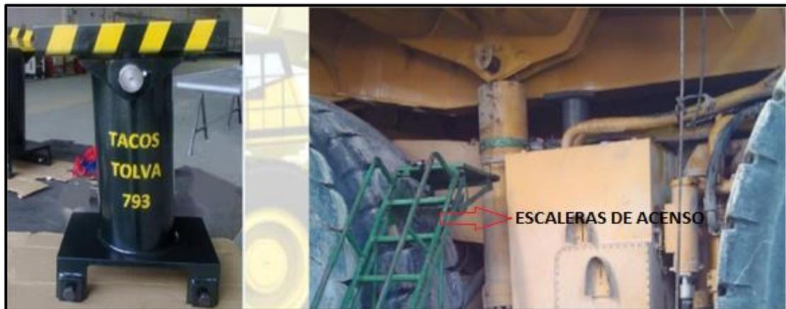
*Figura 06.* Representación de soportes de retención y la escalera de acenso.
