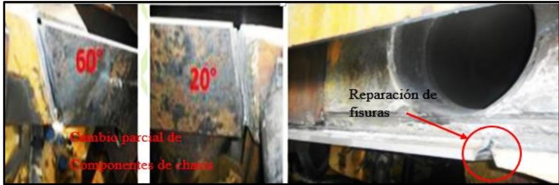
Figura 08. Operaciones realizadas durante el mantenimiento de chasis camión cat 793.
