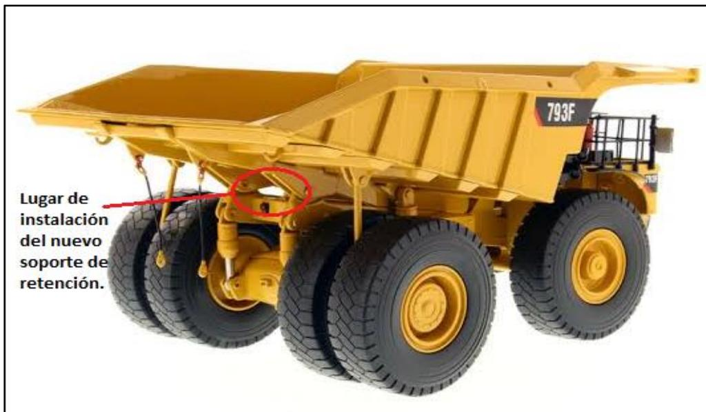
*Figura 11.* Detalle del espacio disponible para el nuevo soporte en el camión cat 793.
