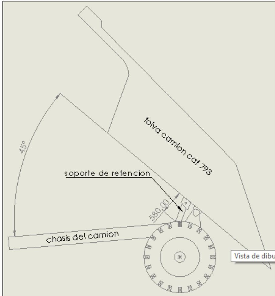
Figura 14. Detalle de la longitud del soporte con la tolva totalmente levantada
