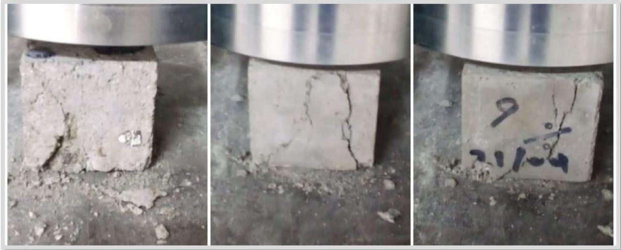
*Figura 40.* Rotura del mortero experimental con 9% de ceniza de maíz a la edad de 14 días.
