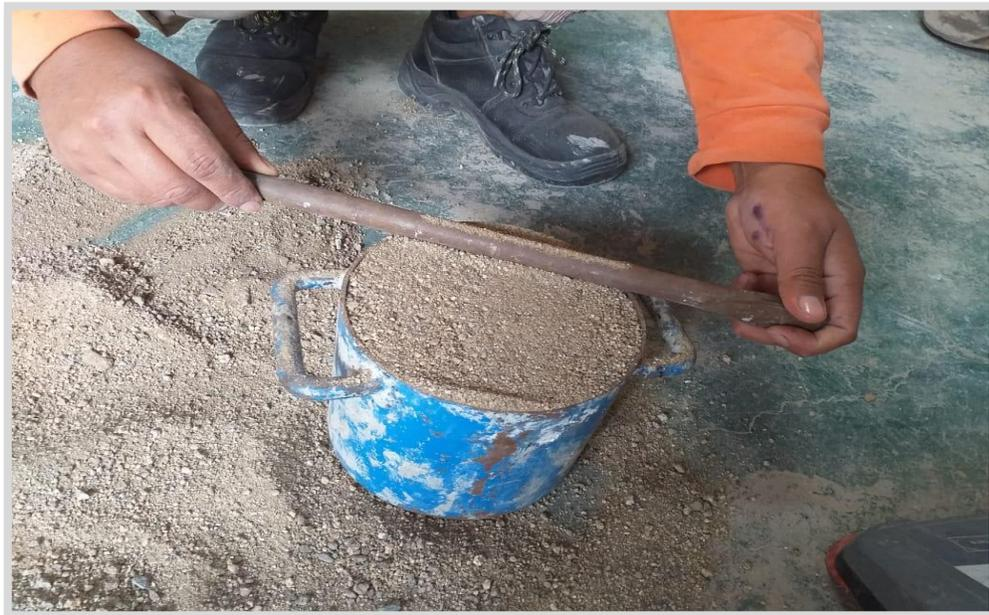
Figura 64. Enrazar el agregado fino.
