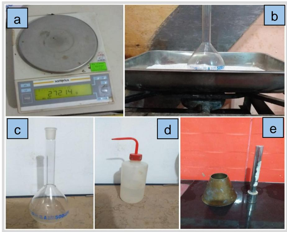
Figura 10. Instrumentos y equipos para el Peso Específico.
