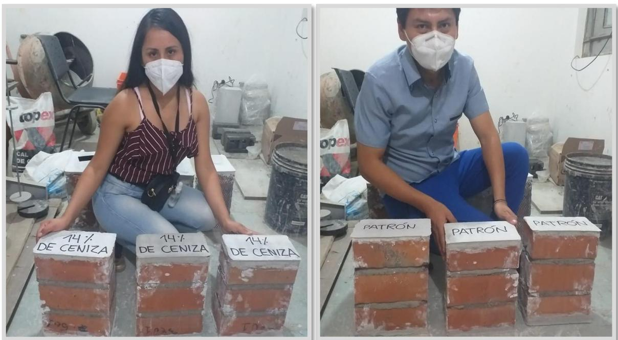
Figura 77. Pilas experimentales y pilas patrón aptas para la resistencia a compresión axial.
