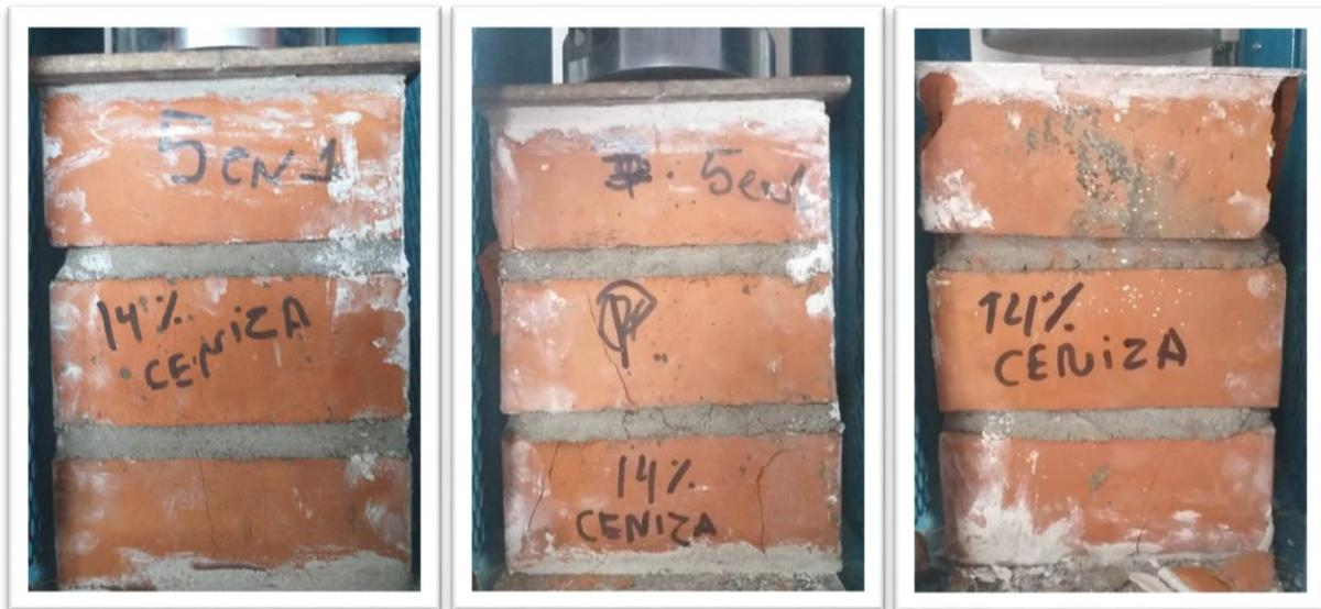
Figura 56. Resistencia a la compresión axial de la pila experimental con mortero del 14% de ceniza de tusa de maíz a la edad de 28 días.
