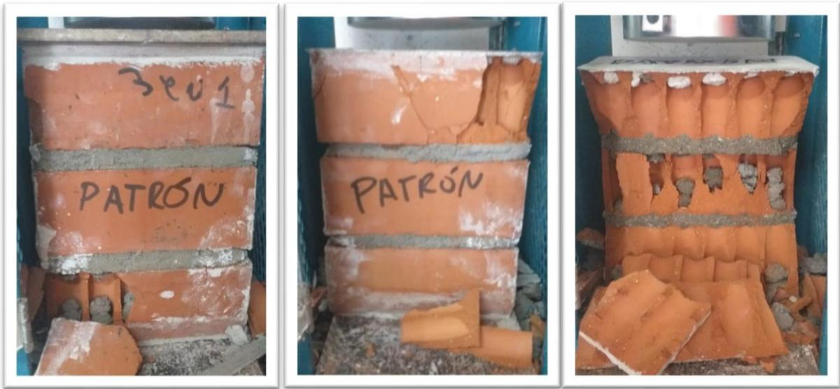
Figura 55. Resistencia a la compresión axial de la pila patrón a la edad de 28 días.
