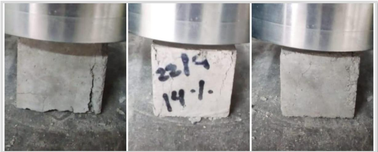
*Figura 41.* Rotura del mortero experimental con 14% de ceniza de maíz a la edad de 14 días.
