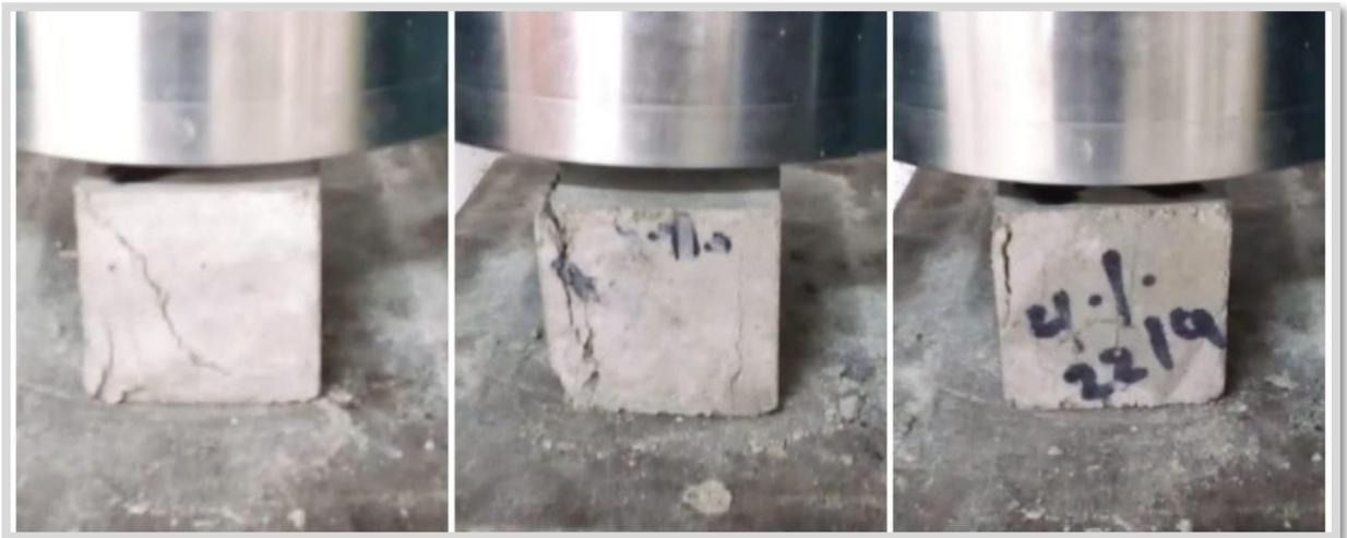
*Figura 39.* Rotura del mortero experimental con 4% de ceniza de maíz a la edad de 14 días.
