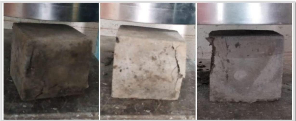
*Figura 32.* Rotura del mortero experimental con 14% de ceniza de maíz a la edad de 7 días.
