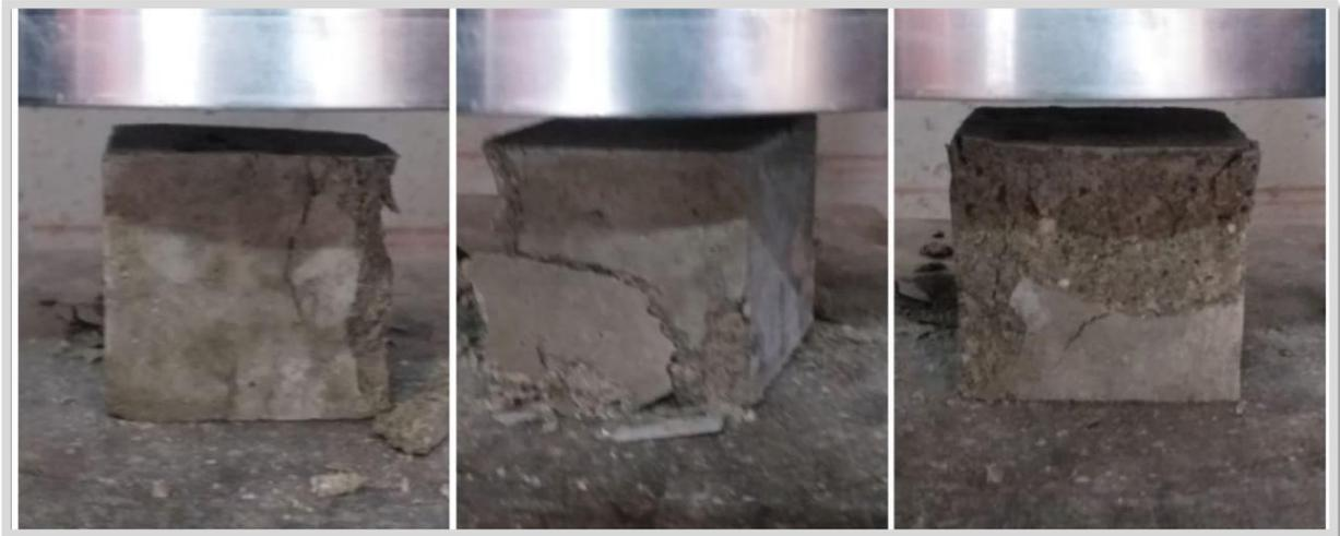
*Figura 30.* Rotura del mortero experimental con 4% de ceniza de maíz a la edad de 7 días.
