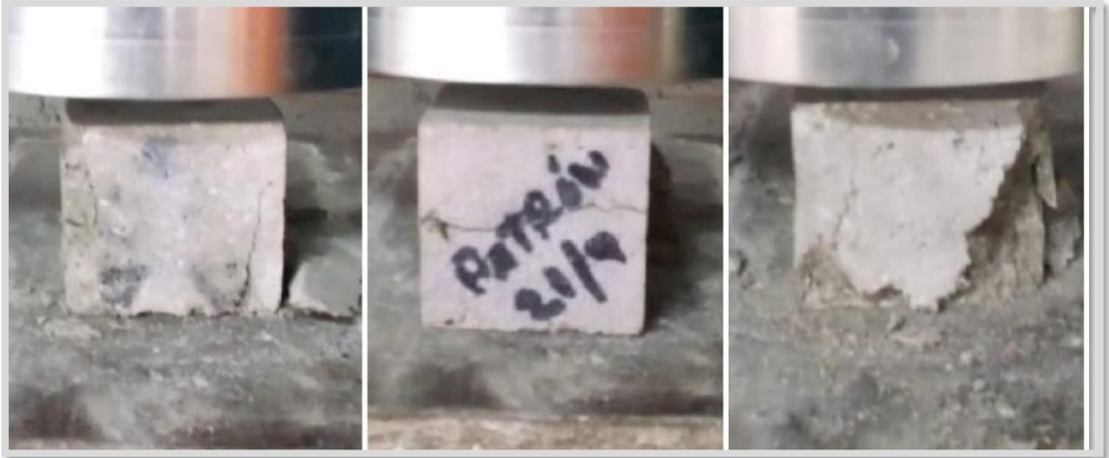
*Figura 38.* Rotura del mortero patrón a la edad de 14 días.
