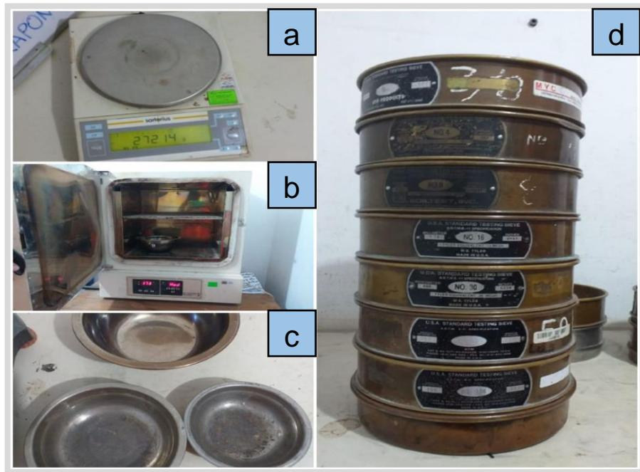
Figura 8. Instrumentos y equipos para el Análisis Granulométrico.
