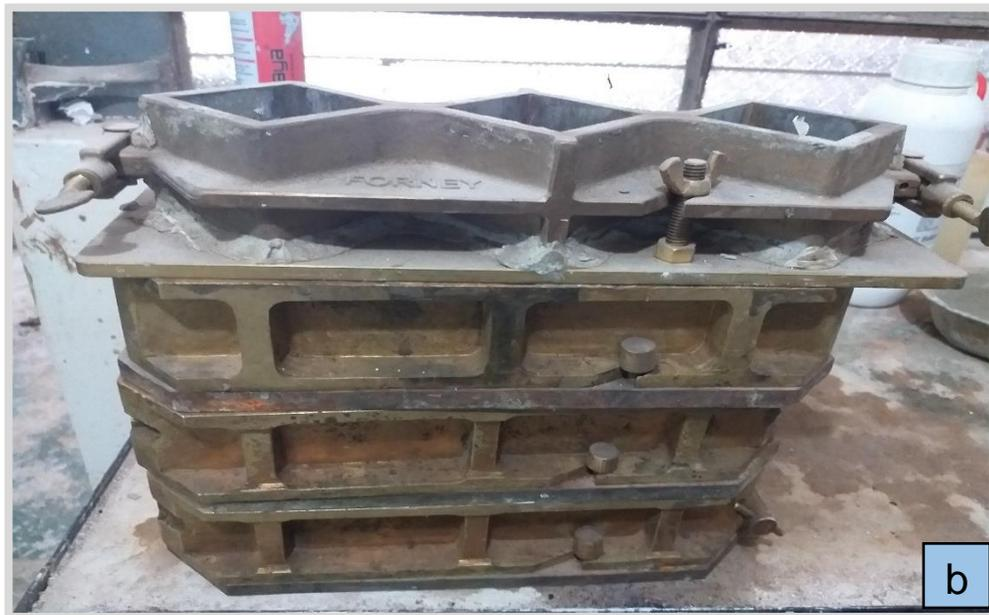
*Figura 13. Moldes de cubos de mortero.*
