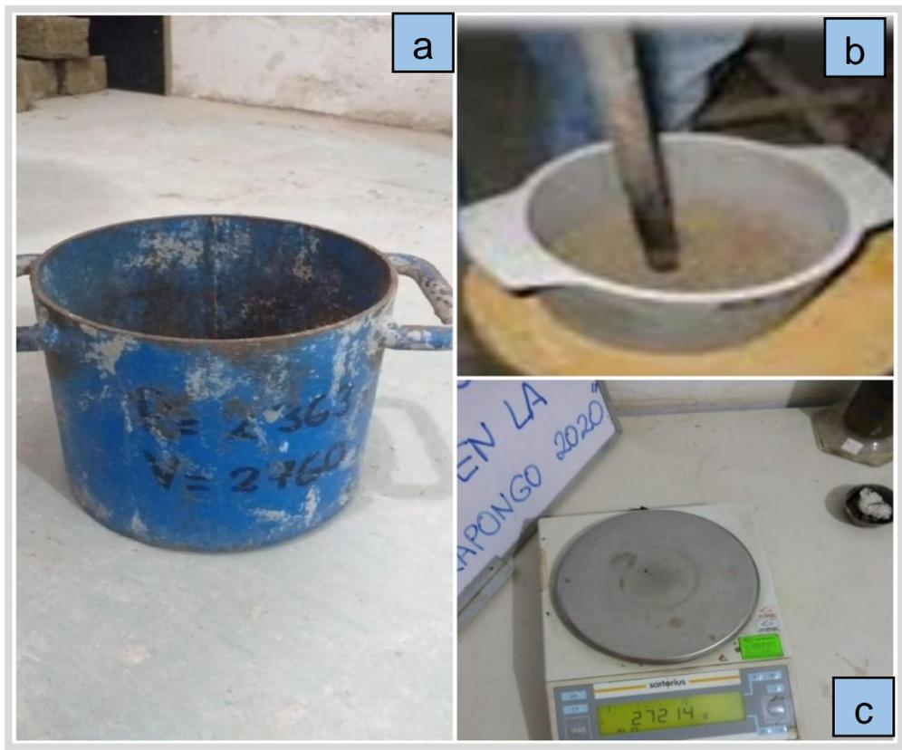
Figura 9. Instrumentos y equipos para el Peso Unitario Suelto y Compactado.
