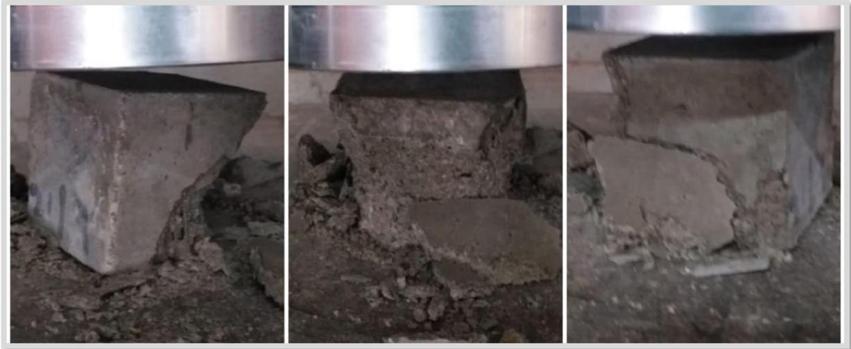
*Figura 29.* Rotura del mortero patrón a la edad de 7 días.
