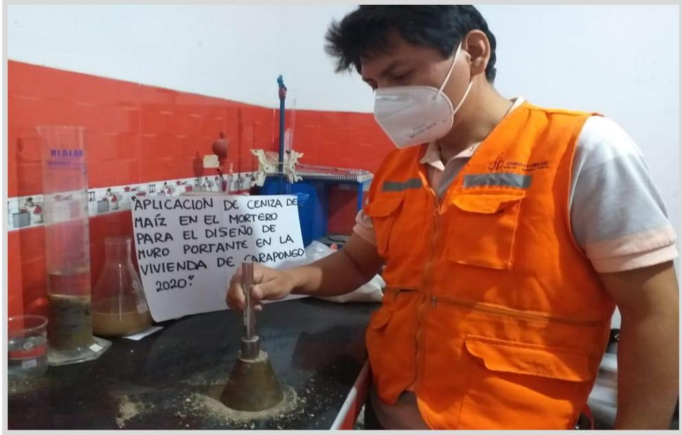
Figura 67. Compactado de la arena gruesa para determinar el peso de absorción.
