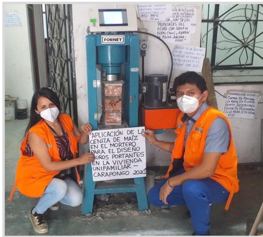
Figura 78. Ensayo de pilas a compresión axial a la edad de 28 días.
