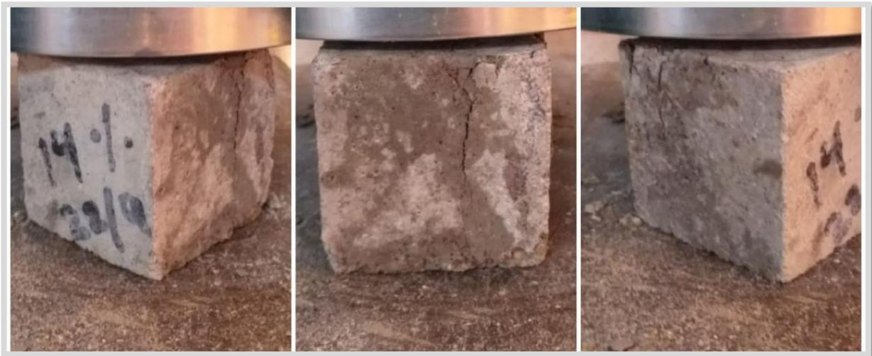
*Figura 50.* Rotura del mortero experimental con 14% de ceniza de maíz a la edad de 28 días.
