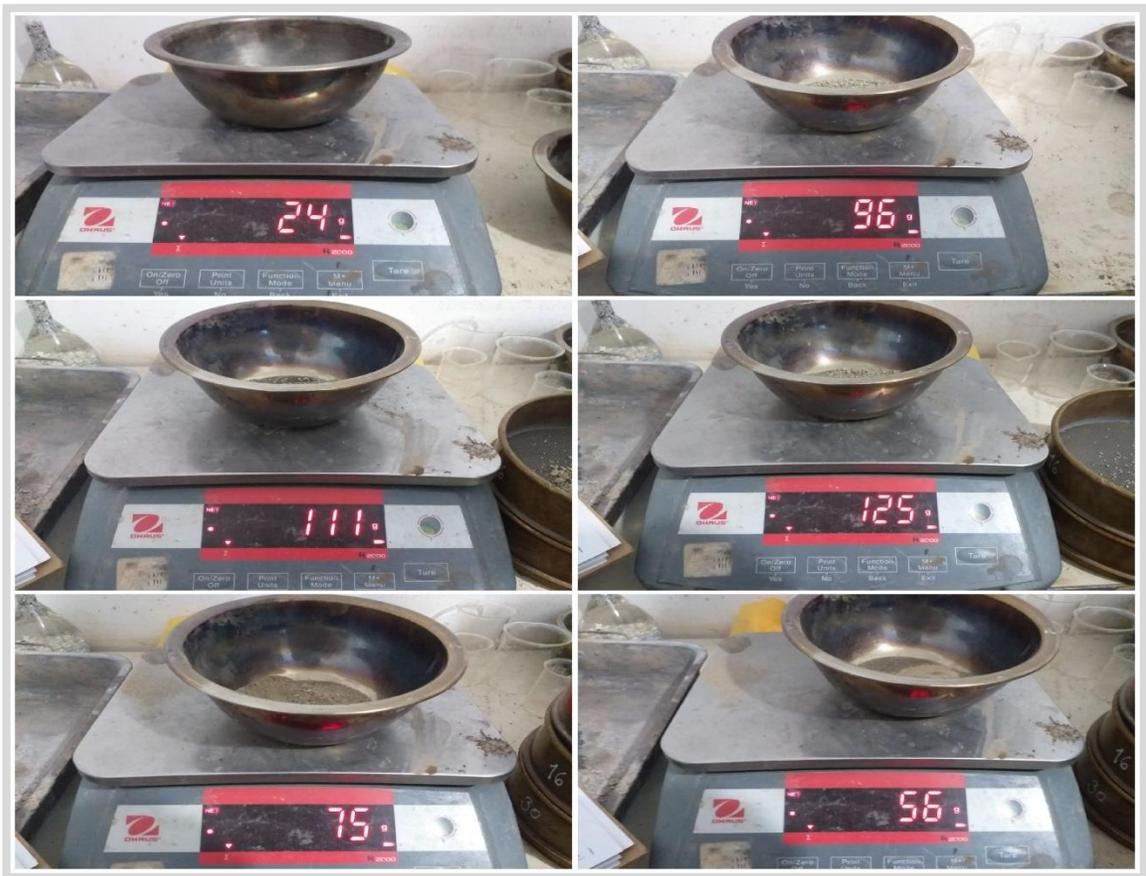
Figura 60. Peso retenido de cada malla de la muestra de la arena gruesa.
