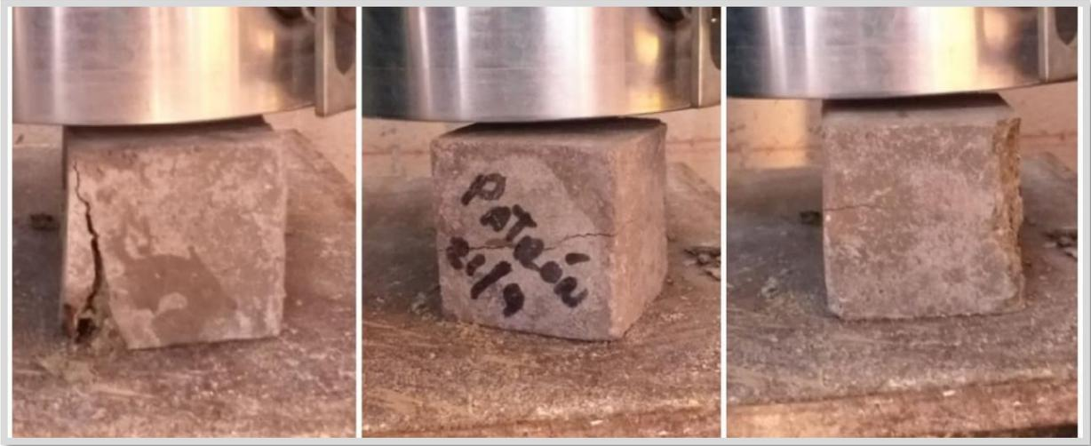
*Figura 47.* Rotura del mortero patrón a la edad de 28 días.
