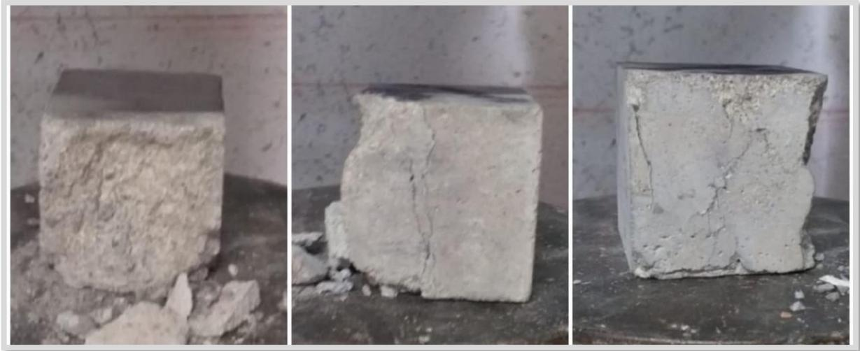
*Figura 31.* Rotura del mortero experimental con 9% de ceniza de maíz a la edad de 7 días.
