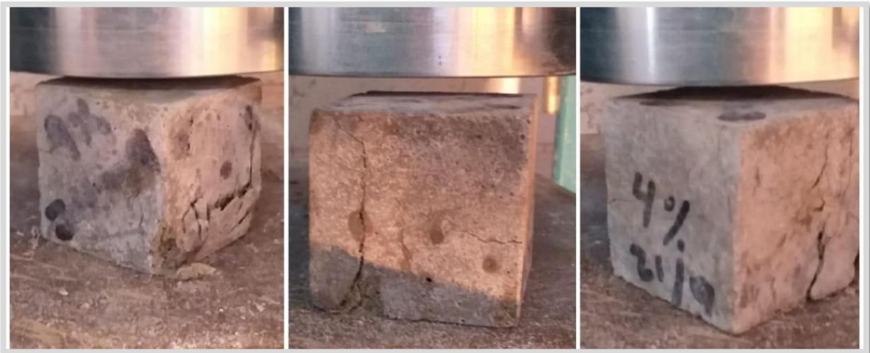
*Figura 48.* Rotura del mortero experimental con 4% de ceniza de maíz a la edad de 28 días.
