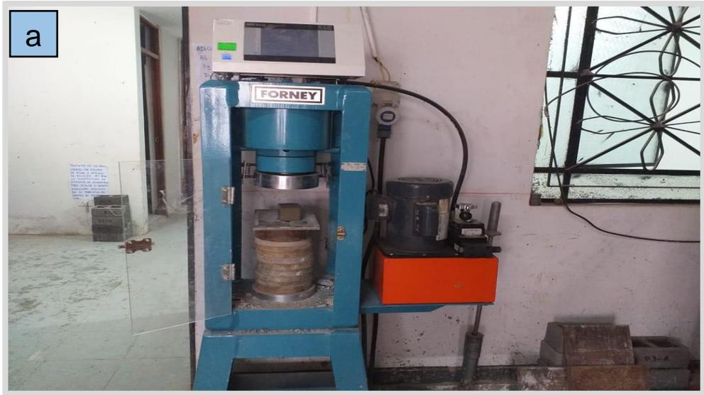
*Figura 12. Máquina de ensayo de compresión.*
