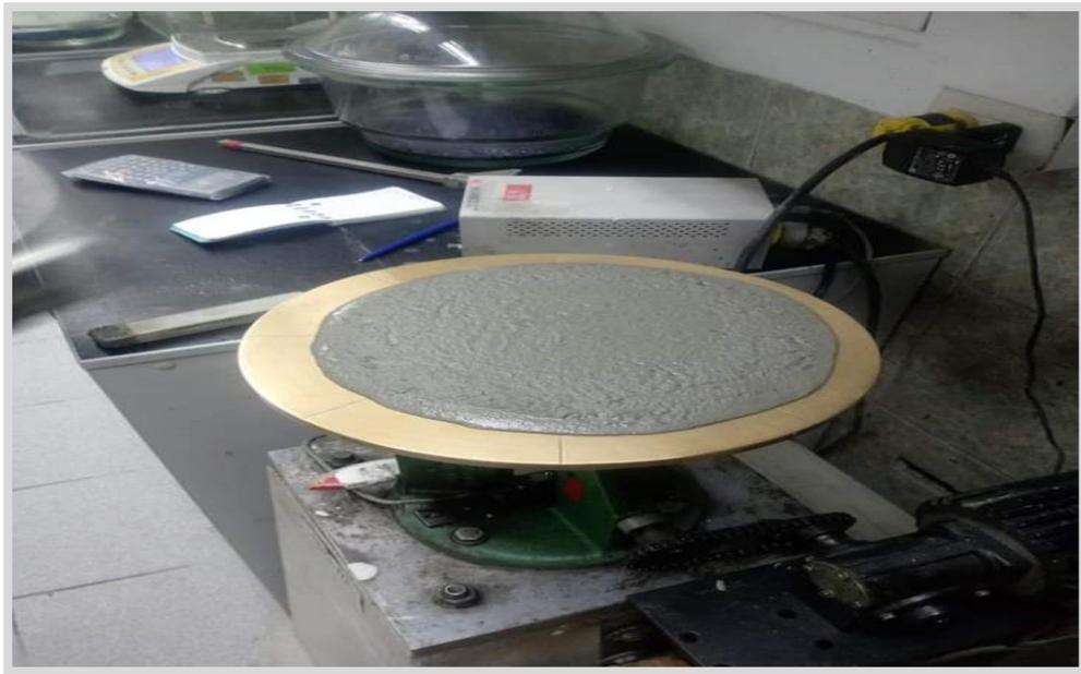
*Figura 71.* Determinación de las dimensiones de la muestra.
