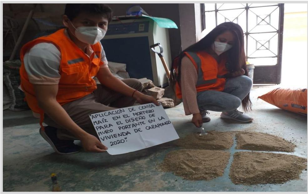
*Figura 61. Cuarteo del agregado fino.*
