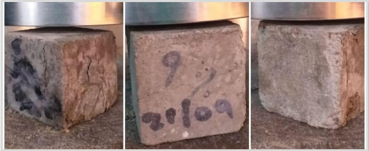
*Figura 49.* Rotura del mortero experimental con 9% de ceniza de maíz a la edad de 28 días.
