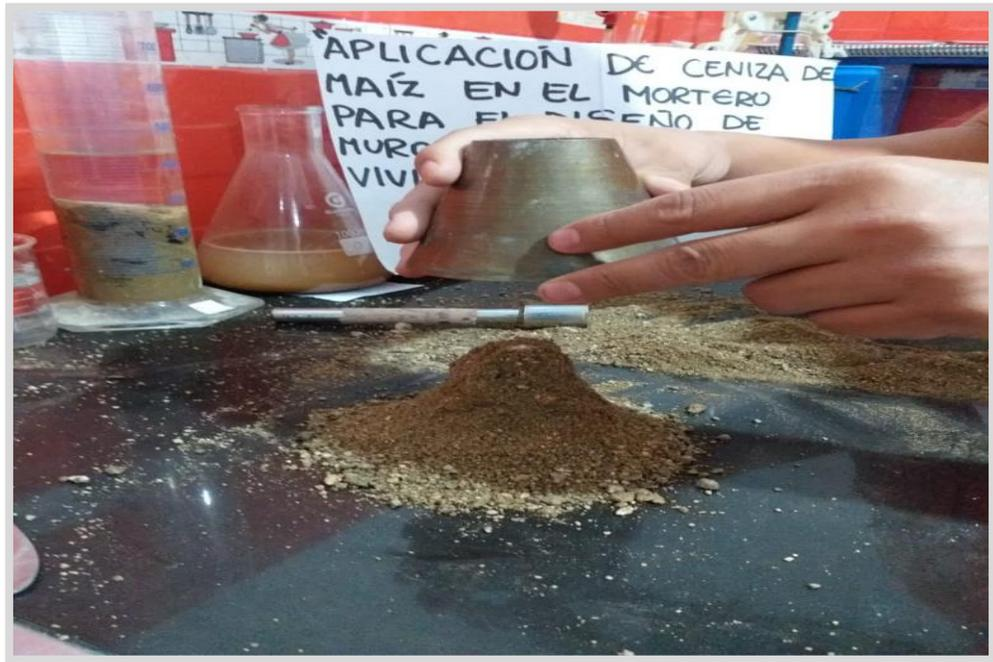
Figura 68. Determinación del peso específico de la arena gruesa
