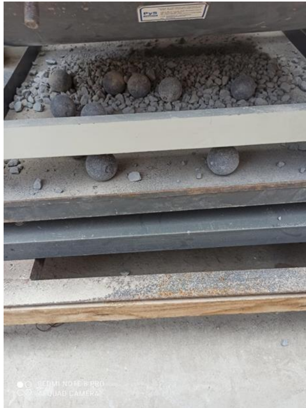
Figura 8. Agregado grueso en la prueba de abrasión Fuente: Elaboración propia
