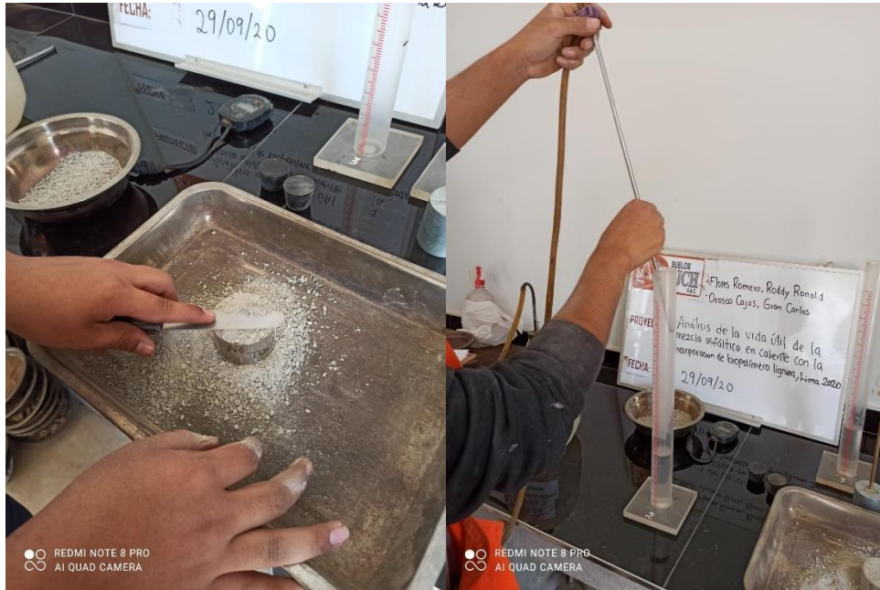
Figura 10. Procedimiento de la prueba Equivalente de arena Fuente: Elaboración propia
