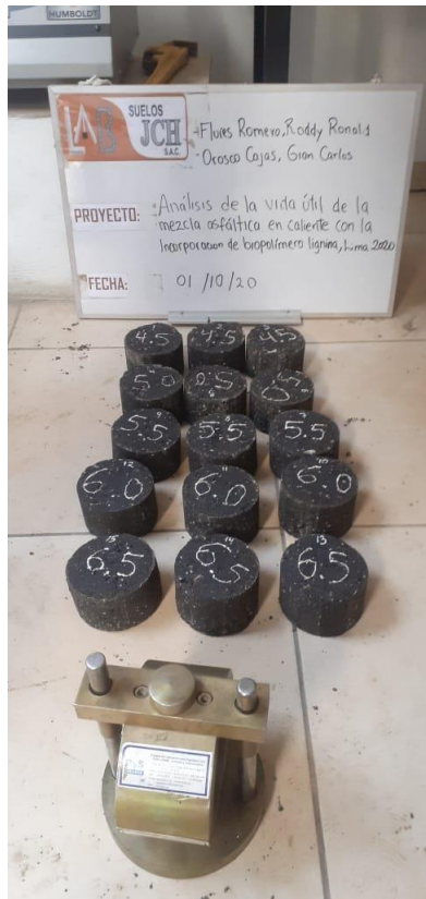
Figura 14. Briquetas de la mezcla asfáltica convencional sin Lignina
