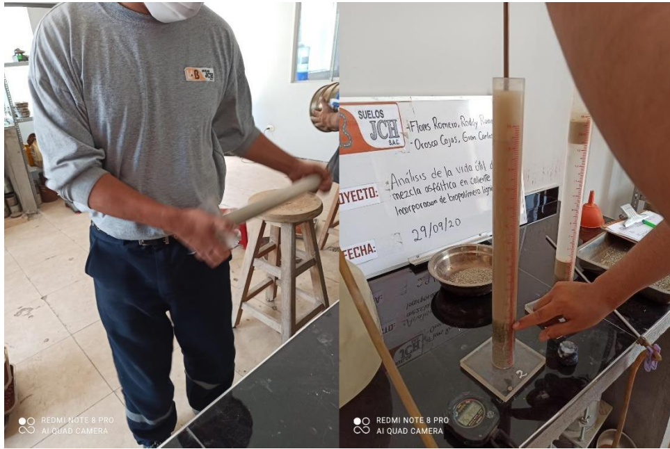
Figura 12. Procedimiento de la prueba Equivalente de arena Fuente: Elaboración propia
