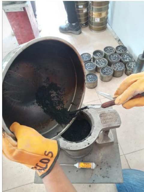
Figura 17. Mezcla asfáltica en el molde
