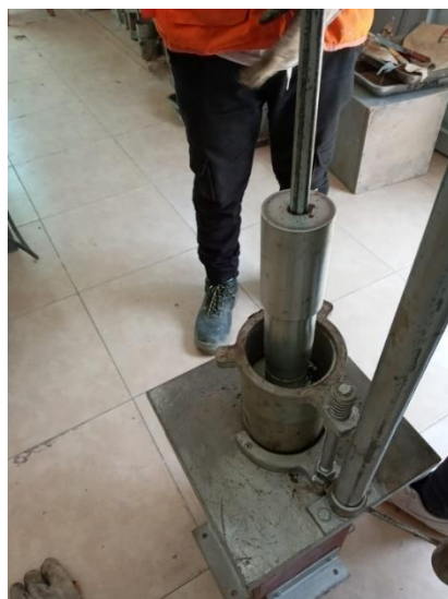
Figura 18. Compactación de la mezcla asfáltica en el molde
