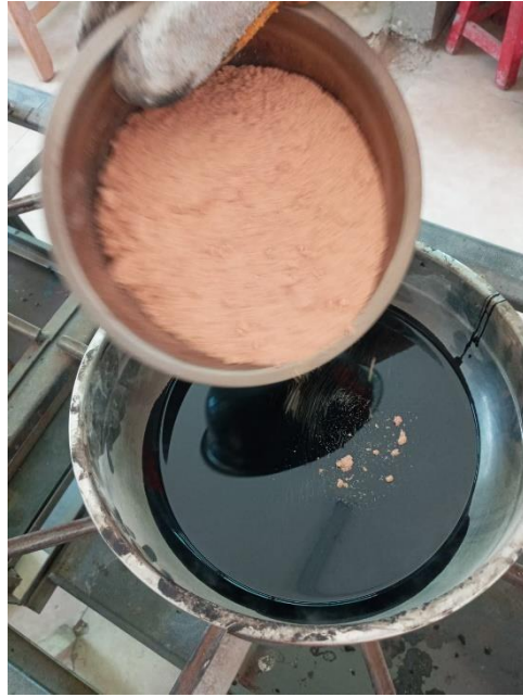
Figura 30. Lignina y cemento asfáltico previo a la combinación de ambos Fuente: Elaboración propia
