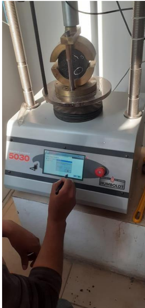
Figura 6. Ensayo Marshall Fuente: Elaboración propia
