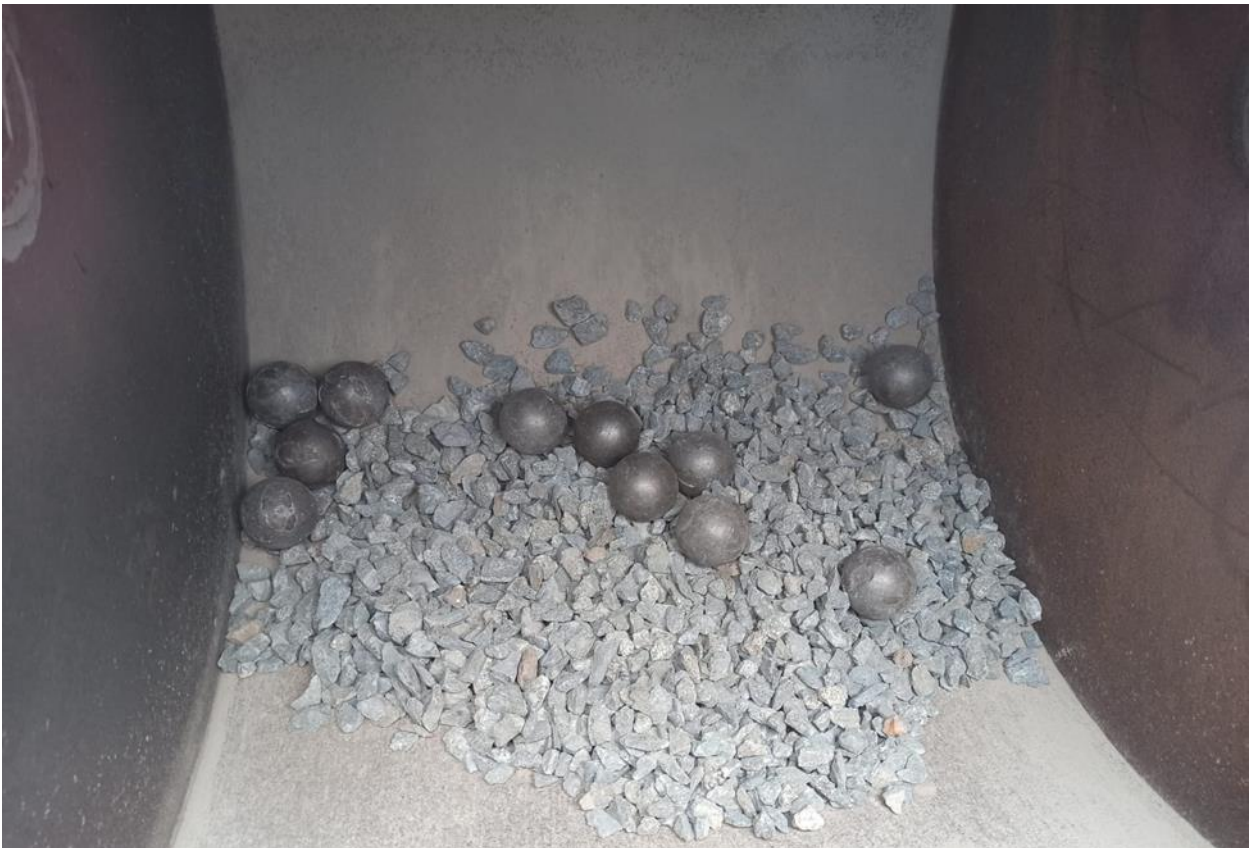
Figura 7. Agregado grueso en la prueba de abrasión Fuente: Elaboración propia
