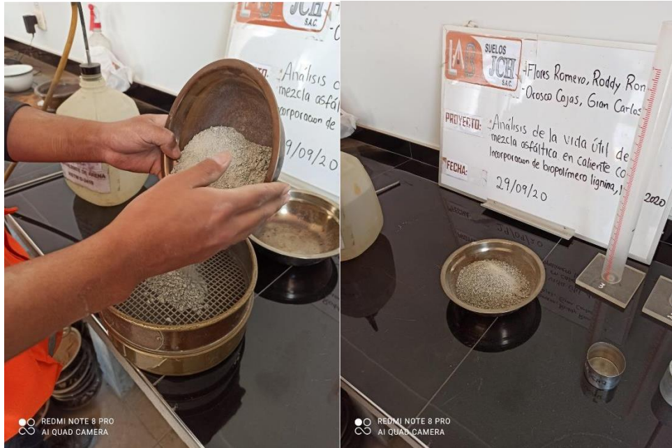
Figura 9. Seleccionando el agregado fino con los tamices
