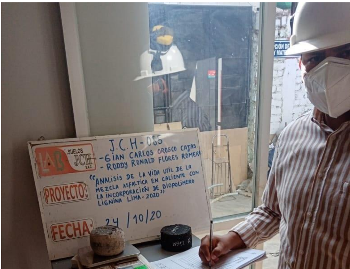
Figura 45. Briqueta después del ensayo de Cántabro
