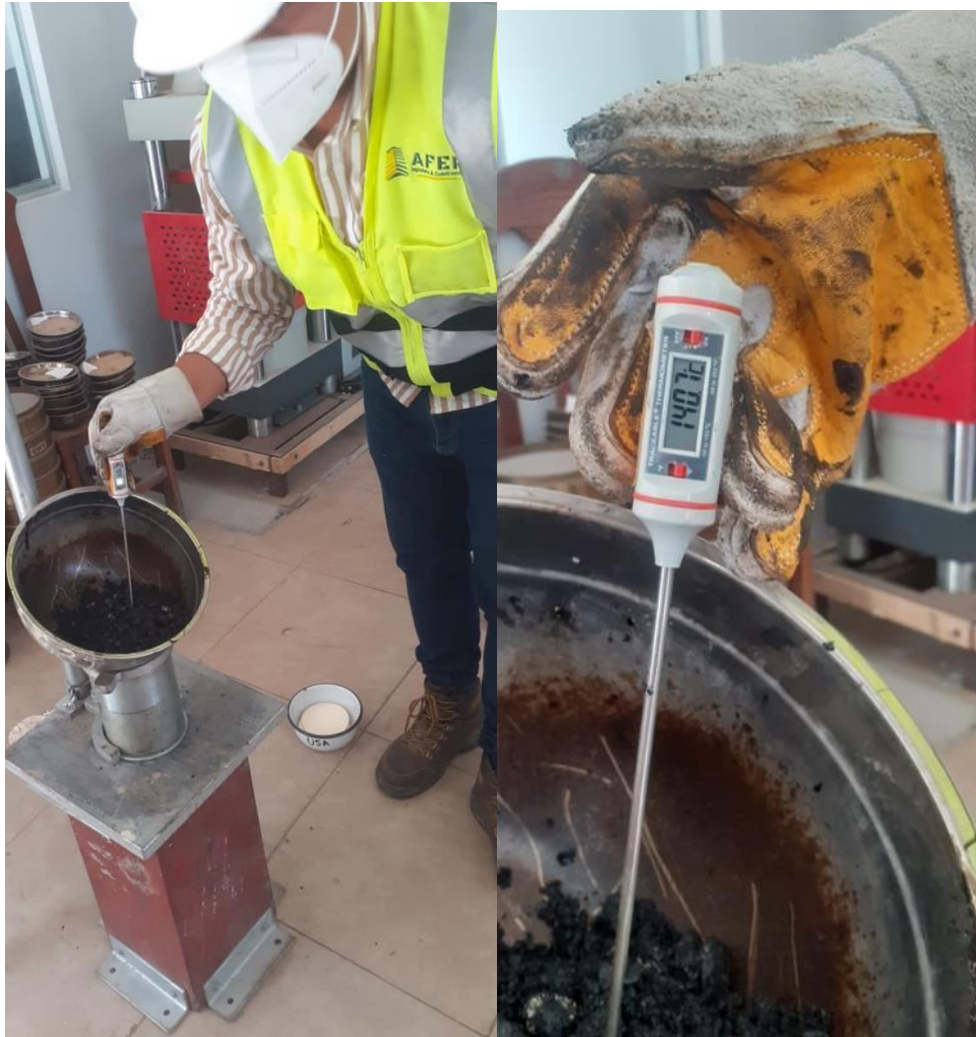
Figura 4. Temperatura de la mezcla asfáltica Fuente: Elaboración propia
