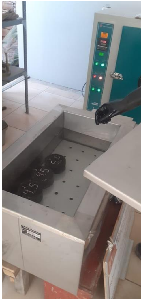
Figura 5. Baño María de las briquetas a 60°C
