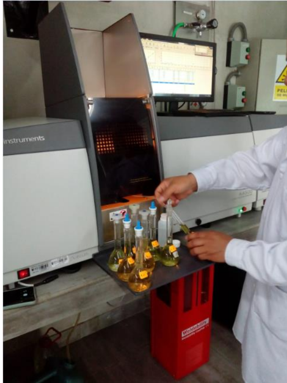
Figura 34: Medición de la concentración de plomo (Adsorción atómica)
