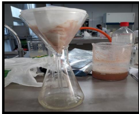
Figura N° 9: Lavado de la biomasa con abundante agua destilada
