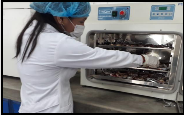
Figura 5. Los caparazones secados en una estufa a 90 °C por 4 horas
