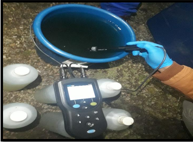
Figura 15. Medición de las características químicas del agua.
