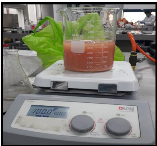
Figura 10. El sólido obtenido disuelto con hidróxido de sodio sometido en agitación constante.
