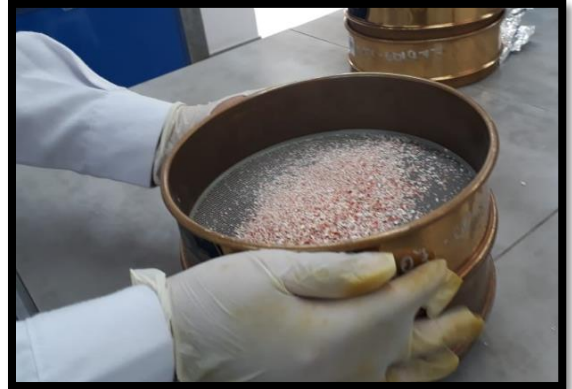
Figura 6. Tamizado hasta un tamaño de partícula de 500 µm.
