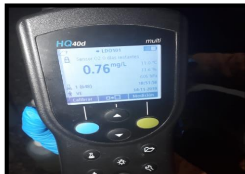
Figura 17. Medición del OD del agua.
