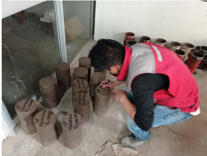
Proceso de Curado de las muestras de concreto.
