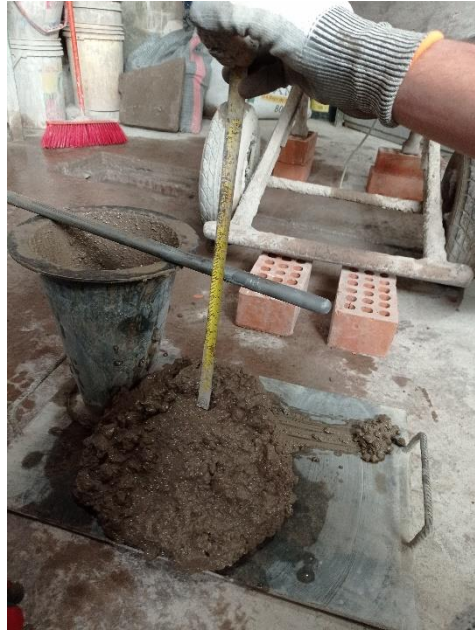
Proceso de ensayo del Cono de Abrams para medir el asentamiento de las mezclas.
