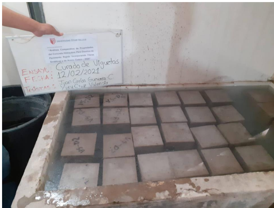
Proceso de Curado de las muestras de concreto.
