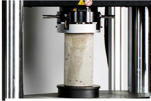
Figura 21: Ensayo a la Compresión Fuente: https://www.360enconcreto.com/blog/que-hacer-cuando/ensayo-compresion-ensayo-flexion-del-concreto
