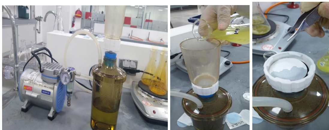
Figura 17: filtrado de las muestra en el equipo de la bomba al vacío
