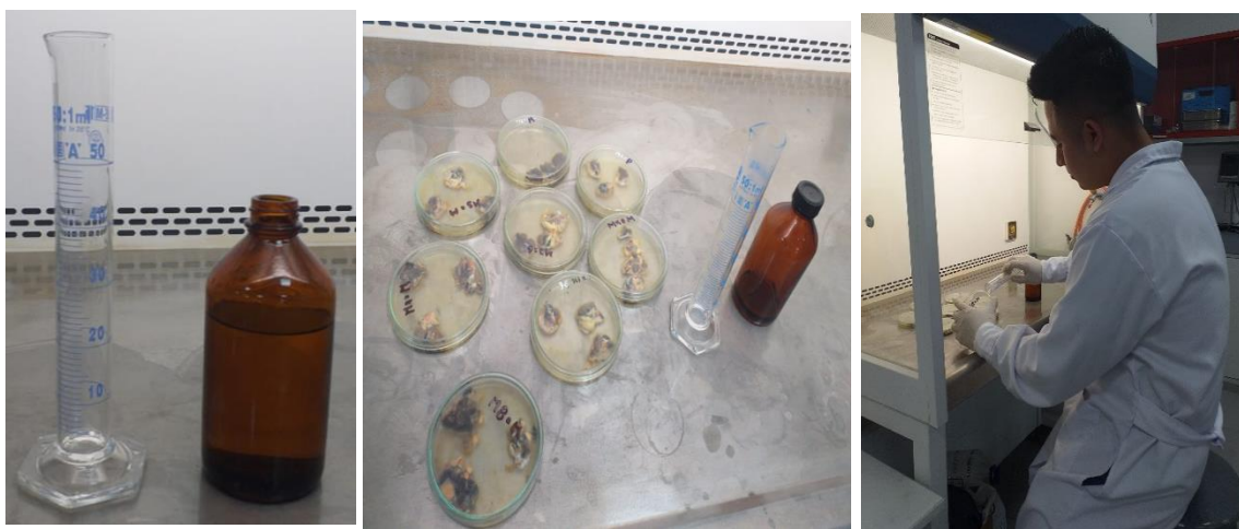
Figura 13: Aplicación de ácido nítrico para deterioro de tejido blando del mejillón
