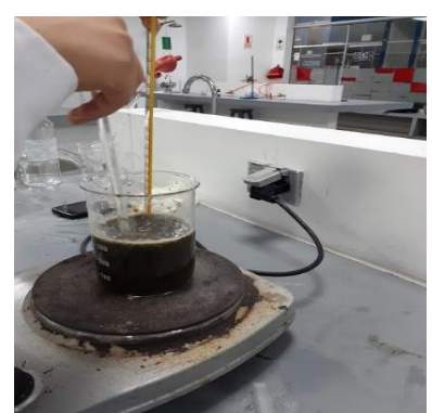
Figura 23. Extracción alcalina a temperatura de 80°C, con agitación constante
