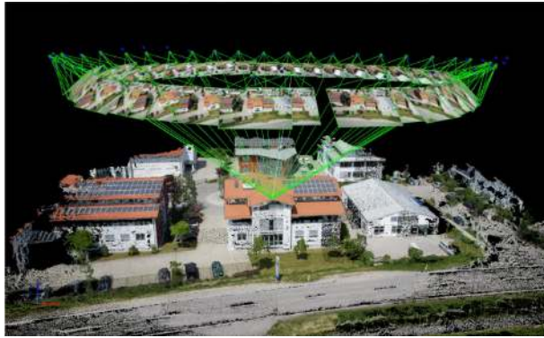
Figura 9. Planificación de Vuelo con RPAS Fuente: Manual RPAS Basado a la Ingeniería
