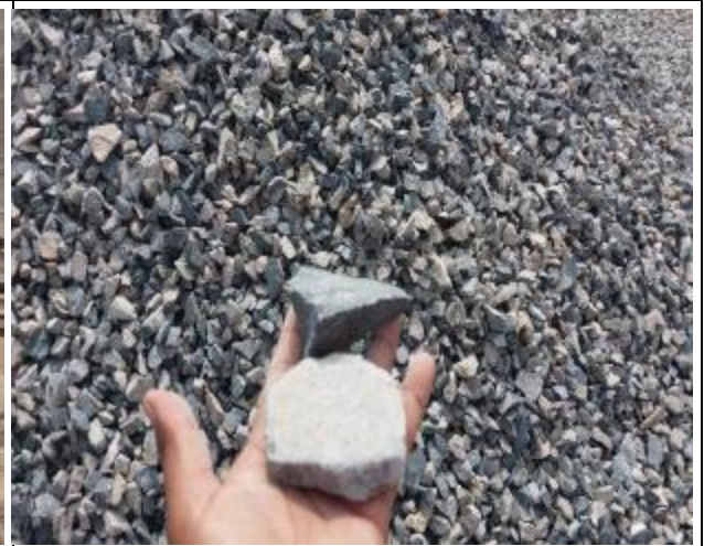
Producto Huso 67 con granulometría no adecuada, zaranda rota en los extremos.
