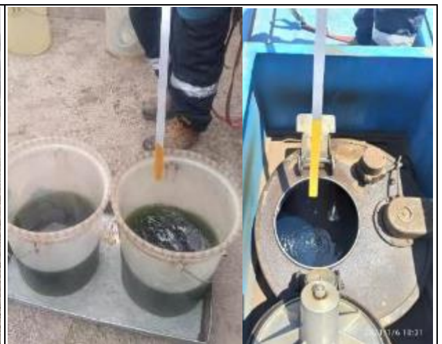
Se realiza verificación del combustible empleando el producto Kolor Kut.
