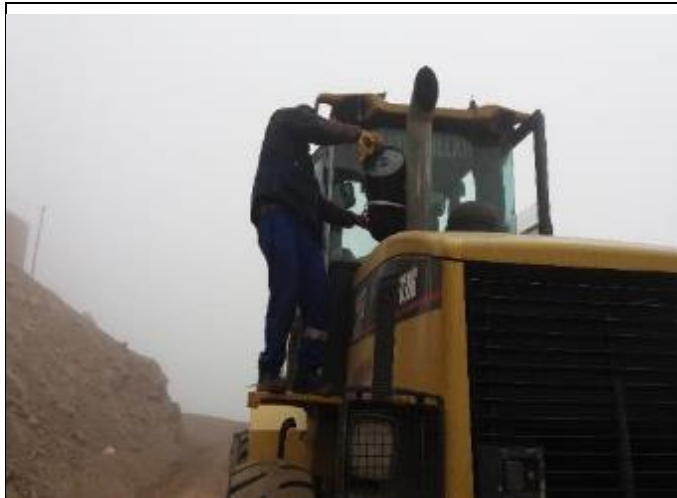
Línea amarilla es abastecida de combustible por medio de baldes.
