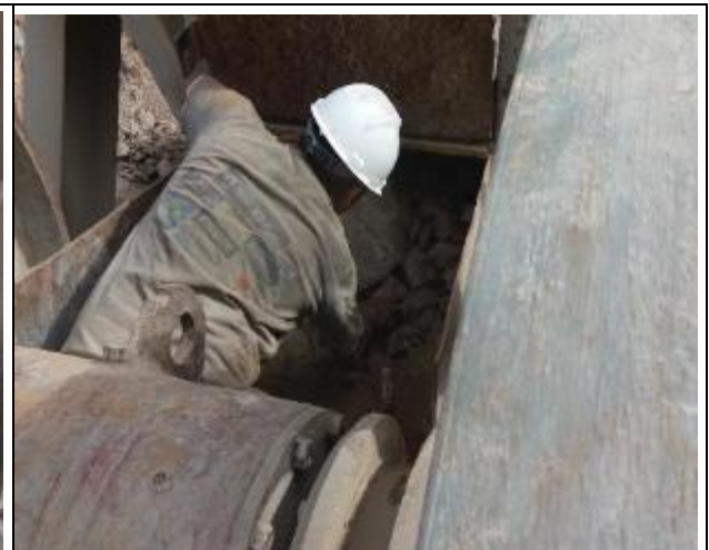
Trabajador ingresando para el retiro manual de las piedras.
