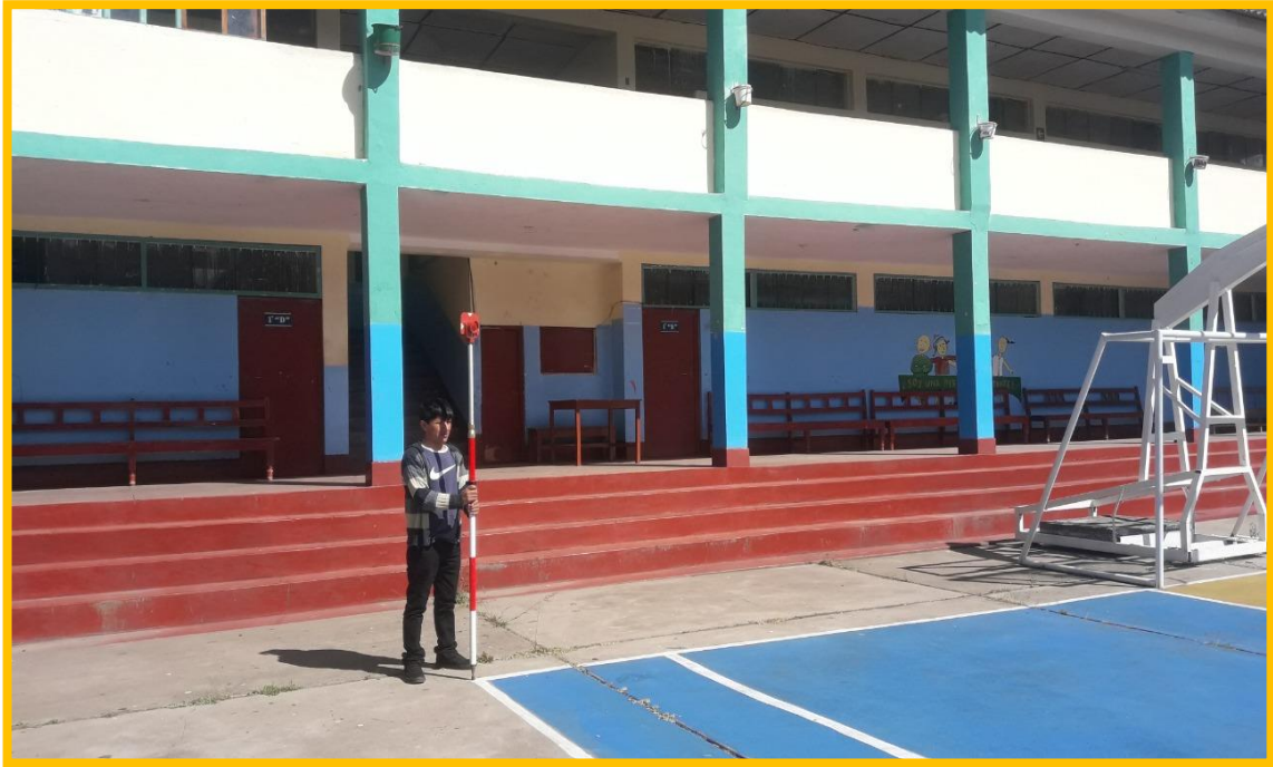
Fotografía 7. Vista de la toma de puntos topográficos con el prisma.
