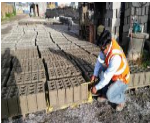
Bloquetas de concreto con adición de aserrín de madera
