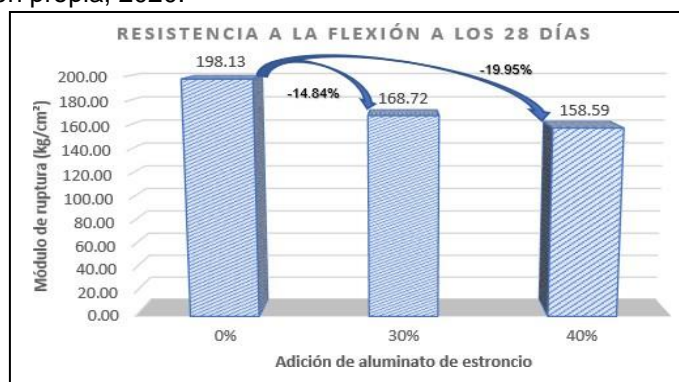
Figura 34: Resumen de resistencia a flexión de las vigas de mortero a 28 días.
