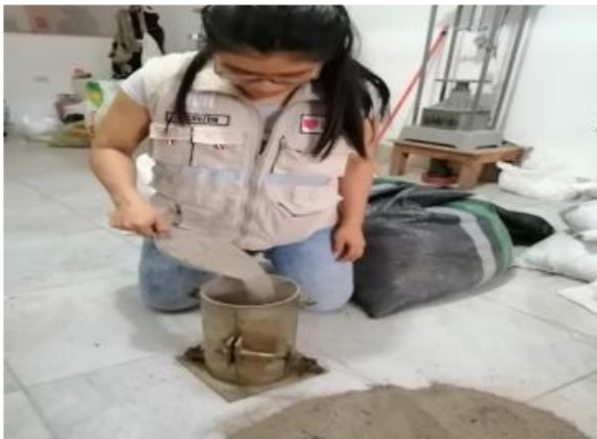
Colocación del agregado fino
