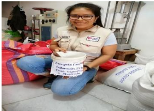
Saturación 24 h – Peso específico y Absorción del agregado fino.
