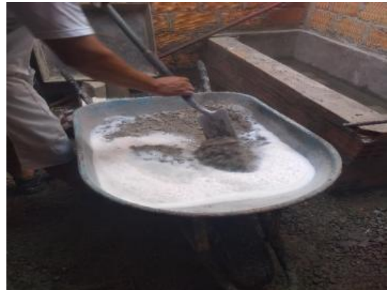
Diseño de mezcla de concreto con todos sus componentes más la adición del nanosílice
