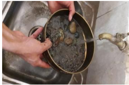
Lavado del hormigón.
