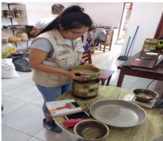
Tamizado del hormigón
