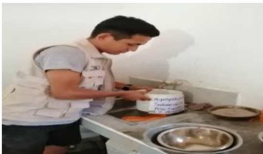
Saturación 24 h – Peso específico y Absorción del agregado grueso.
