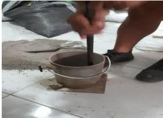
Varillado del agregado fino en tres capaz de 25 golpes.
