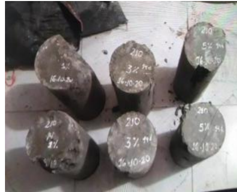
Rupturas de las probetas a distintos porcentajes.
