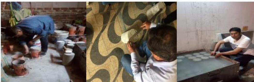
*Figura 14.* Desmoldar y curar las probetas.
