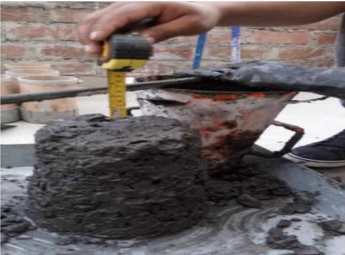
*Figura 40.* Asentamiento de la mezcla.
