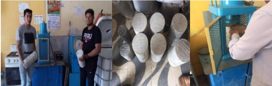
*Figura 15.* Ensayo de la resistencia a la compresión.
