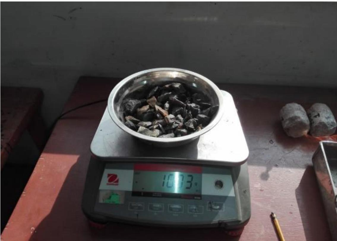
Figura 24. Peso específico del agregado grueso.
