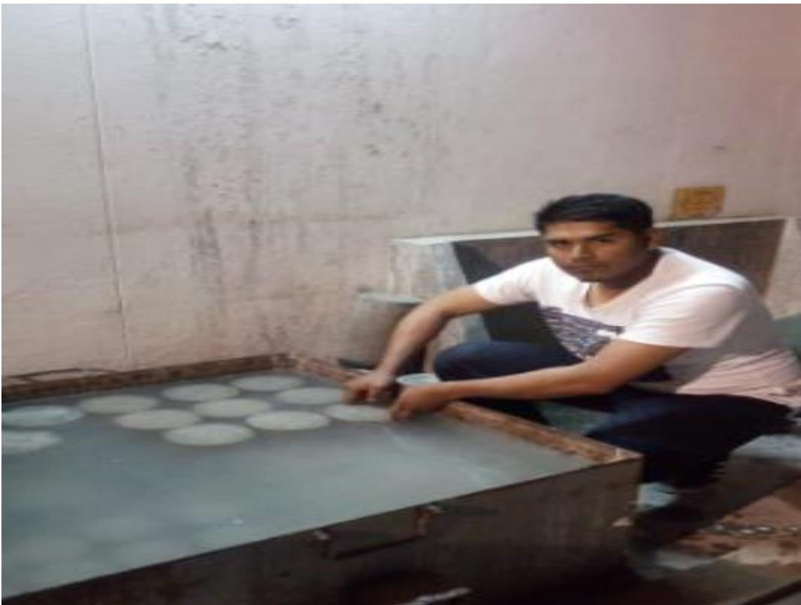
*Figura 45.* Curado de probetas de concreto.
