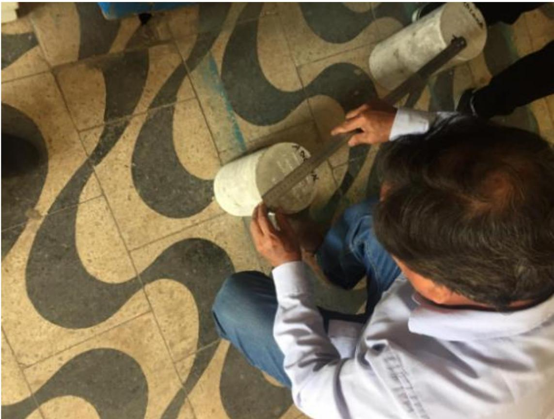
Figura 49. Recolección de datos de la muestra de concreto.
