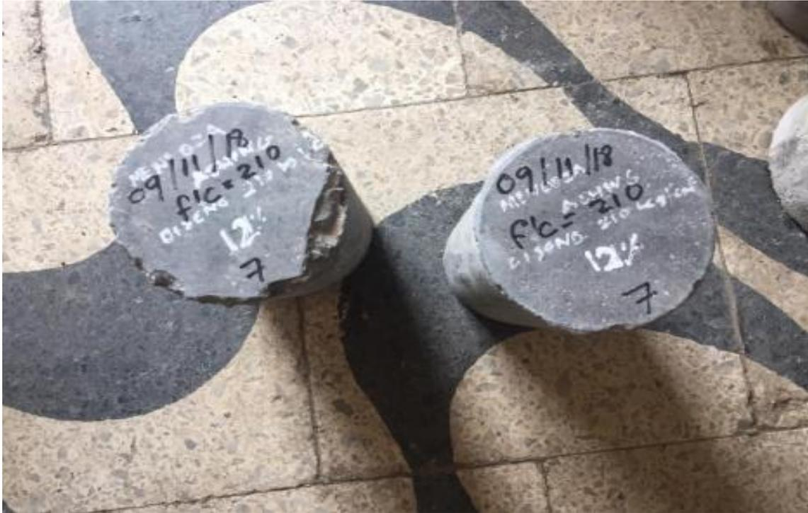
Figura 48. Probeta con porcentaje de ceniza.
