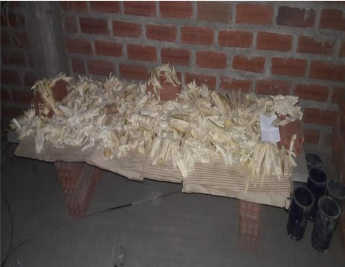
*Figura 28.* Secado de bagazo de caña de azúcar.
