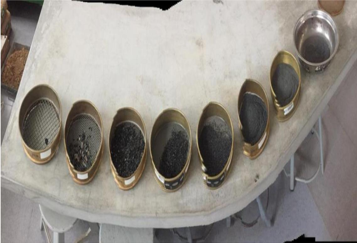
Figura 33. Granulometría de la ceniza de bagazo de caña de azúcar.
