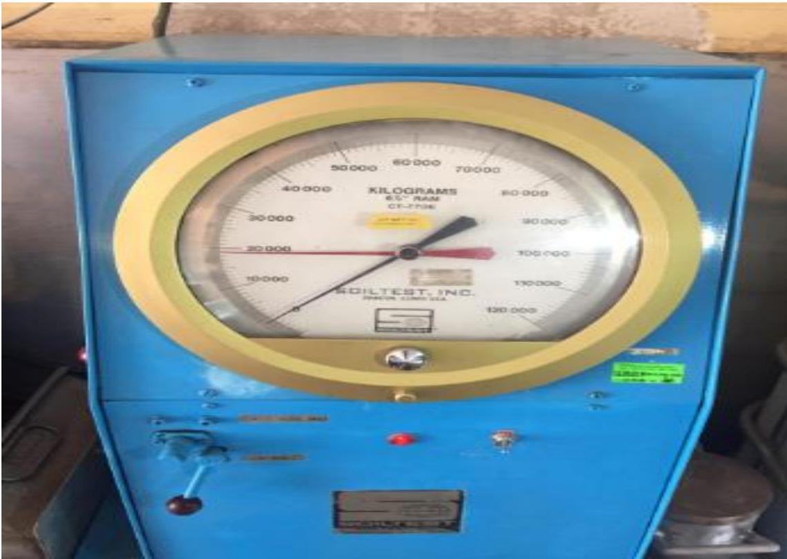
*Figura 52.* Ensayo a la resistencia a la compresión.
