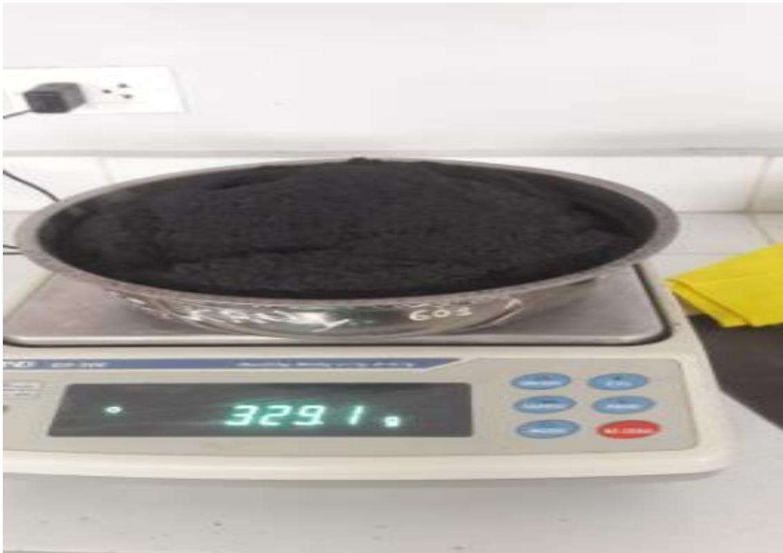
Figura 34. Peso específico de la ceniza de bagazo de caña de azúcar.
