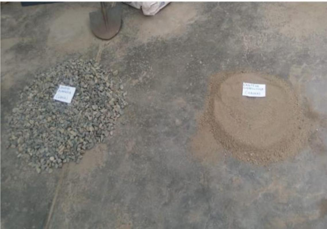
Figura 22. Agregado grueso y agregado fino.
