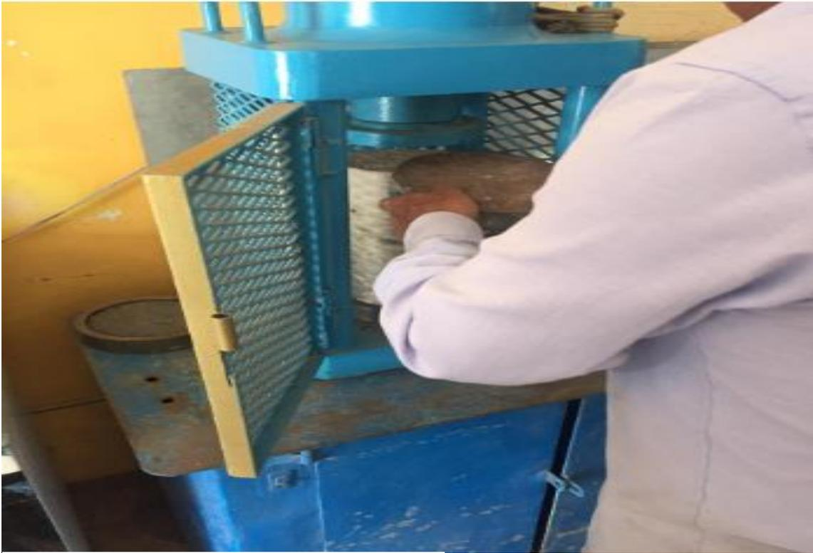
*Figura 50.* Ensayo a la resistencia a la compresión.
