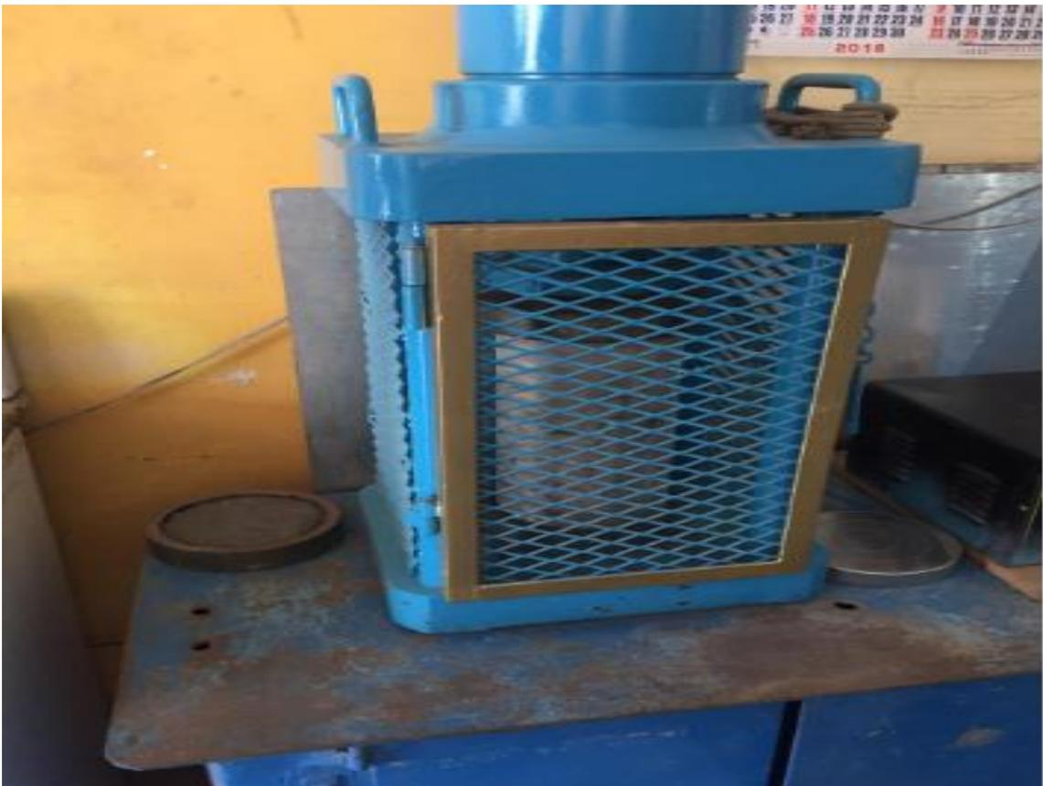
*Figura 51.* Ensayo a la resistencia a la compresión.
