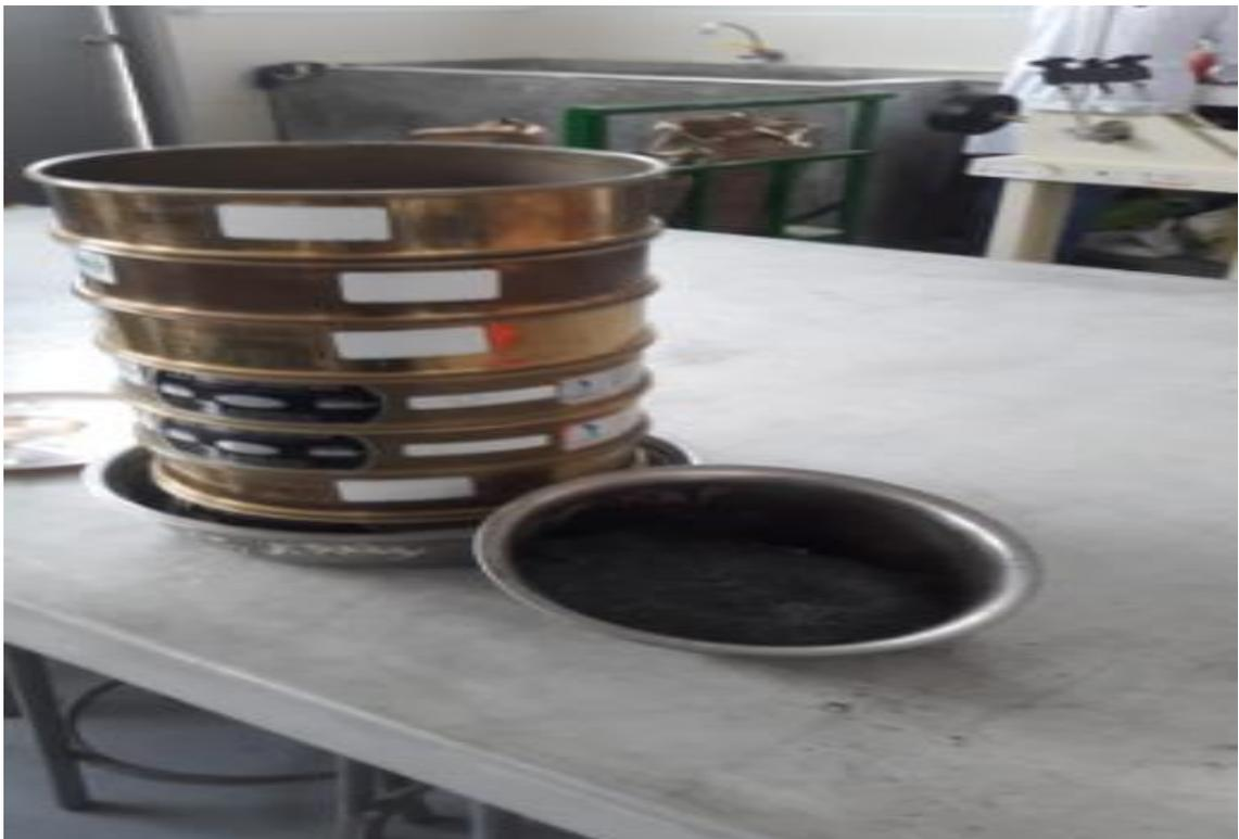
*Figura 32.* Tamizado de la ceniza de bagazo de caña de azúcar.
