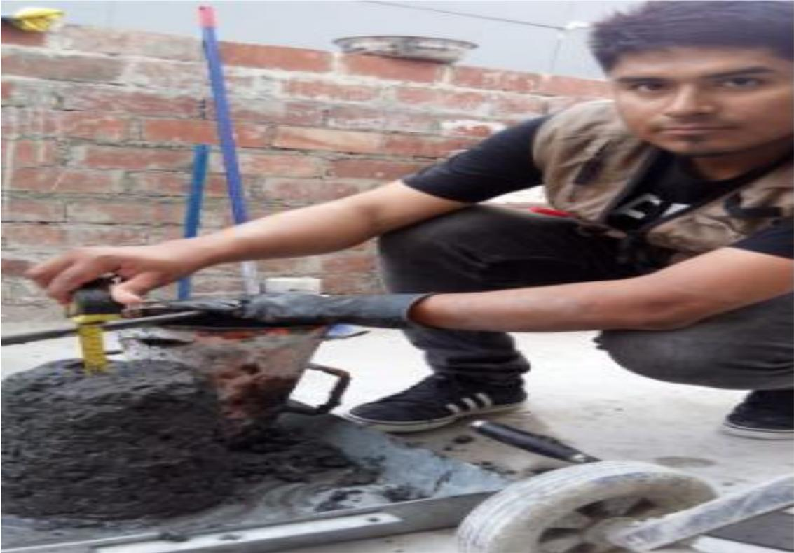
*Figura 39.* Determinación de la prueba de consistencia (slump).
