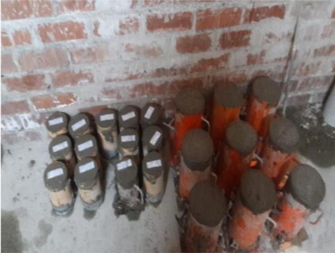
*Figura 42.* Vaciado de probetas patrón y con ceniza.
