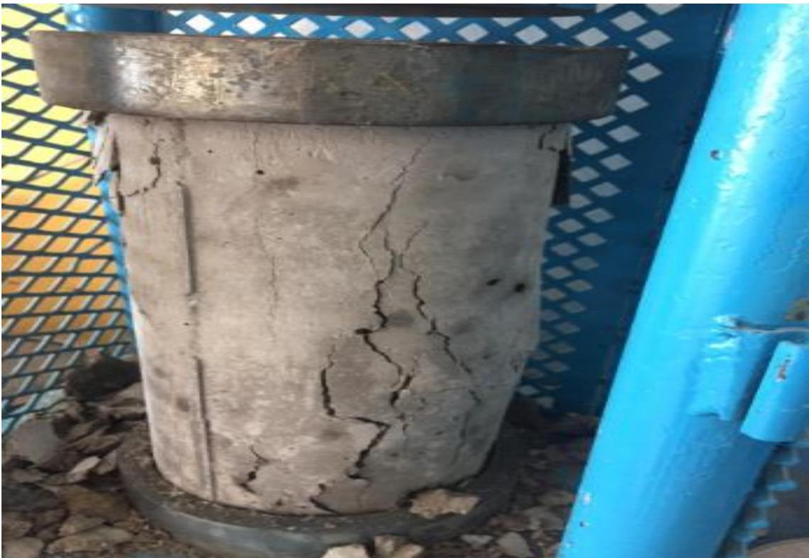
*Figura 53.* Resultado de ensayo a la resistencia a la compresión
