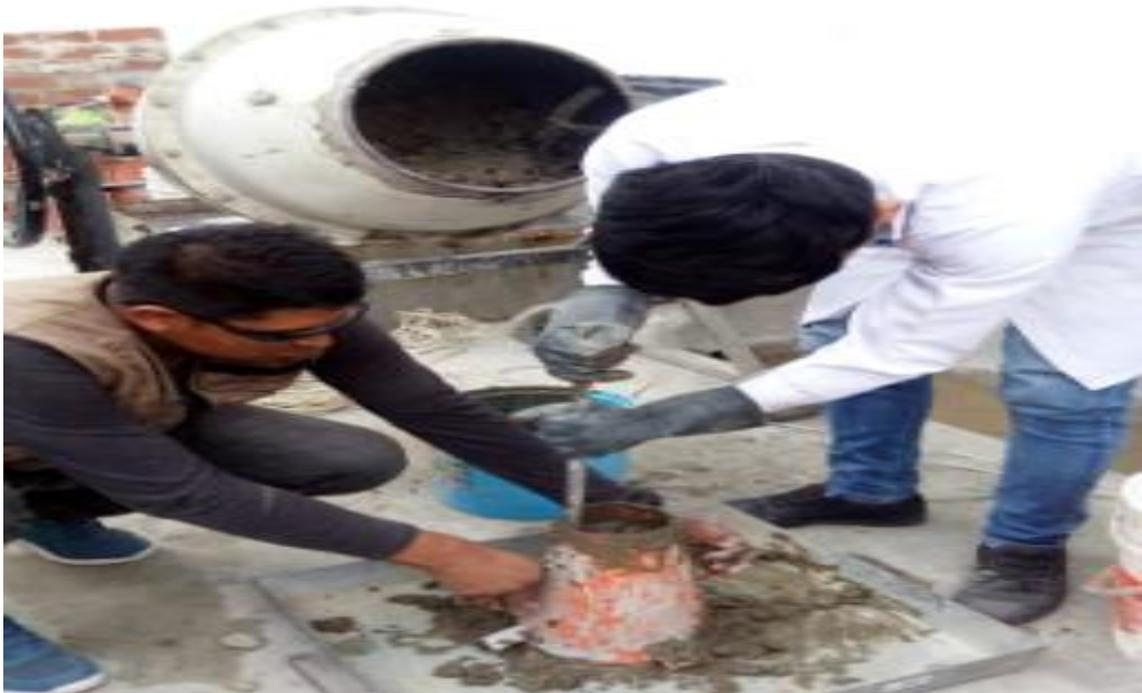
*Figura 38.* Vaciado en cono de Abrams.
