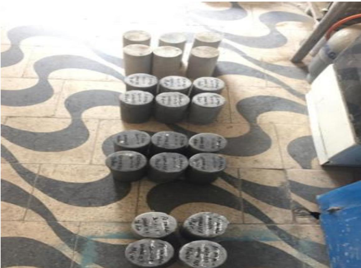
Figura 47. Muestras patrón y con ceniza para la rotura de probeta.
