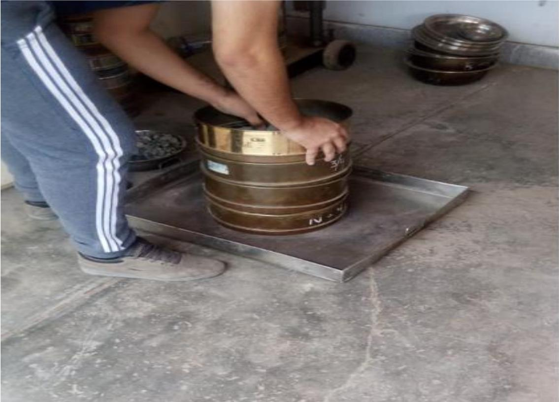
Figura 23. Tamizado del agregado grueso.
