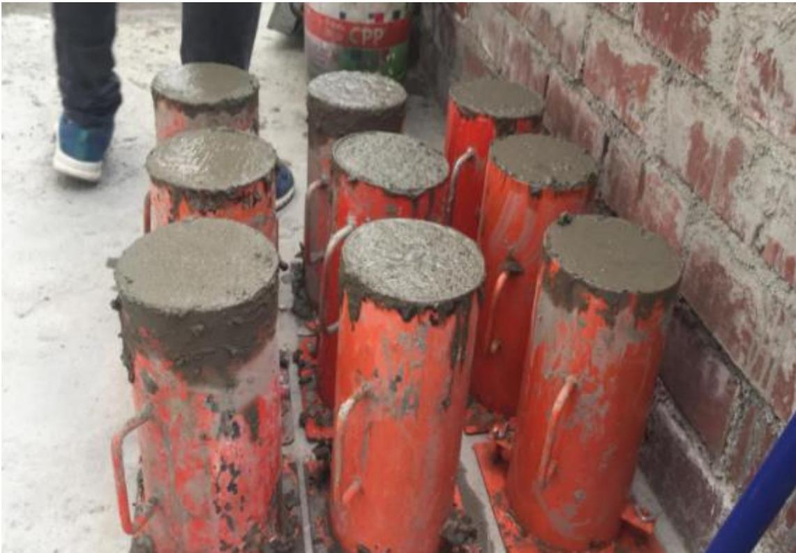
*Figura 41.* Vaciado de probetas patrón.
