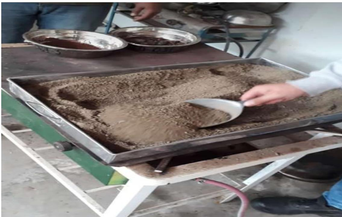
Figura 25. Peso específico del agregado fino.
