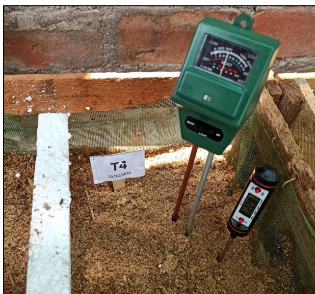
Figura 14: Medición de humedad
