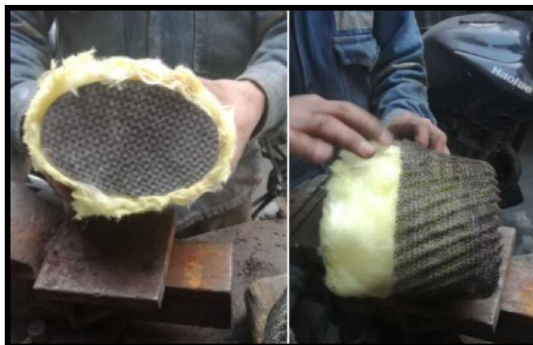
Figura 11: Cubrimiento del monolito cerámico con fibra y malla
