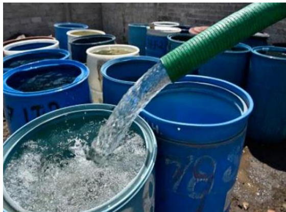
Figura 3. Agua cumple los requisitos de la Norma E.060 para fabricar mortero.
