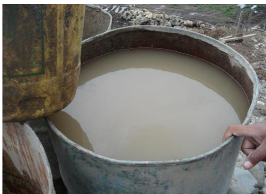
Figura 1. Agua que no cumple los requisitos de la Norma E.060 para fabricar mortero.
