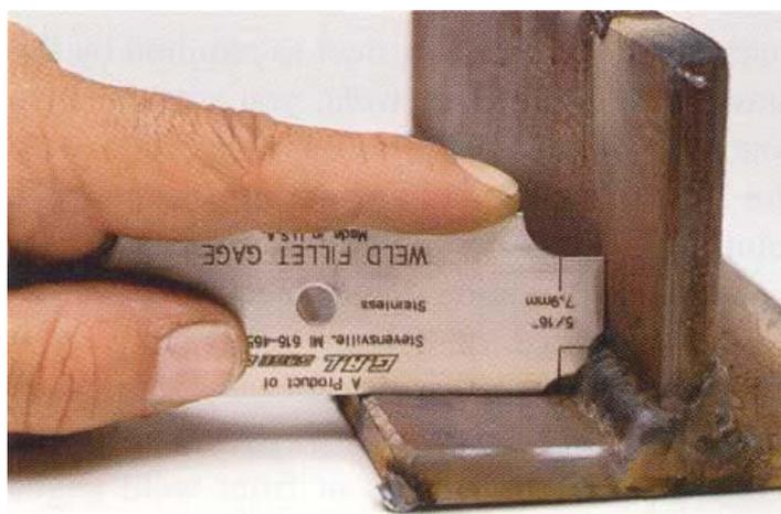
**Fig. 02** Uso de Galga tipo patrón para soldadura de filete en la Inspección Visual.
