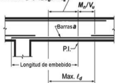
(c) \ell_d máximo para barras "a" en el punto de inflexión
